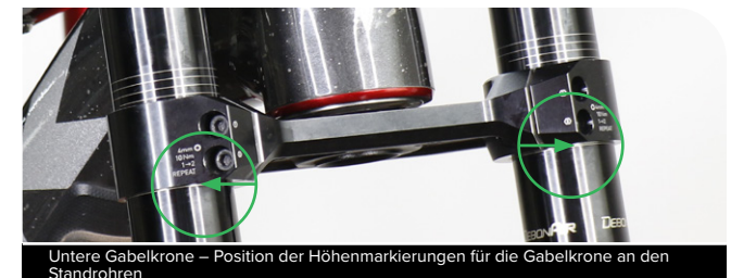
Richtig – Innerhalb der Höhenmarkierungen für die untere Gabelkrone
