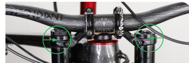
Posición de la marca de altura de corona superior/corona tubo superior
