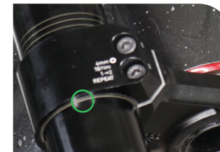
Correcto: dentro de la marca inferior de la corona
