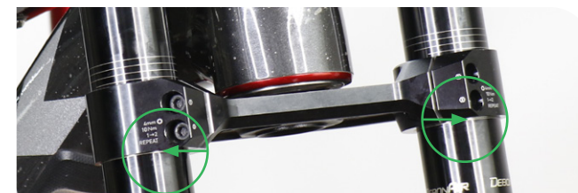
Posición de la marca de altura de corona inferior/corona tubo superior
