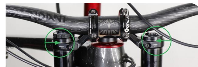
Té supérieur - Position des repères pour la hauteur du té sur les plongeurs
