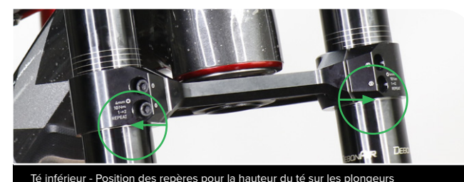
Té inférieur - Position des repères pour la hauteur du té sur les plongeurs
