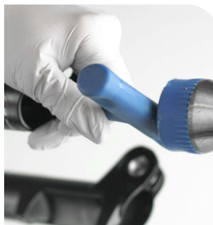
Gabelbein in Hohlbauweise: Hammer und 5 mm
