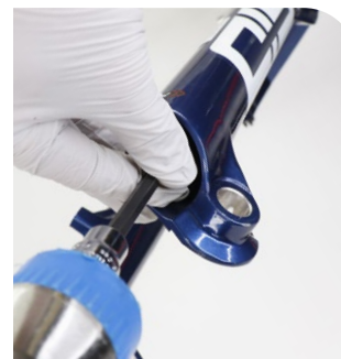
Ultimate/Select +: Lado del amortiguador - 5 mm
