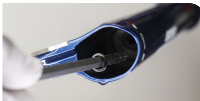
Ultimate/Select +: Lado del amortiguador - 5 mm
