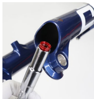
Ultimate/Select +: Lado del amortiguador: 10 mm
