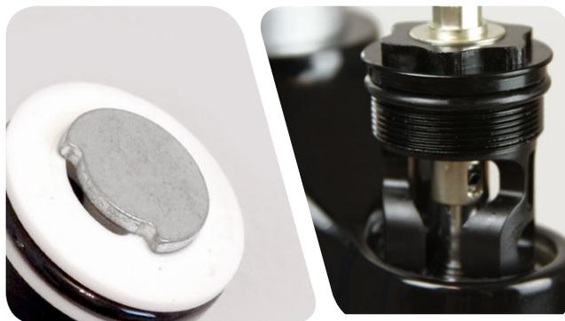
**Commande à distance RLT et RL** : à l'aide d'une clé plate de 8 mm, faites tourner la came du capuchon supérieur de compression dans le sens des aiguilles d'une montre jusqu'à sa position ouverte tout en insérant l'amortisseur de compression dans le tube supérieur. Enfoncez-le puis secouez en tous sens jusqu'à ce que l'amortisseur soit bien en place.
