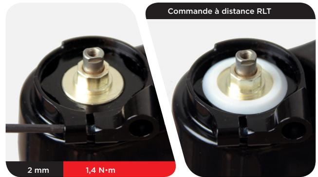
**4** **RCT3 :** installez la molette de réglage de la compression sur le capuchon supérieur de l'amortisseur de compression. Utilisez une clé plate de 10 mm pour serrer le boulon de la rondelle.
