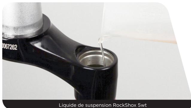
*Les hauteurs d'huile sont mesurées depuis le haut de la surface du té au-dessus du tube supérieur jusqu'à la surface de l'huile.*
