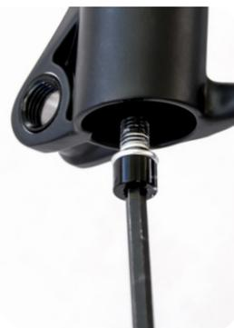
**Dual Position Air** : insérez une douille profonde de 10 mm sur l'écrou de la came du côté opposé à la chaîne. À l'aide d'un maillet en plastique, tapez fort sur la douille pour libérer le boulon du fourreau inférieur. Retirez l'écrou. Répétez les étapes 4 et 5 pour le côté de la chaîne.
