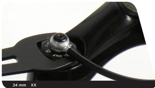
**Commande à distance RLT et RL** : appuyez sur le bouton de la commande à distance PushLoc™ pour la mettre en position comprimée (ouverte).
