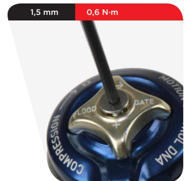
**RL** : installez la molette de réglage de la compression sur le capuchon supérieur de l'amortisseur de compression.
