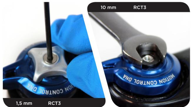
**RLT** : à l'aide d'une clé hexagonale de 1,5 mm, retirez la vis de serrage de la molette de verrouillage. Avec les doigts, retirez le joint PTFE. Retirez la molette de verrouillage, la molette de réglage de la compression et le joint torique de la came.
