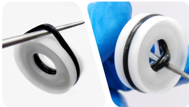
**6** Avec les doigts, retirez la bague de coulissage du piston Dig Valve™.
