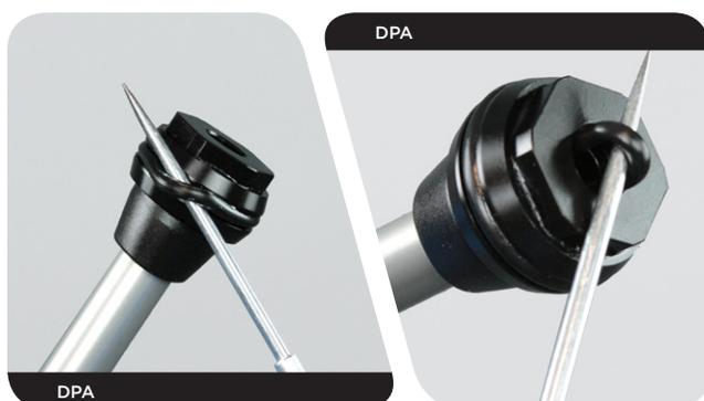
**13** Avec les doigts ou une pointe, retirez le cône de talonnage du piston pneumatique.
