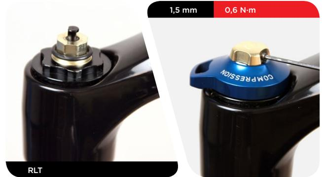
**RL:** Montieren Sie den Druckstufeneinstellring so auf der Abdeckkappe des Druckstufendämpfers, dass die Nase des Einstellrings am Anschlag anliegt.
