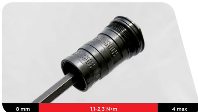
**5** Verwenden Sie einen Dorn, um den O-Ring des Luftventils zu entfernen und zu ersetzen.
