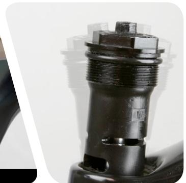
**3** Entfernen Sie mit einem Dorn oder mit den Fingern den O-Ring der Druckstufen-Abdeckkappe. Montieren Sie einen neuen O-Ring für die Druckstufen-Abdeckkappe.
