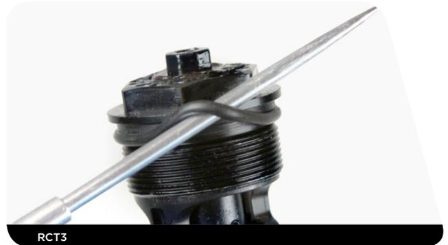
**4** Entfernen Sie mit den Fingern oder einem Dorn den O-Ring des Druckstufendämpferkolbens. Geben Sie ein wenig **Federungsöl** auf den neuen O-Ring und setzen Sie ihn ein.
