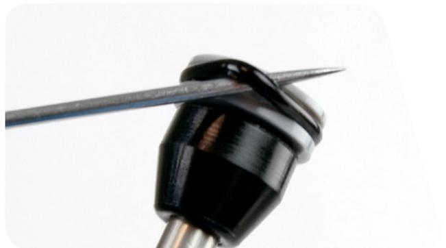
**12** Entfernen Sie mit den Fingern oder einem Dorn den oberen Anschlagpufferkegel vom Luftkolben.
