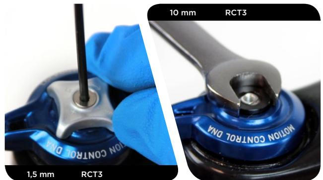
**RLT:** Entfernen Sie die Einstellschraube des Gate-Einstellers mit einem 1,5-mm-Inbusschlüssel. Entfernen Sie den Gate-Einsteller, den Druckstufeneinstellung und die O-Ring-Dichtung.
