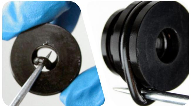
**11** Entfernen Sie mit den Fingern oder einem Dorn den äußeren O-Ring des Luftkolbens. Setzen Sie mit den Fingern einen neuen O-Ring ein.
