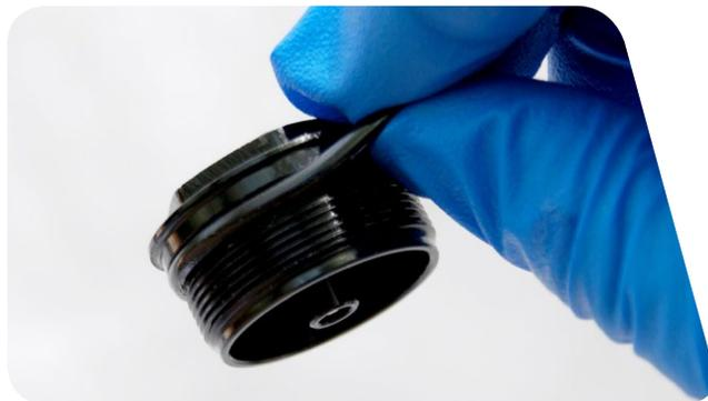
**4** Schrauben Sie mit einem 8-mm-Inbusschlüssel bis zu vier Bottomless Tokens™ auf die Unterseite der Abdeckkappe und ziehen Sie sie mit 1,1 bis 2,3 N•m fest. Die empfohlene Anzahl von Bottomless Tokens™ können Sie der Tabelle im Abschnitt [Optionale Einstellung des Federwegs](#) entnehmen.
