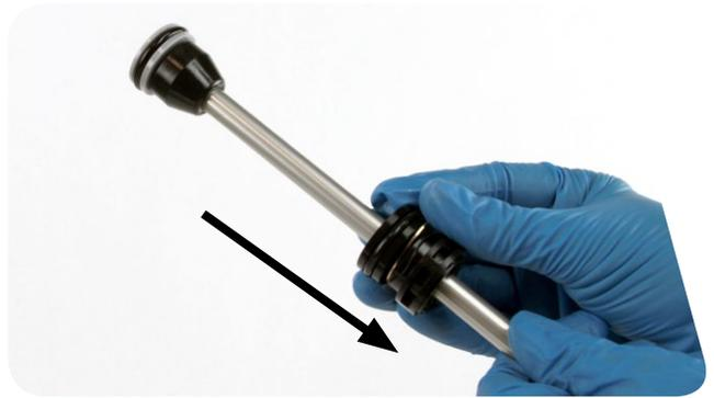
**10** Entfernen Sie mit den Fingern oder einem Dorn den äußeren O-Ring des schwimmenden Dichtkopfs und den inneren O-Ring des Dichtkopfs. Setzen Sie mit den Fingern die neuen O-Ringe ein.
