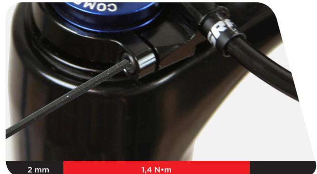
Wickeln Sie den Zug um den Zugring und führen Sie ihn durch die Zugbefestigungsbohrung. Ziehen Sie die Zugklemmschraube mit einem 2-mm-Inbusschlüssel mit 0,9 N•m fest, während Sie kräftig am Zug ziehen.
