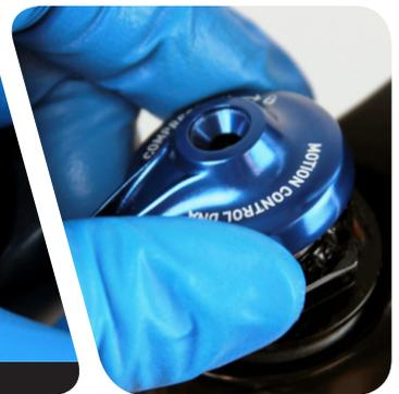
**RLT und RL Remote: Drücken Sie den Fernbedienungshebel in die offene Position.**
