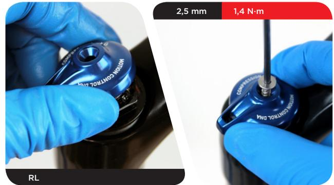
**4 RLT und RL Remote:** Montieren Sie den Zuganschlagring an der Druckstufen-Abdeckkappe, sodass der Zuganschlag zur Vorderseite der Gabel weist und senkrecht zum Gabelkopf steht. Setzen Sie die Zugendkappe und die Außenhülle in die Aufnahme ein.
