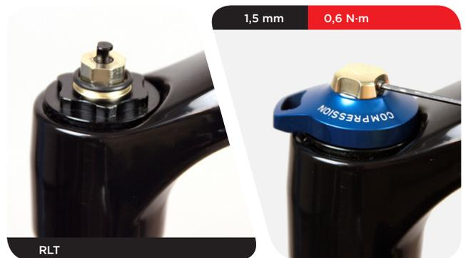
**RL:** Montieren Sie den Druckstufeneinstellung so auf der Abdeckkappe des Druckstufendämpfers, dass die Nase des Einstellrings am Anschlag anliegt.
