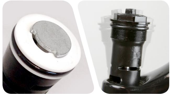
**RLT und RL Remote:** Drehen Sie den Mitnehmer der Druckstufen-Abdeckkappe mit einem 8-mm-Maulschlüssel in die offene Position, während Sie den Druckstufendämpfer in das Standrohr einführen. Drücken Sie ihn nach unten und bewegen Sie ihn hin und her, bis der Dämpfer fest sitzt.
