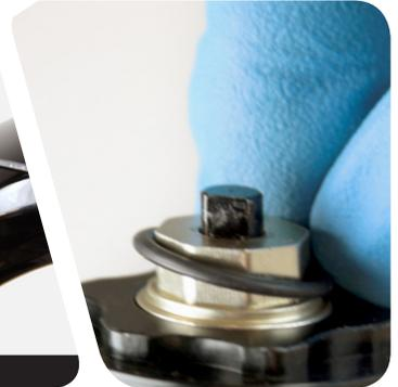
**RL:** Entfernen Sie die Befestigungsschraube des Druckstufeneinstellrings mit einem 2,5-mm-Inbusschlüssel. Entfernen Sie den Druckstufeneinstellung.
