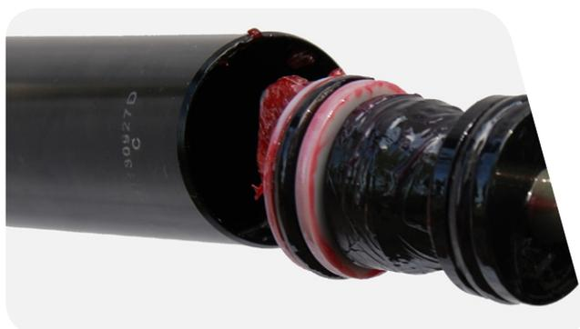
**6** Poussez la came pneumatique dans le tube supérieur afin d'éviter qu'elle ne se raye lors de la mise en place de l'anneau de blocage.
