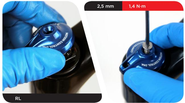
**4** **Commande à distance RLT et RL** : installez le collier d'arrêt du câble sur le capuchon supérieur de compression de manière à ce que l'arrêt du câble soit tourné vers l'avant de la fourche, perpendiculairement au té. Installez la virole du câble et sa gaine dans l'orifice.
