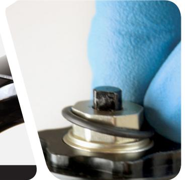
**RL** : à l'aide d'une clé hexagonale de 2,5 mm, retirez la vis de maintien de la molette de réglage de la compression. Retirez la molette de réglage de la compression.
