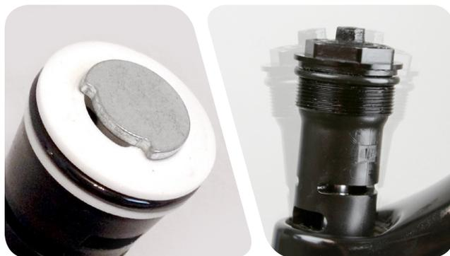
**Commande à distance RLT et RL** : à l'aide d'une clé plate de 8 mm, faites tourner la came du capuchon supérieur de compression en position ouverte tout en insérant l'amortisseur de compression dans le tube supérieur. Enfoncez-le puis secouez en tous sens jusqu'à ce que l'amortisseur soit bien en place.
