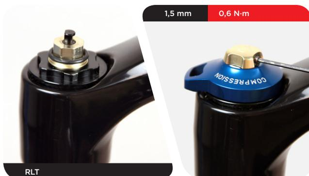
**RL** : installez la molette de réglage de la compression sur le capuchon supérieur de l'amortisseur de compression de manière à ce que la languette de la molette vienne en butée contre l'arrêt.
