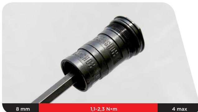
**5** Avec les doigts ou une pointe, retirez et remplacez le joint torique du capuchon de la valve pneumatique.
