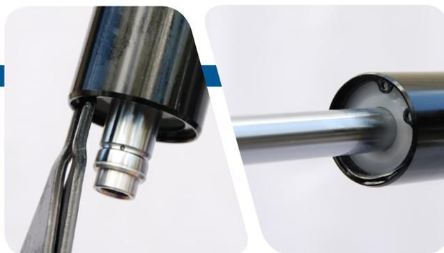
**5** Tirez la came de l'amortisseur du rebond vers le bas en position d'extension maximale.
