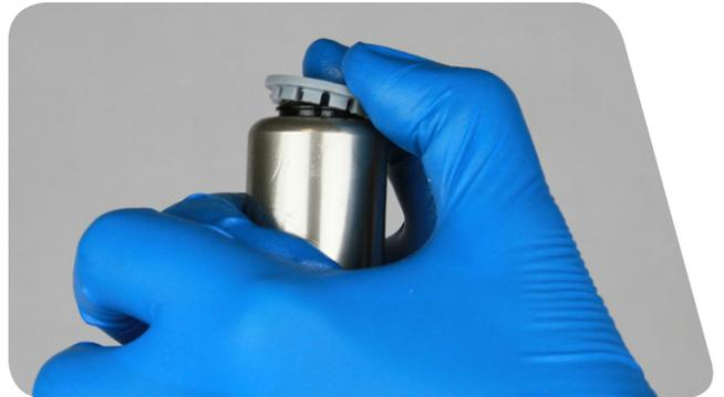
**8** 将回弹阻尼轴安装到上管顶部，活塞在上。
