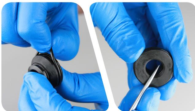
**2** 在内外侧密封头O型圈和密封头螺纹上涂抹润滑脂。
