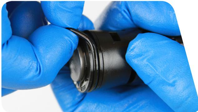
**5** 将油液倒入油盘。往里推回弹阻尼器，直至阻尼器有25 mm露在外面，以排出多余的油液。
