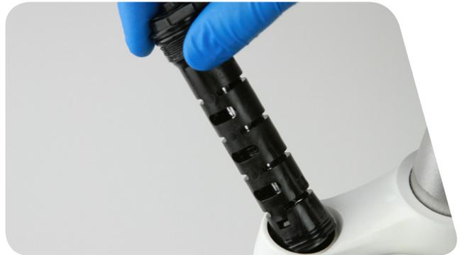
12 XC 28: 用带24 mm套筒的扭矩扳手将阻尼器顶盖拧紧至5.5 N·m。
