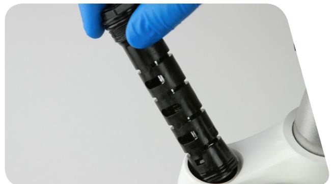
**4** 卸下顶盖O型圈。安装新的顶盖O型圈。
