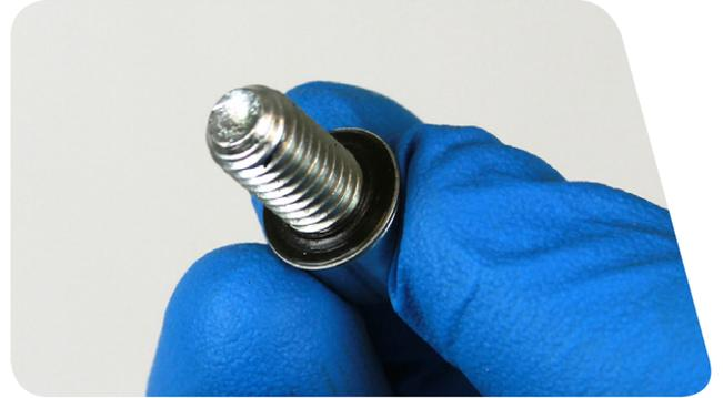
**7** 将底部螺栓安装到下管的螺栓孔内。用带 5 mm 六角旋具套筒的扭矩扳手将螺栓拧紧至 6.8 N·m。
