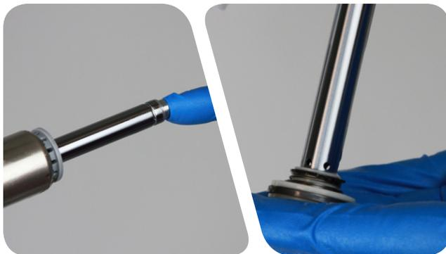
**7** 用平头螺丝刀从上管底部卸下密封头固定环。
