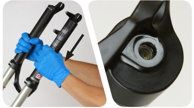
**6** 擦净底部螺栓、防变形垫圈以及防变形垫圈固定环。检查防变形垫圈和固定环。若防变形垫圈或固定环已被压扁或变形，请予以更换。
