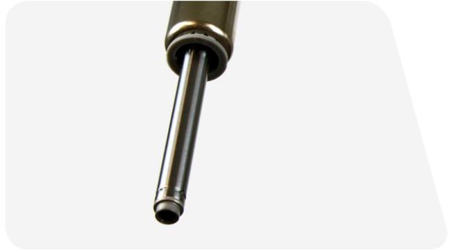
10 查询下表，确定倒入阻尼器侧上管内的RockShox® 5wt避震油用量。
