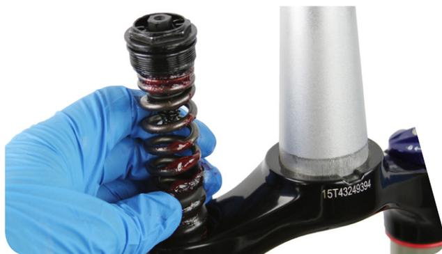
**3** XC 28: 用带24 mm套筒的扭矩扳手将弹簧顶盖拧紧至5.5 N·m。
