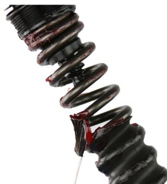
**2** 将卷簧组件插入非弹簧侧上管的顶部。
