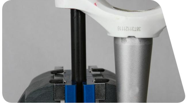
**7** 将固定环安装在上管底部的密封头边缘上。
