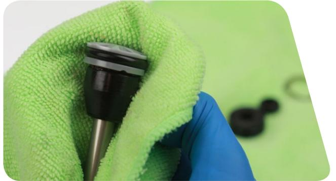
**18** Retirez les joints toriques interne et externe situés sur la tête d'étanchéité flottante. Appliquez de la graisse sur des joints toriques neufs puis mettez-les en place.
