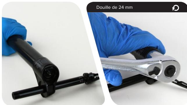
**15** Retirez le joint torique du capuchon inférieur. Appliquez de la graisse sur un joint torique neuf puis mettez-le en place.
