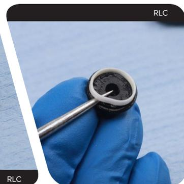
**3** Mettez en place une bague de coulissage neuve dans la cannelure. Mettez en place un ressort dans le trou situé sur le dessous de la molette de compression basse vitesse. Mettez en place une bille de détente par-dessus le ressort.
