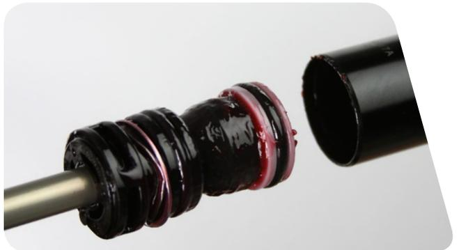
**5** Les anneaux de blocage ont un côté avec un angle acéré et un autre avec un angle arrondi. Installez les anneaux de blocage en faisant en sorte que le côté avec l'angle acéré soit orienté vers l'outil pour en faciliter l'installation et le démontage.
