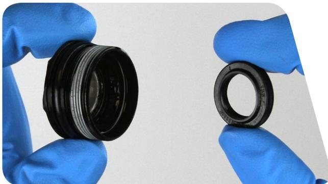
**13** Retirez la bague de coulissage située sur le Dig Valve™. Installez une bague de coulissage neuve.
