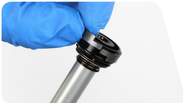
**14** Installez la tête d'étanchéité de l'amortisseur sur la came du rebond avec le filetage orienté vers le piston.
