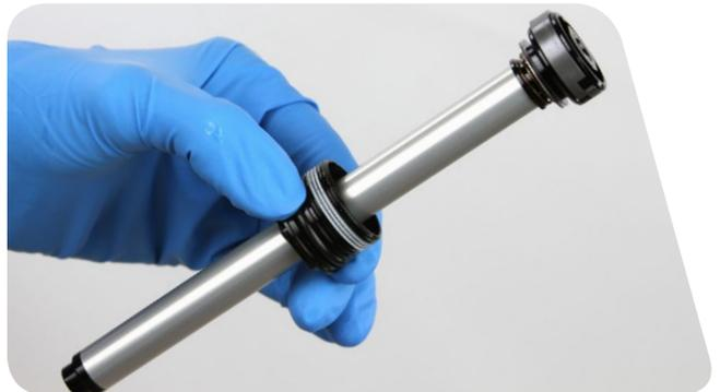
**12** Retirez le joint torique situé sur la tête d'étanchéité de l'amortisseur. Avec une pointe, piquez puis retirez le joint anti-poussière de la tige.
