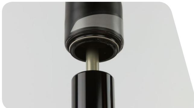
**6** Insérez l'outil d'ancrage par le bas du fourreau en fibre de carbone de manière à ce qu'il s'engage dans l'ancrage.
