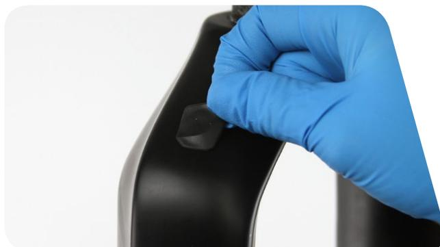
**11** Reportez-vous aux réglages notés avant l'entretien ou au tableau des pressions pneumatiques imprimé sur le fourreau supérieur de la fourche, afin de mettre le ressort pneumatique à la pression recommandée.
