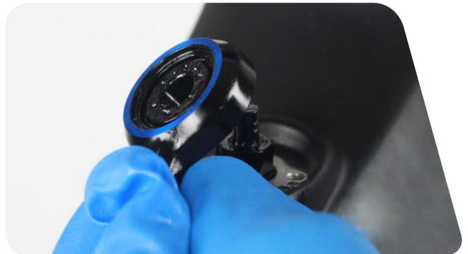
**2b** **Commande à distance** : retirez la bobine supérieure, la vis de maintien et la bobine inférieure situées sur le socle de la molette.
