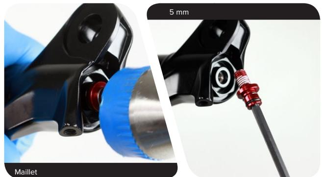
**4** Retirez le tube supérieur hors du fourreau en fibre de carbone.
