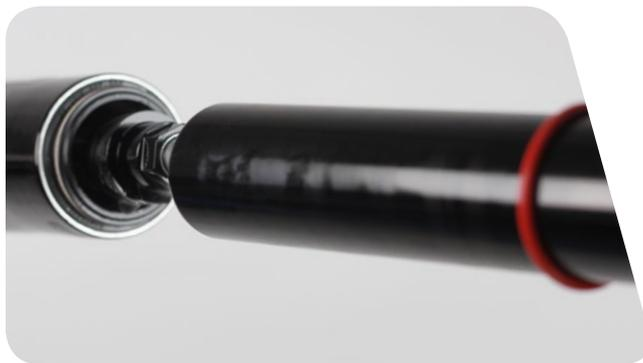
**7** Insérez l'outil d'ancrage par le bas du fourreau en fibre de carbone pour engager l'ancrage de l'amortisseur sur le Charger 2 Damper™.
