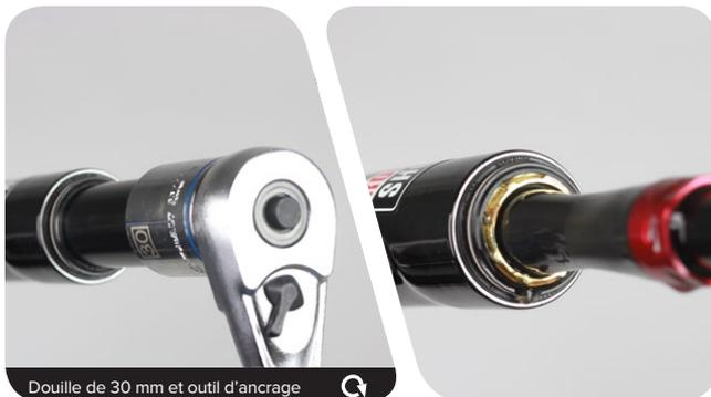
Douille de 30 mm et outil d'ancrage
