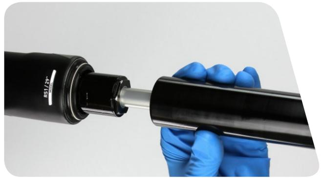
**5** Insérez l'outil d'ancrage par le fond du fourreau en fibre de carbone de manière à engager l'ancrage de l'amortisseur sur l'Accelerator Damper™.
