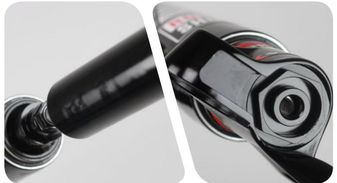
**5** À l'aide d'une pointe et d'une pince à bec fin, retirez la rondelle d'écrasement usagée située sur le boulon inférieur.
