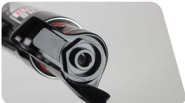
**8** Installez le boulon inférieur et serrez-le.
