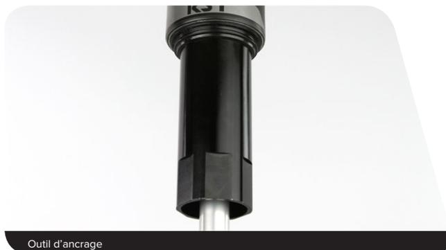
**7** Tournez l'outil d'ancrage **dans le sens des aiguilles d'une montre** pour dévisser l'ancrage.
