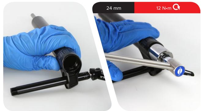
**7** Mettez en pression le ressort pneumatique pour maintenir la came pneumatique en position d'extension complète lors de l'installation du ressort pneumatique.
