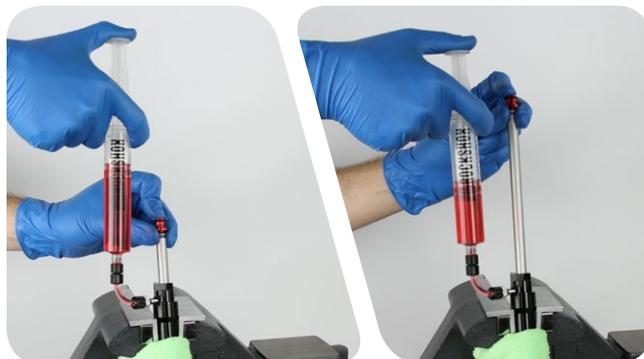
**13** Tirez la came de l'amortisseur du rebond au maximum. Appuyez sur le piston de la seringue puis relâchez-le. Laissez la vessie reprendre sa position normale en attendant quelques instants jusqu'à ce que la seringue cesse de se remplir.
