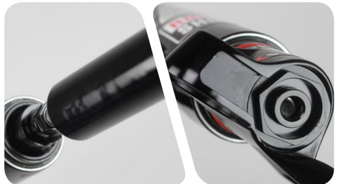
**5** Entfernen Sie mit einem Dorn und einer Spitzzange den alten Sprengring von der unteren Schraube.
