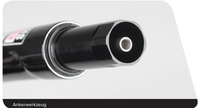
**6** Drehen Sie das Ankerwerkzeug **im Uhrzeigersinn** und lösen Sie die Accelerator Damper-Baugruppe.
