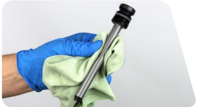
**11** Entfernen Sie den Dämpfer-Dichtkopf von der Zugstufen-Führungsstange.
