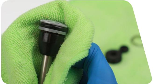
**18** Entfernen Sie den äußeren und den inneren O-Ring vom schwimmenden Dichtkopf. Tragen Sie Schmierfett auf die beiden neuen O-Ringe auf und bauen Sie sie ein.
