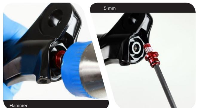
**4** Entfernen Sie das Standrohr aus dem Carbon-Oberteil.
