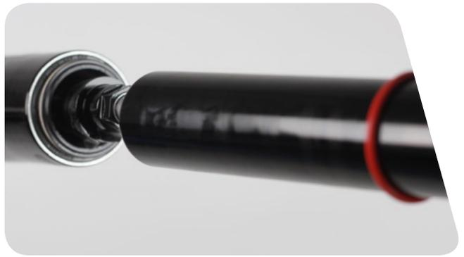
**7** Führen Sie das Ankerwerkzeug in die untere Seite des Carbon-Oberteils ein, sodass es im Dämpferanker auf dem Charger 2 Damper™ fasst.
