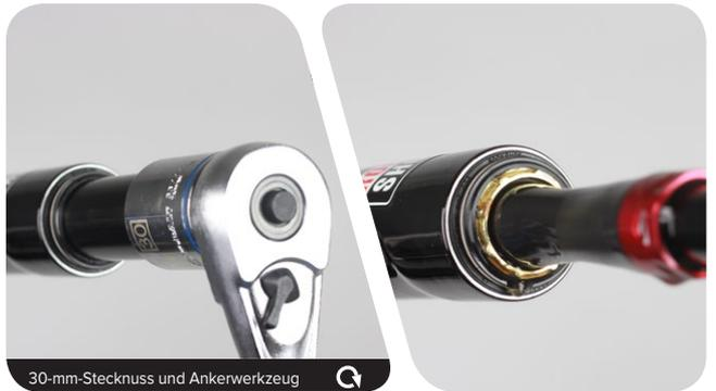
**9** Spannen Sie die Schlüsselflanken der Charger 2 Damper-Baugruppe so in einen Schraubstock ein, dass die Zugstufen-Führungsstange nach oben weist.
