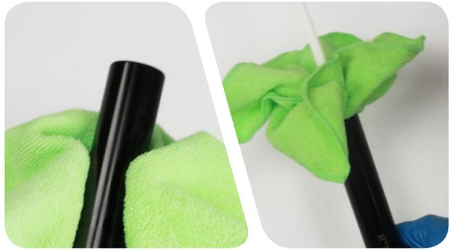
**17** Entfernen Sie die Dichtkopf-Baugruppe von der Luftführungsstange. Säubern Sie die Luftführungsstangen-Baugruppe.
