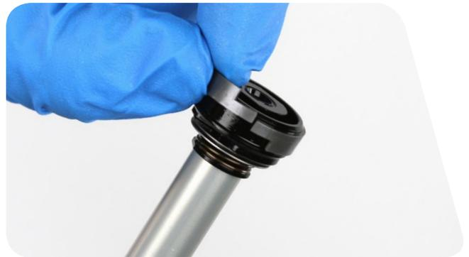
**14** Schieben Sie den Dämpfer-Dichtkopf auf die Zugstufendämpfer-Führungsstange. Dabei müssen die Gewinde zum Kolben weisen.
