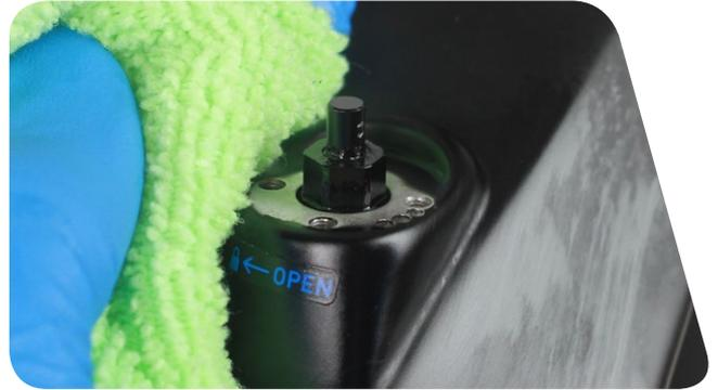
**2** Entfernen Sie den Gleitring, die Federn und die Rastkugeln von der Unterseite des Low-speed-Druckstufeneinstellrings. Säubern Sie den Einstellring.
