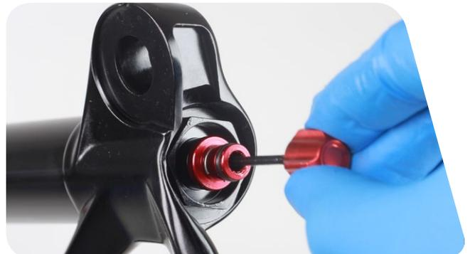
**10** Drücken Sie die Leitungsdurchführung in die Montagebohrung.
