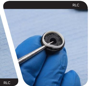
**3** Montieren Sie einen neuen Gleitring in der Nut. Setzen Sie eine Feder in das Loch an der Unterseite des Low-speed-Druckstufeneinstellrings ein. Platzieren Sie eine Rastkugel auf der Feder.
