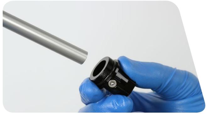
**6** Retire el tornillo de purgado del cabezal de sellado del amortiguador de rebote.
