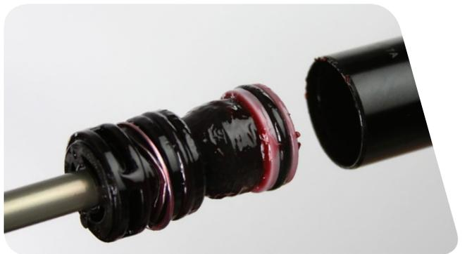
**5** Los anillos de retención tienen un lado recto y otro redondeado. Si coloca el anillo de retención con el lado recto apuntando hacia la herramienta, le resultará más fácil instalarlo y retirarlo.
