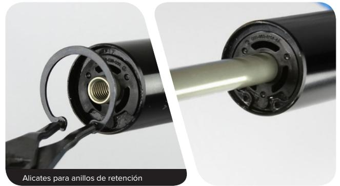
**6** Instale el Maxle Ultimate™ a través de la puntera. Enrosque la tapa inferior en la base del puntal.
