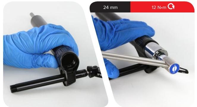
**7** Dé presión al muelle neumático para mantener el eje neumático extendido durante la instalación del muelle.
