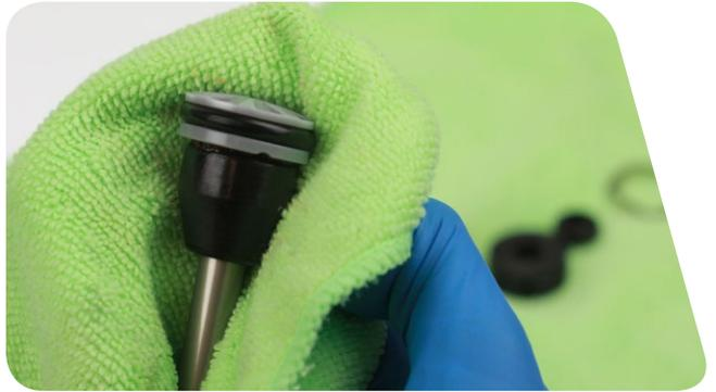
**18** Retire las juntas tóricas exterior e interior del cabezal de sellado flotante.
