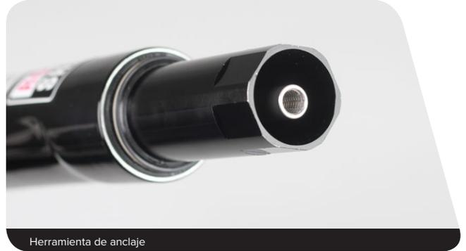
**8** Gire la herramienta de anclaje **en sentido horario** y desenrosque el conjunto del Charger 2 Damper.
