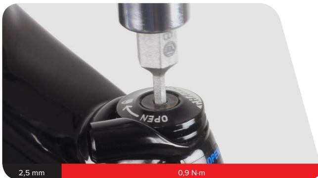
Con esto concluye el mantenimiento del control remoto de la horquilla de suspensión RockShox® RS-1™ RL.
