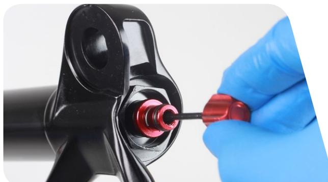
**10** Presione la anilla de plástico en el orificio de montaje.
