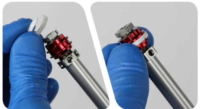
**5** Aplique SRAM® Butter a una nueva junta tórica de cabezal de sellado interior. Instale el cabezal de sellado en el eje del amortiguador de rebote.
