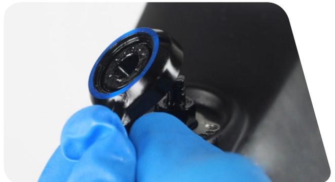
**2b Control remoto:** Retire el carrete superior, el tornillo de retención y el carrete inferior de la base del mando.
