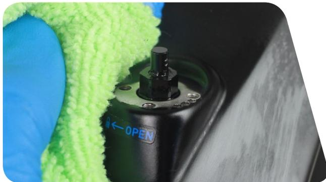
**2** Retire el anillo deslizante, los muelles y las bolas de retención de la parte inferior del mando de compresión de baja velocidad. Limpie el mando.
