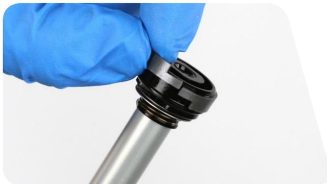
**14** Instale el cabezal de sellado del amortiguador en el eje de rebote, con las roscas orientadas hacia el pistón.
