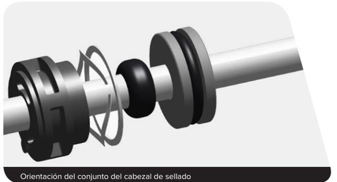
Orientación del conjunto del cabezal de sellado
