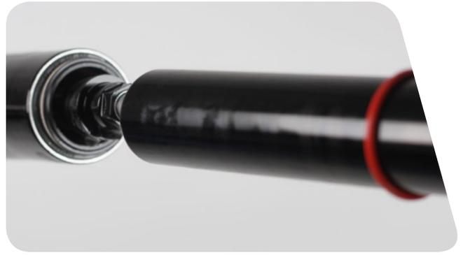
**7** Inserte la herramienta de anclaje en la base de la parte superior de fibra de carbono para que se acople con el anclaje del amortiguador del Charger 2 Damper™.
