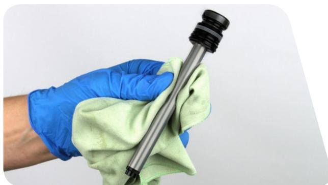
**11** Saque el cabezal de sellado del amortiguador del eje de rebote.
