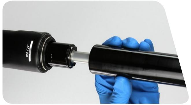
**5** Inserte la herramienta de anclaje en la base de la parte superior de fibra de carbono para que se acople con el anclaje del amortiguador del Accelerator Damper™.
