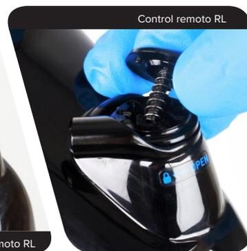
**3** Coloque la horquilla en posición horizontal en el soporte de bicicletas. Retire el mando del regulador de rebote.
