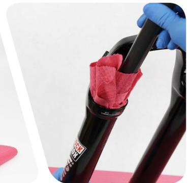
Remplacez les joints ou joints toriques par des joints neufs fournis dans le kit d'entretien, comme indiqué. Avec les doigts ou une pointe, retirez le joint ou joint torique usagé.
