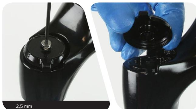
**1b Réglage par commande à distance :** retirez la vis de maintien de la bobine, puis retirez la bobine de la commande à distance.
