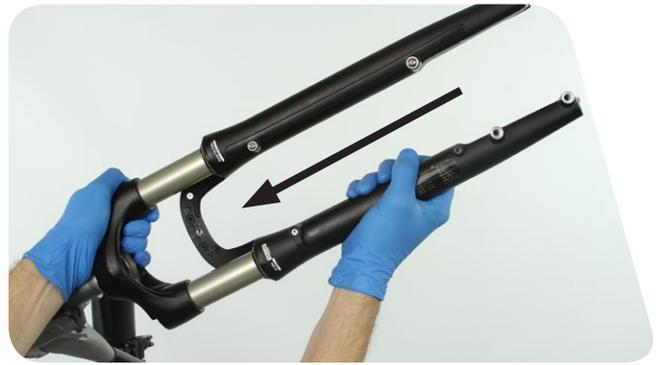
Les comes du ressort et de l'amortisseur (A) doivent être visibles à travers les trous des boulons inférieurs.
