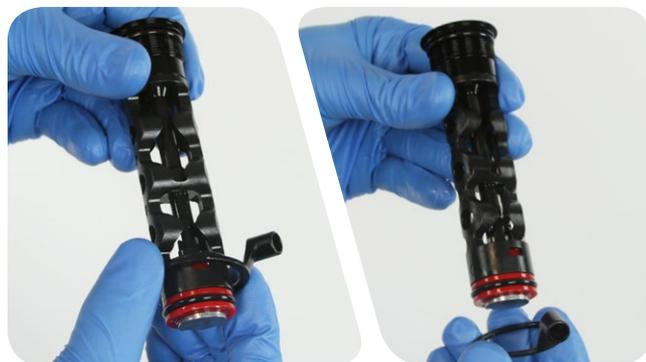
**4** Retirez les joints toriques situés sur le capuchon supérieur ainsi que le piston de l'amortisseur, puis jetez-les.
