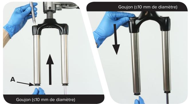
**5** Poussez le piston de l'amortisseur du rebond dans le tube supérieur.
