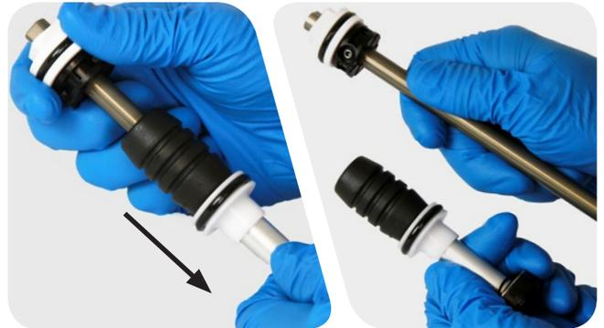
**6** Retirez puis jetez le joint torique du piston pneumatique positif.
