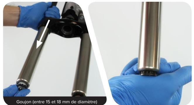
Confirmez que la rondelle de maintien est parfaitement mise en place.
