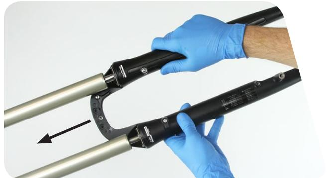
Das innere untere Ende des unteren Gabelbeins sollte die Feder oder Dämpferführungsstangen nicht berühren. Zwischen den Führungsstangenenden und den Schraubenbohrungen in den unteren Gabelbeinen sollte ein Spalt (A) zu sehen sein.
