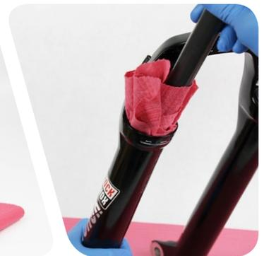
Ersetzen Sie O-Ringe und Dichtungen wie angewiesen durch neue Teile aus dem Wartungssatz. Entfernen Sie den O-Ring oder die Dichtung mit den Fingern oder einem Dorn.
