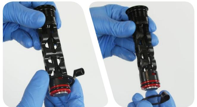
**4** Entfernen Sie die Abdeckkappe und die O-Ringe des Dämpferkolbens und entsorgen Sie die O-Ringe.
