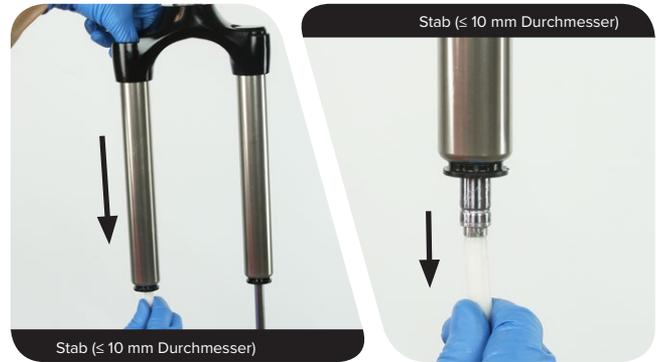
Ziehen Sie den Dämpfer bis zum Anschlag nach unten.
