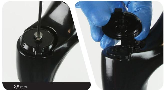
**1b Fernbedienter Einsteller:** Entfernen Sie die Befestigungsschraube des Fernbedienungsringes und danach den Fernbedienungsring.
