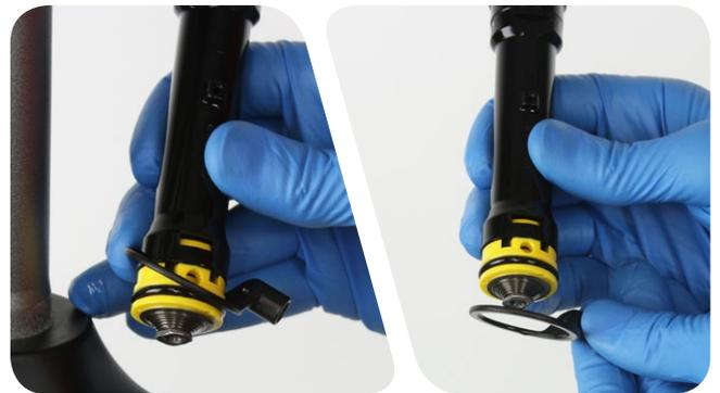
**4** Entfernen Sie die Abdeckkappe und die O-Ringe des Kolbens und entsorgen Sie die O-Ringe.
