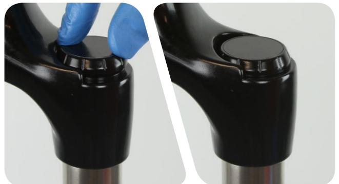
**1a Einsteller am Gabelkopf:** Drehen Sie den Einstellring gegen den Uhrzeigersinn in die geöffnete Position.
