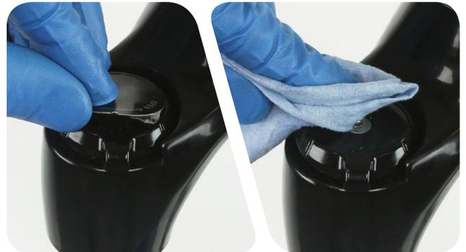
Entfernen Sie die Befestigungsschraube des Einstellrings und danach den Einstellring.
