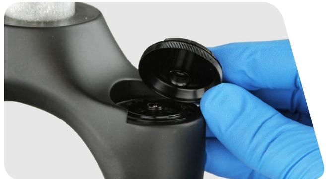
**3 Paragon Gold:** Öffnen Sie das Schrader-Ventil und lassen Sie den Luftdruck vollständig ab.
