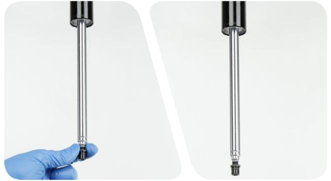
**7** Entfernen Sie den Zugstufendämpfer und den Dichtkopf.
