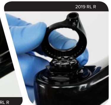
Entfernen Sie das Unterteil des Fernbedienungsrings.
