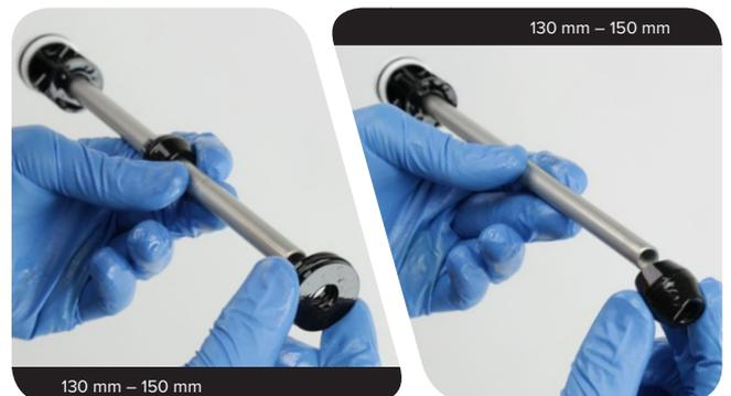
**8** Entfernen Sie die O-Ring-Dichtung vom Luftkolben und entsorgen Sie sie. Säubern Sie den Luftkolben.
