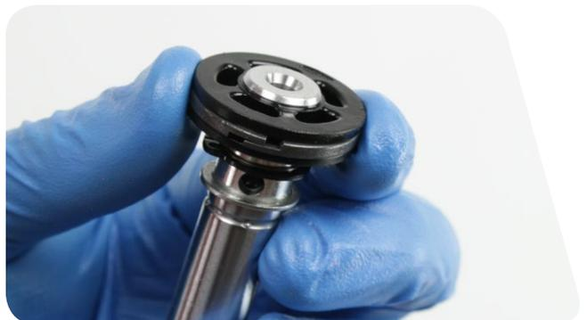
**5** Montieren Sie den Dichtkopf auf der Zugstufendämpfer-Führungsstange.
