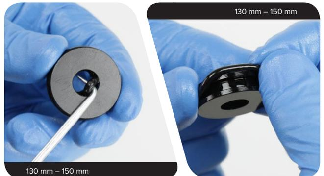
**10** Tragen Sie Schmierfett auf die neuen inneren und äußeren O-Ring-Dichtungen auf und montieren Sie sie.
