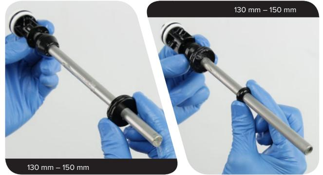
**5** **130 mm – 150 mm:** Montieren Sie die Sicherungsscheibe, eine neue Federscheibe und die Grundplatte in dieser Reihenfolge auf der Luftführungsstange.
