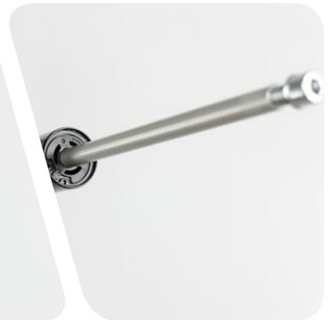
**9** Füllen Sie 2 mL RockShox® 5 WT-Federungsöl in das Standrohr mit der Luftfeder.
