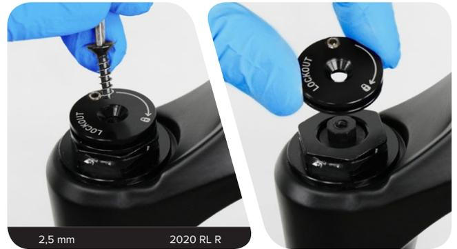
**2c** Schrauben Sie die Druckstufendämpfer-Abdeckkappe ab.
