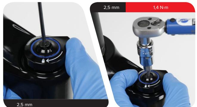
**6b** 2019 RL R: Bringen Sie den Zuganschlagring mit der Zugführung in der 6-Uhr-Position bzw. ca. 20 bis 30 Grad vom Mittelpunkt an.
