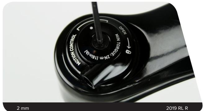
**6c** **2020 RL R / TK R:** Bringen Sie den Zuganschlagring mit der Zugführung 20 Grad vom Mittelpunkt an.
