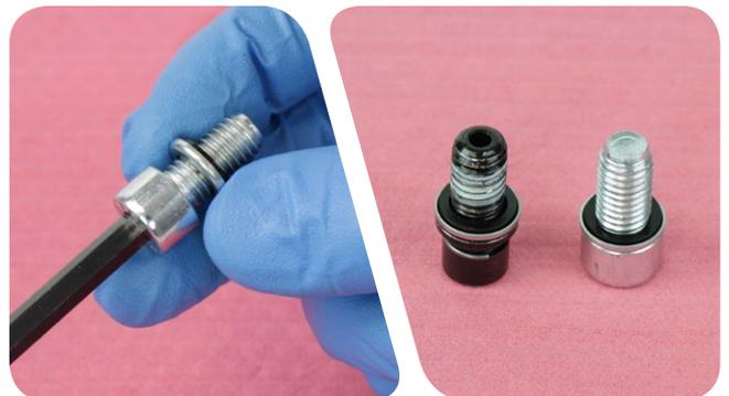
**8** Setzen Sie die massive (nicht hohle) untere Schraube in die Führungsstange auf der Federseite ein.
