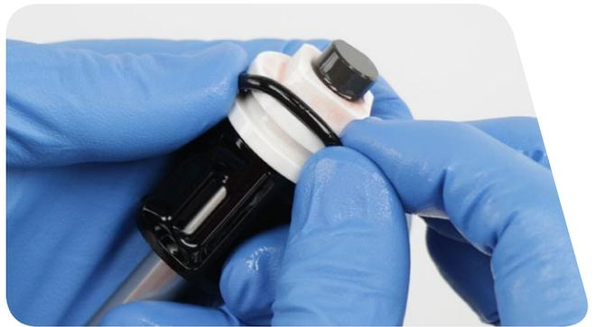
**9** Entfernen Sie die innere und die äußere O-Ring-Dichtung vom Dichtkopf und entsorgen Sie sie. Säubern Sie den Dichtkopf.
