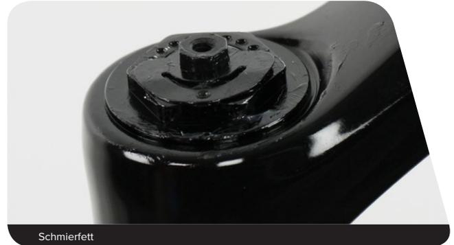
**6a** **RL:** Bringen Sie den Einstellring mit der Nase in der 7- bis 8-Uhr-Position (entsperrte Position) an.
