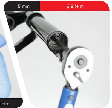
**9** Tragen Sie ein wenig Fett auf das Ende des Sechskants des Zugstufeneinstellers und um die Außenseite der unteren Dämpferschraube herum auf. Montieren Sie den Zugstufeneinsteller auf der unteren Schraube des Zugstufendämpfers.
