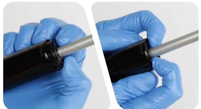
**7** Schieben Sie die Luftführungsstange in die Grundplatte.
