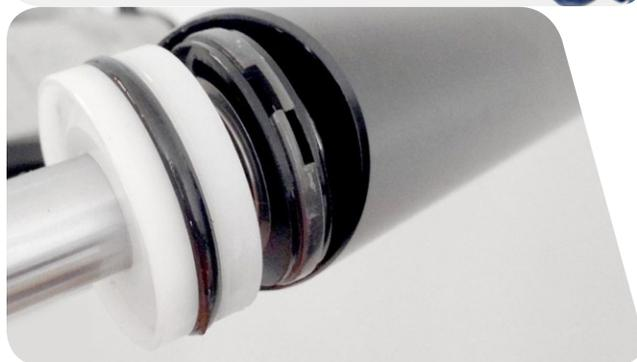
**3** Avec le doigt, repoussez la tête d'étanchéité dans le tube supérieur jusqu'à faire apparaître la cannelure de l'anneau de blocage.
