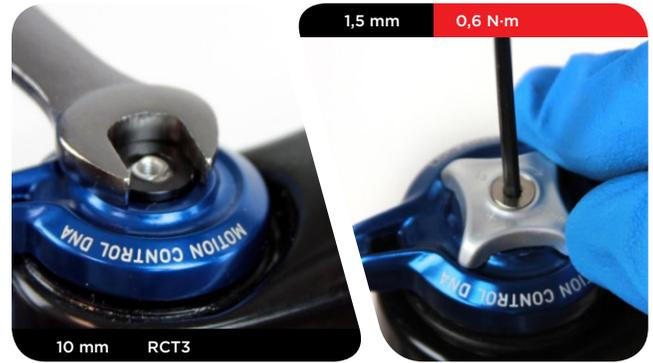
**RLT :** installez un nouveau joint torique sur la came. Installez la molette de réglage de la compression sur le capuchon supérieur de l'amortisseur de compression de manière à ce que la languette de la molette vienne en butée contre l'arrêt.
