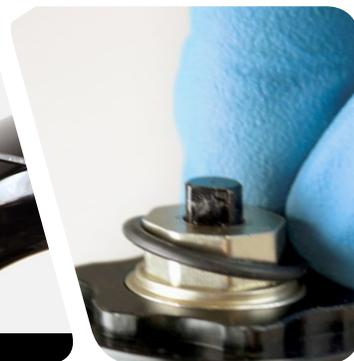
**RL** : À l'aide d'une clé hexagonale de 2,5 mm, retirez la vis de maintien de la molette de réglage de la compression. Retirez la molette de réglage de la compression.
