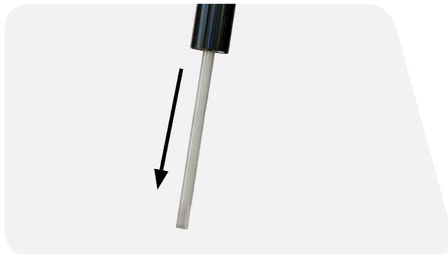
**6** Reportez-vous au tableau pour connaître le volume de liquide de suspension RockShox® 5wt à verser dans le tube supérieur du côté de la chaîne.
