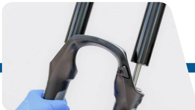
**7** Vaporisez de l'alcool isopropylique sur l'intérieur et l'extérieur du fourreau inférieur et nettoyez-le avec un chiffon.
