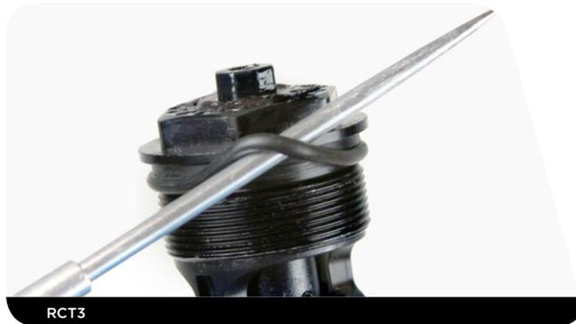
**4** Avec les doigts ou une pointe, retirez le joint torique du piston de l'amortisseur de compression. Appliquez du **liquide de suspension** sur le nouveau joint torique et mettez-le en place.
