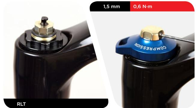
**RL :** installez la molette de réglage de la compression sur le capuchon supérieur de l'amortisseur de compression de manière à ce que la languette de la molette vienne en butée contre l'arrêt.
