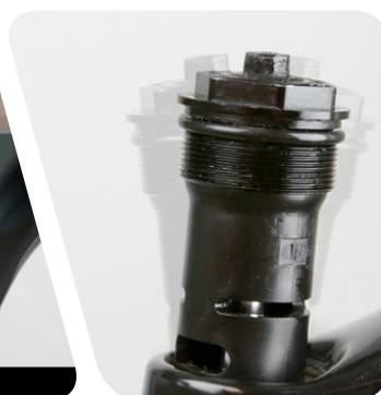
**3** À l'aide d'une pointe ou de vos doigts, retirez le joint torique du capuchon supérieur de compression. Installez un joint torique neuf sur le capuchon supérieur de compression.
