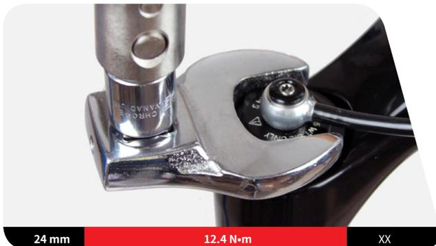
**3** **RLT和RL线控:**将线缆限位环安装在压缩顶盖上,线缆限位部分面对前叉前部,垂直于圆弧面。
