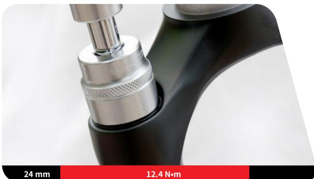
**XX:**用带24 mm爪形套筒的扭矩扳手将压缩顶盖拧紧至12.4 N·m。
