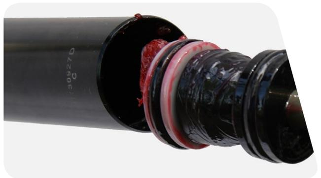
**7** 将空气轴推入上管, 以防在安装固定环时将其刮伤。
