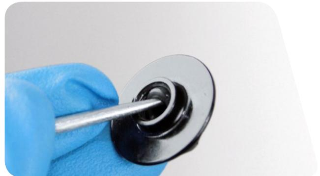
**6** 将空气轴推入上管,以防在拆卸固定环时将其刮伤。
