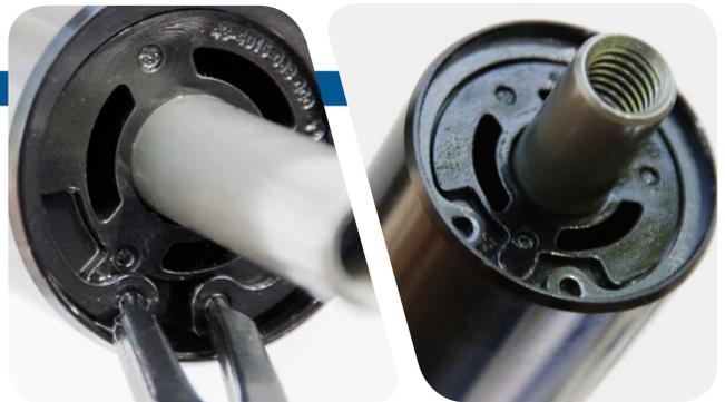
**8** 将顶盖插入上管顶部。用带24 mm套筒的扭矩扳手将顶盖拧紧至12.4 N·m。
