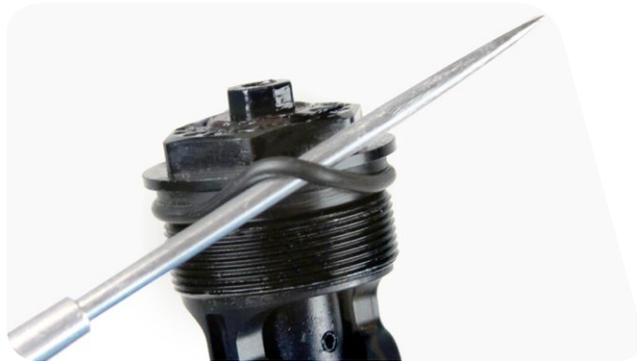
**4** 用手指或尖头针卸下压缩阻尼器活塞的O型圈。在新O型圈上抹上**避震油**并将其安装。
