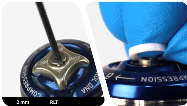
**RL:** 用2.5 mm六角扳手拆下压缩调节旋扭的定位螺丝。拆下压缩调节旋扭。
