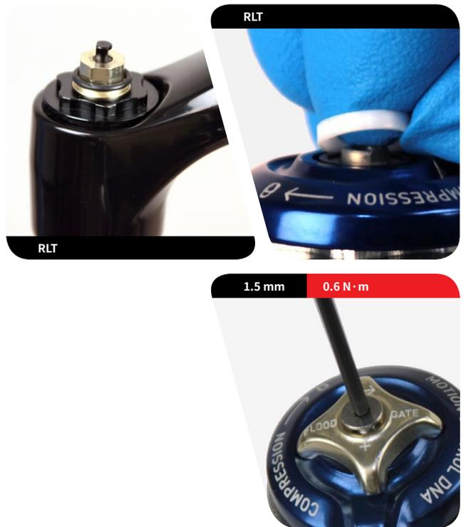
**RL:**将压缩调节旋钮安装在压缩阻尼顶盖上。
