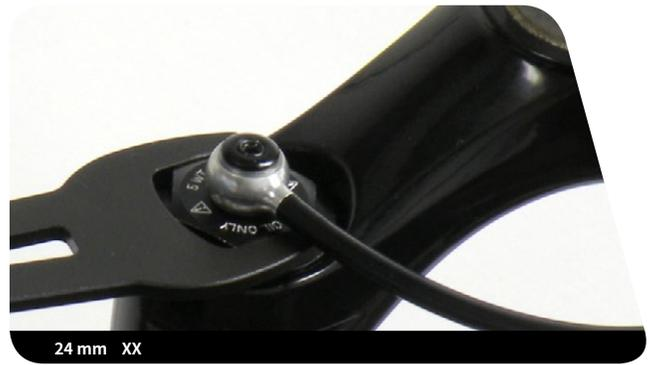
**RLT和RL线控:**将PushLoc™线控按钮按压至压缩位置(开位)。用2 mm六角扳手拧松线缆夹紧螺栓并拿掉线缆。用2 mm六角扳手拧松线缆限位环夹紧螺栓。取下线缆限位环。您无需卸下遥控线线轴。
