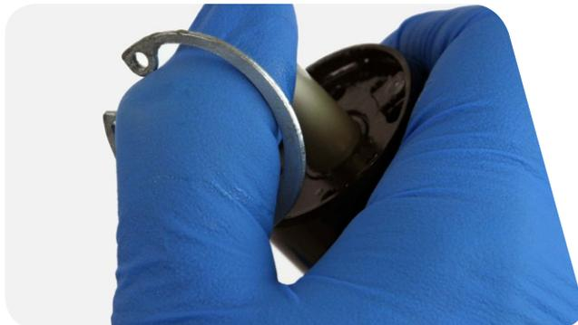
**7** 用力拉空气轴,从上管上拆下空气轴组件。
