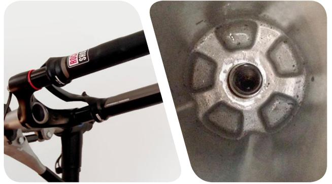
**6** 在非传动侧和传动侧底部螺栓上安装新的抗压垫片固定器和抗压垫片。在传动侧底部螺栓O型圈上抹上润滑脂。
