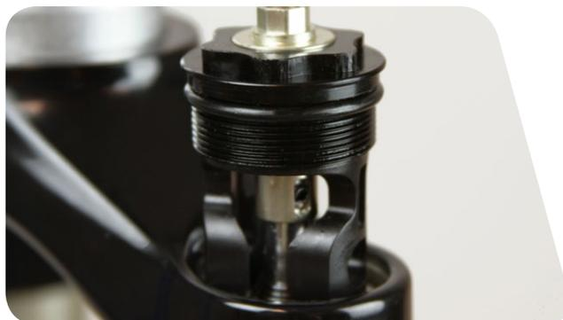
**RLT和RL线控:**将压缩阻尼器插入上管的同时,用8 mm开口扳手把压缩顶盖凸轮顺时针旋转至开位。按下并左右摇晃,直至装好阻尼器。
