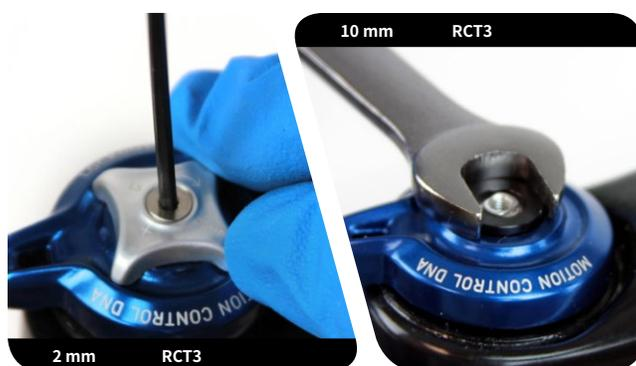
**RLT:** 用2 mm六角扳手拧下出入口设定螺丝。用手指拆下PTFE密封圈。卸除出入口、压缩调解旋扭以及凸轮上的O型圈。
