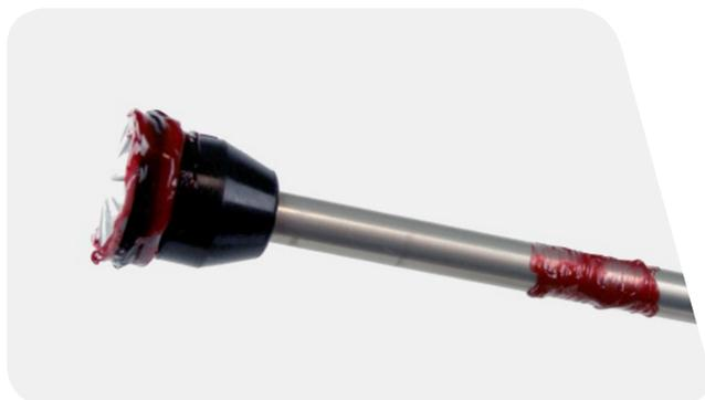
**5** Solo Air (单气室款): 请按照以下顺序将部件安装在空气轴上: 浮动密封头、浮动密封头触顶缓冲器、支撑垫片、波状弹簧以及空气轴导向。
