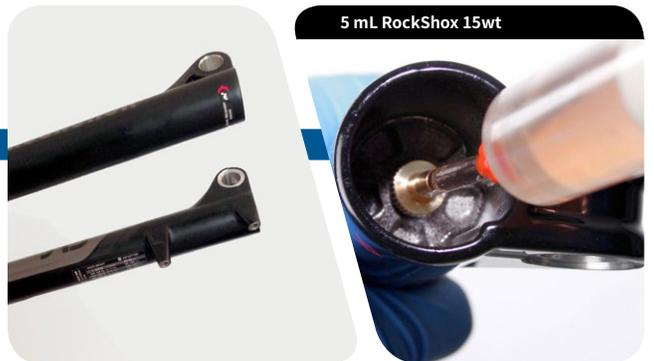
**5** 将下管组件滑到上管上, 直至滑不动, 且可从下管螺栓孔看到空气轴和阻尼轴。
