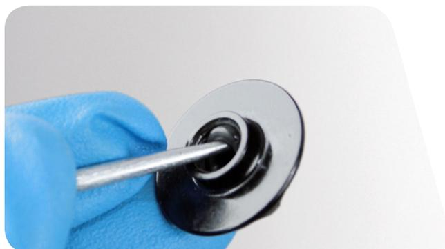
**5** 用平头螺丝刀将密封头碟片推到固定环下。将空气轴推入上管，以防被固定环刮伤。
