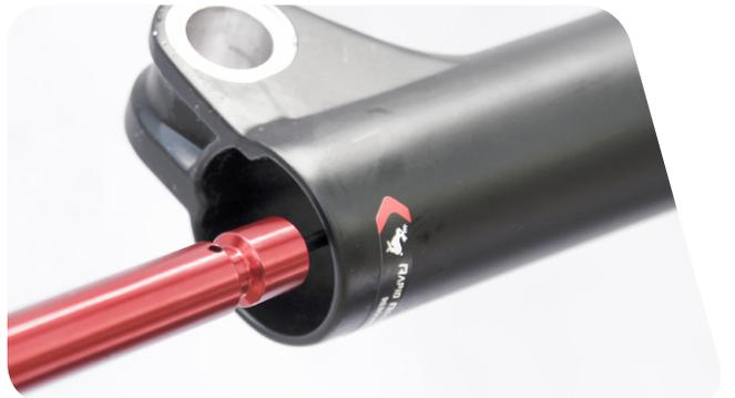
4 用 5 mm 六角扳手，将两个底部螺栓都旋松 3 至 4 圈。
