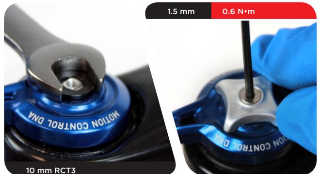
**RL:** 将压缩调节旋钮安装在压缩阻尼顶盖上，使得旋钮拨盘紧靠在硬止动块上。
