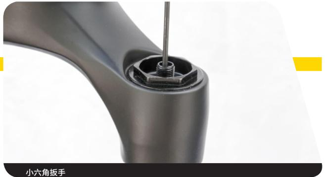
3 从阻尼器侧前叉管的底部螺栓中拉出回弹调节旋钮。
