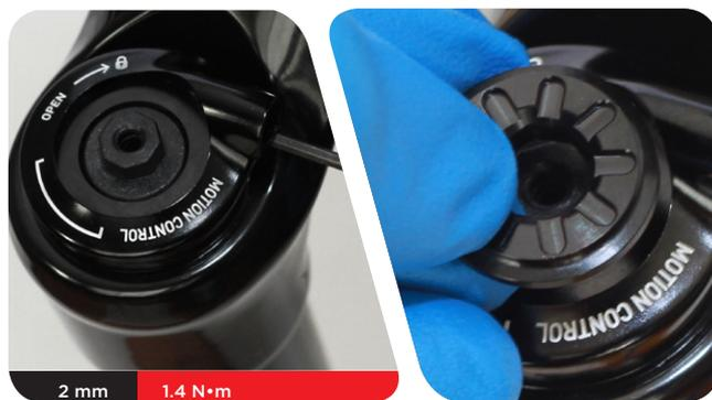
安装线轴顶部，确保使线轴上的指示点定位在线管座上所印的括号内。
