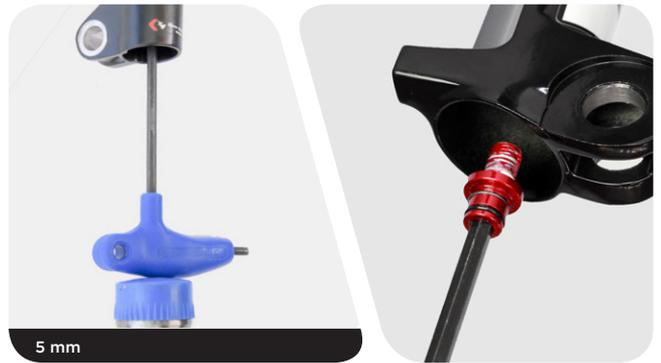
**6** 用力向下拉动下管，直至油液开始排出。继续向下拉，从前叉卸下下管。
