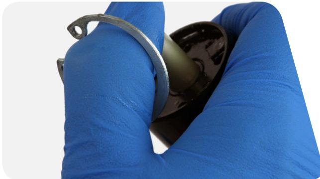
**6** 用力拉空气轴，从上管上拆下空气轴组件。
