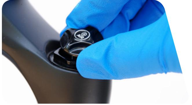
2 用小六角扳手下压美式嘴阀，释放空气罐中的所有气压。
