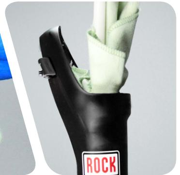
**4** 将新的泡沫塑料环浸泡在 RockShox® 15wt 避震油中。
