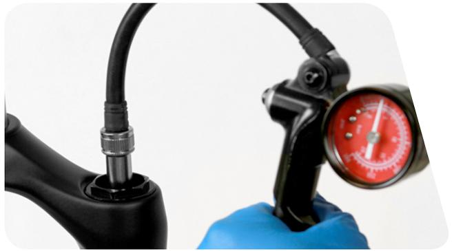
**10** 将气阀盖旋到弹簧侧前叉管顶盖上，直至转不动。
