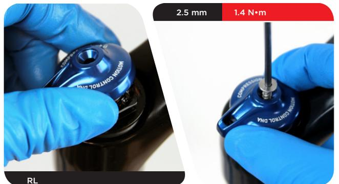
**RL线控：**将线缆限动环安装在压缩顶盖上，线缆限动部分面对前叉前部，垂直于圆弧面。
