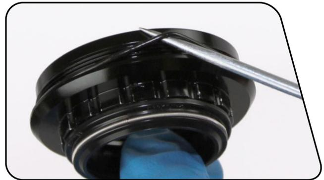
**6** Installez une nouvelle bague anti-extrusion de couleur blanche, un nouveau joint de section carrée et une nouvelle bague anti-extrusion de couleur bleue, avec leur côté étagé tourné vers le haut, à l'intérieur de la partie filetée du collier de la cartouche pneumatique.
