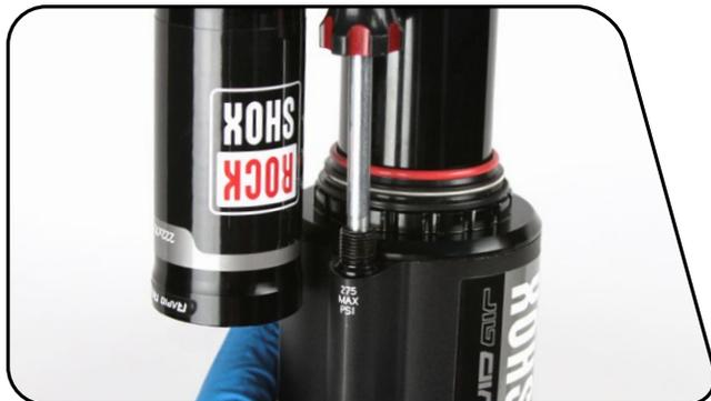
**4** À l'aide d'une clé TORX® T10, retirez le capuchon de l'orifice de remplissage du réservoir du PFI. À l'aide d'une petite clé hexagonale ou d'une pointe, appuyez sur la valve Schrader pour vider toute la pression pneumatique contenue dans le réservoir du PFI.
