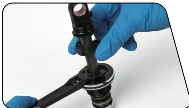
**17** Mettez en place le compresseur Counter Measure™ sur l'unité de la came, comme illustré. Écartez les butées supérieure et inférieure l'une de l'autre afin de serrer la clé à ergots sur la tête d'étanchéité. À l'aide d'une clé hexagonale de 3 mm, serrez le boulon de la butée supérieure.
