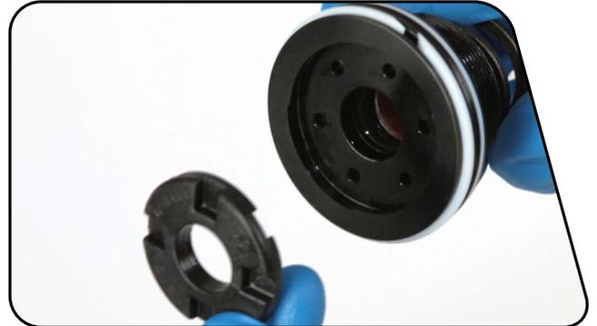
8 Retirez puis remplacez les deux bagues de coulissage de la tête d'étanchéité ainsi que le joint de section carrée.
