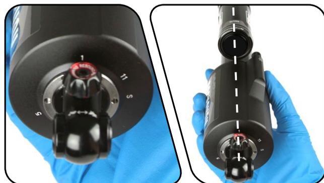
**3** Notez le réglage de la pression pneumatique ; cela vous sera utile lors du réglage qui suivra la procédure d'entretien. Retirez à la main le capuchon de la valve pneumatique. À l'aide d'une petite clé hexagonale, appuyez sur la valve Schrader pour vider toute la pression pneumatique contenue dans la cartouche pneumatique. À l'aide de l'outil pour valve Schrader, retirez puis remplacez l'obus de la valve Schrader.
