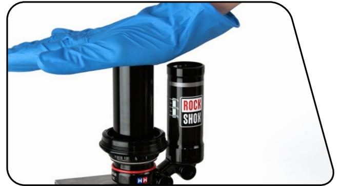
**12** Une fois que la majorité du liquide contenu dans le corps de l'amortisseur est passée dans le réservoir, tapez sur le dessus du réservoir à plusieurs reprises avec la paume de la main pour refaire passer le liquide dans le corps de l'amortisseur. Ceci permet de retirer les bulles d'air encore présentes dans le circuit.
