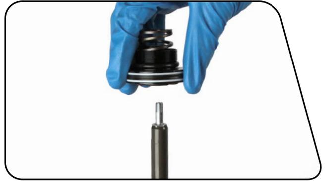
7 Retirez la butée de talonnage de la tête d'étanchéité.
