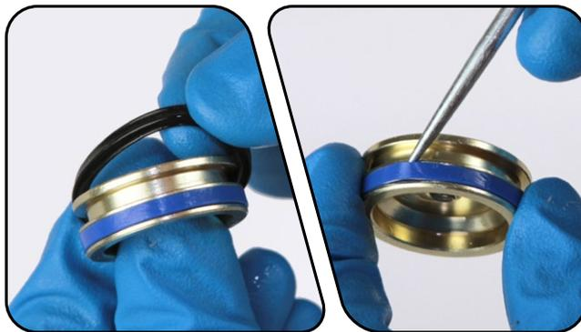
**8** Retirez puis remplacez le joint torique du réservoir du PFI et la rondelle d'épaulement située au-dessus du filetage interne du réservoir du PFI.
