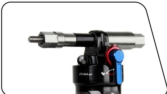
**4** Serrez le receveur dans un étau ou bloquez-le fermement à l'aide d'une clé plate de 13 mm.
