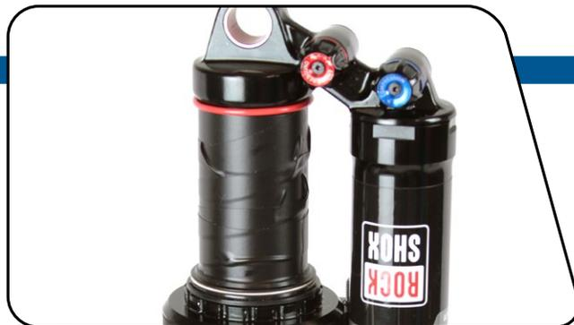
9 Serrez la clé pour cartouche pneumatique RockShox Vivid dans un étau. Placez la cartouche pneumatique dans la clé. À l'aide de l'outil pour jeu de pédalier, faites tourner le collier de la cartouche pneumatique dans le sens inverse des aiguilles d'une montre puis retirez-le de la cartouche pneumatique. Retirez l'amortisseur ainsi que la clé de l'étau.
