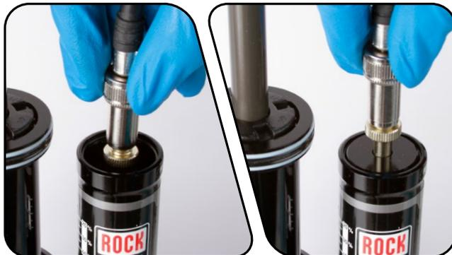
**31** Avec la pompe, mettez le réservoir du PFI en pression à 200 psi (14 bar).
