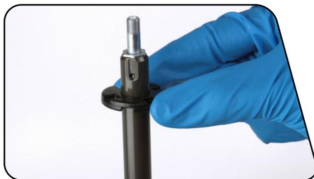
**2** Graissez l'intérieur de la tête d'étanchéité puis mettez-la en place sur l'unité de la came avec le ressort Counter Measure™ tourné vers le haut.
