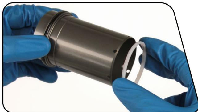
**5** Insérez le manchon interne de la cartouche pneumatique, son côté avec la bague de centrage en premier, dans la cartouche pneumatique. Centrez le manchon interne de la cartouche pneumatique à l'intérieur de la cartouche pneumatique et enfoncez-le à la main dans la cartouche pneumatique jusqu'à ce que la bague de centrage s'insère dans la cannelure située au fond de la cartouche pneumatique.
