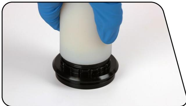
**4** À l'aide d'une pointe, retirez les bagues anti-extrusion ainsi que le joint de section carrée du collier de la cartouche pneumatique.
