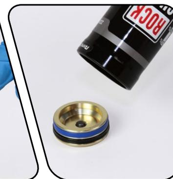
**7** Retirez puis remplacez le joint de section carrée du PFI ainsi que la bague de coulissage.
