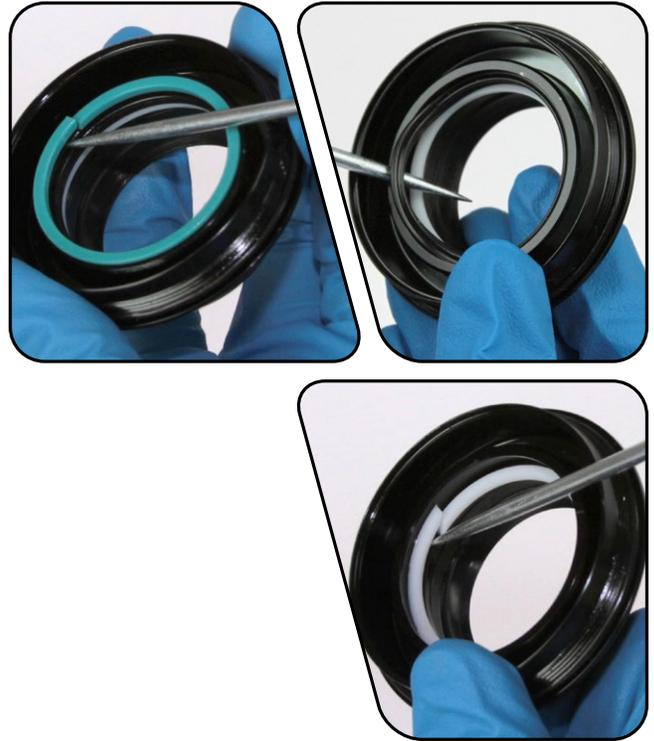
**5** À l'aide d'une pointe, retirez puis remplacez le joint torique situé juste en-dessous du filetage externe du collier de la cartouche pneumatique. Vaporisez de l'alcool isopropylique sur le collier de la cartouche pneumatique puis nettoyez-le avec un chiffon.
