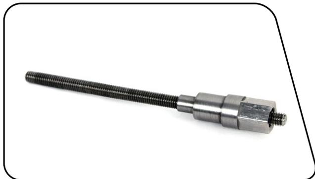
**2** Insérez la tige filetée dans l'œillet de la came jusqu'à ce que la clavette de pression vienne en appui contre la clavette de la bague.
