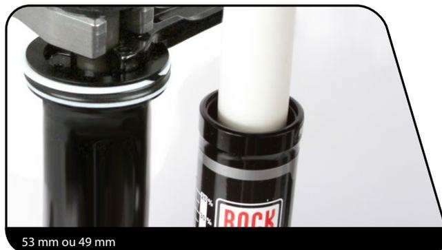
**23** À l'aide d'une clé TORX® T10, remettez en place la vis de purge dans l'orifice de purge puis serrez-la jusqu'à ce que le PFI commence à tourner.
