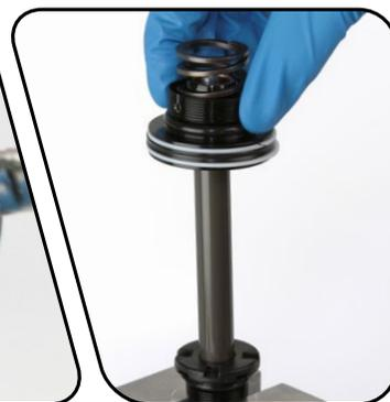
**3** À l'aide d'une clé hexagonale de 2 mm, installez l'unité du piston sur la came. À l'aide d'une clé dynamométrique équipée d'une douille de 10 mm, serrez l'écrou à un couple de 7,9 N.m.
