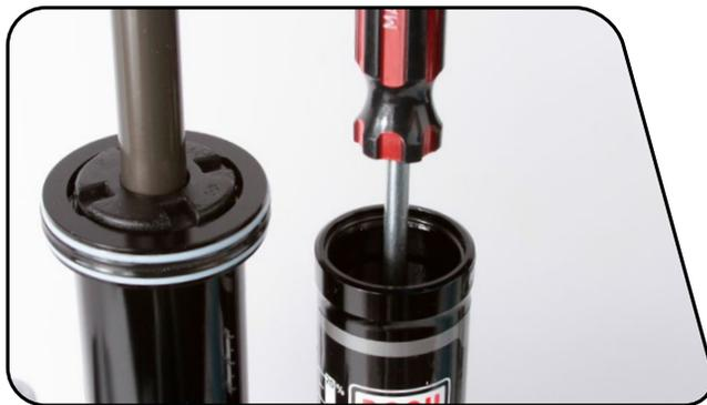
**30** Vissez la pompe équipée de l'adaptateur Vivid sur le bouchon du réservoir du PFI. Tirez sur la pompe pour mettre le bouchon du réservoir contre l'anneau de blocage.
