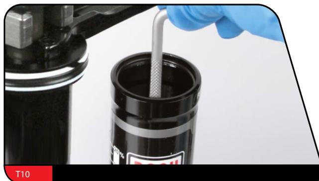
**24** À l'aide d'une clé hexagonale de 3 mm, desserrez le boulon de la butée inférieure du compresseur puis retirez-le de l'unité de la came.
