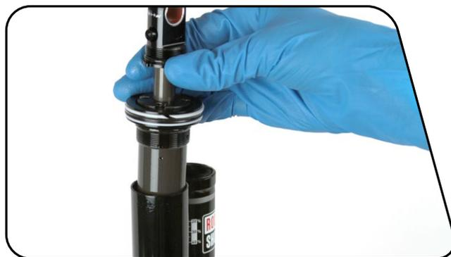
**4** Retirez l'amortisseur de l'étau puis versez le liquide contenu dans le corps de l'amortisseur dans un récipient prévu à cet effet.
