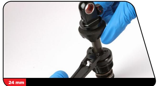
**14** Mettez en place le compresseur Counter Measure™ sur l'unité de la came comme illustré. Écartez les butées supérieure et inférieure l'une de l'autre afin d'installer la clé à ergots dans la tête d'étanchéité. À l'aide d'une clé hexagonale de 3 mm, serrez le boulon de la butée supérieure.
