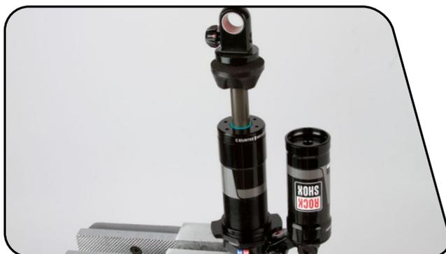
**24** Appliquez une petite quantité de graisse sur le joint d'étanchéité du bouchon du réservoir du PFI. Enfoncez le bouchon du réservoir dans le réservoir du PFI jusqu'à ce que la cannelure de l'anneau de blocage soit visible.
