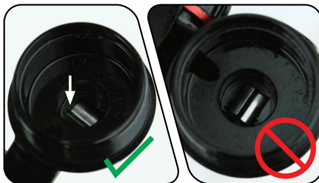
**3** Installez la valve de compression dans l'œillet du corps de l'amortisseur avec l'écrou de la valve de compression tourné vers le haut. Appuyez sur la valve jusqu'à ce qu'elle soit bien en place dans l'œillet du corps de l'amortisseur.
