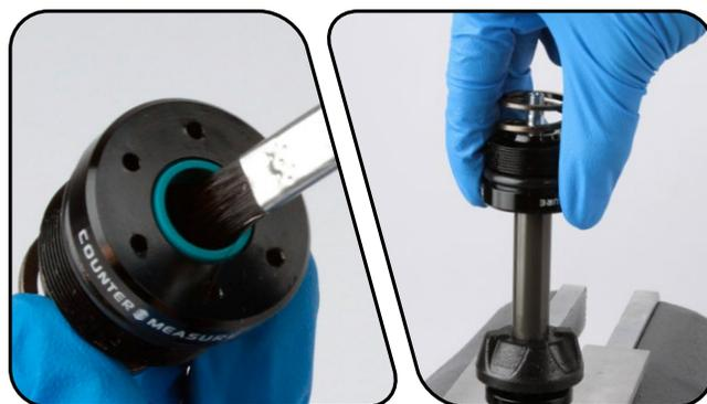
**3** À l'aide de la clé hexagonale de 2 mm, installez l'unité du piston sur la came. À l'aide d'une clé dynamométrique équipée d'une douille de 10 mm, serrez l'écrou en respectant un couple de 7,9 N·m.
