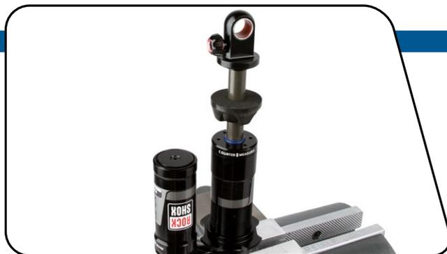
**5** À l'aide d'une clé TORX® T10, déposez le capuchon de l'orifice de remplissage du réservoir du PFI. À l'aide d'une petite clé hexagonale ou d'une pointe, appuyez sur la valve Schrader pour vider toute la pression pneumatique contenue dans le réservoir du PFI.
