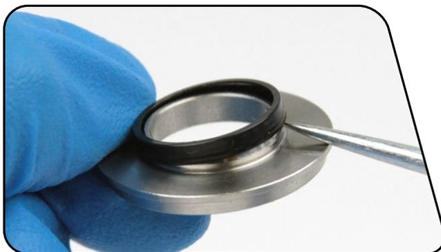
**7** Installez la bague de centrage du tube de l'amortisseur sur l'extrémité du tube de l'amortisseur dépourvue de trous. Maintenez l'amortisseur de sorte que l'ouverture dans le corps de l'amortisseur soit tournée vers le bas. Insérez le tube de l'amortisseur dans le corps de l'amortisseur et faites-le tourner jusqu'à ce que la bague de centrage soit bien en place dans sa cannelure.
