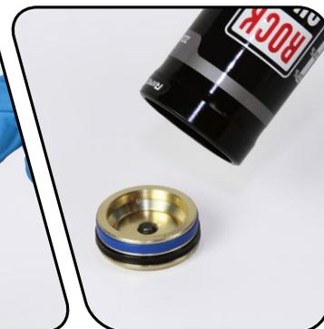
**7** Retirez et remplacez le joint de section carrée du PFI ainsi que la bague de coulissage.
