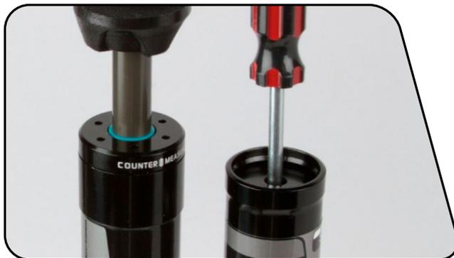
**27** Vissez la pompe équipée de l'adaptateur Vivid sur le bouchon du réservoir du PFI. Tirez sur la pompe pour mettre le bouchon du réservoir contre l'anneau de blocage.
