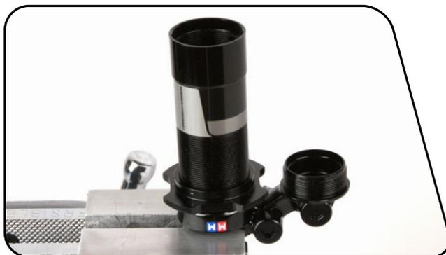
**2** Tournez la molette de réglage de compression dans le sens inverse des aiguilles d'une montre jusqu'à ce que la came métallique de réglage de la compression atteigne son point bas.
