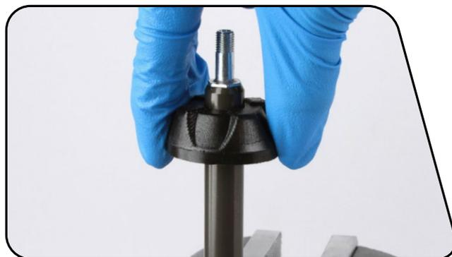
**2** Lubrifiez l'intérieur de la tête d'étanchéité puis installez-la sur l'unité de la came avec le ressort Counter Measure™ tourné vers le haut.
