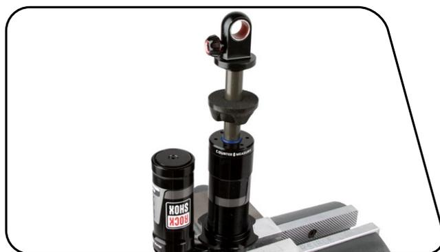
**2** Maintenez la butée de talonnage à distance de la tête d'étanchéité et insérez la clé à ergots RockShox Vivid de 24 mm dans les trous de clavette de la tête d'étanchéité. Tournez la clé à ergots dans le sens inverse des aiguilles d'une montre afin de séparer la tête d'étanchéité et le corps de l'amortisseur.
