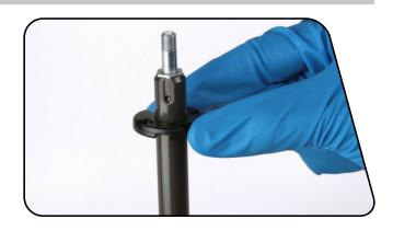
河 润滑密封头内部,并将其装到轴组件上,Counter Measure™弹簧朝上。
