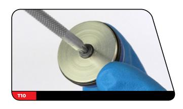
10 卸下并更换IFP排空口螺钉O型圈。
