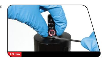
客 将销子螺丝扳手的尖头插入锁环孔内。
