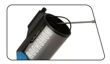
用尖头针从空气罐底部卸下空气罐内套管定中环。 在新定中环带梯度的一侧增加少量润滑脂。将定中环放到空气罐内套管上, 先放带梯度的一侧。
