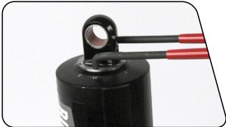
42 将销子螺丝扳手放入锁环,然后通过轴孔眼用虎钳夹住避震器,留出螺丝扳手旋转正好足够的空间。用螺丝扳手将锁环紧固至22.6 N·m。从虎钳上卸下避震器和螺丝扳手。
