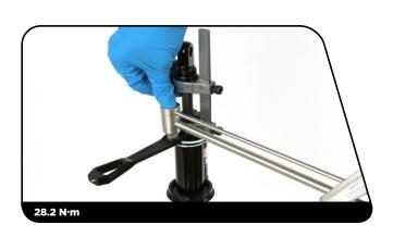
**21** 卸下Counter Measure™压缩器之前,用T10 TORX 扳手卸下IFP排空螺钉。
