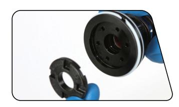
8 卸下并更换两个密封头滑动环和方形密封圈。
