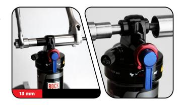
5 从螺纹杆上旋下定位器,并从轴孔眼上卸下工具。
