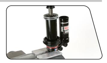
**2** 夹住触底缓冲器从密封头上移开,并将RockShox Vivid 24 mm 螺丝扳手插入密封头的销孔。逆时针转动螺丝扳手,从阻尼器身上卸下密封头。
