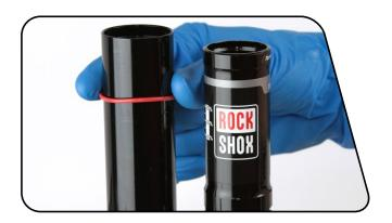
**1** 润滑空气罐束锁圈内侧并开始将其倾斜着装入阻尼器身,带螺纹的一侧朝上。安装束锁圈时用手指推动方形密封圈,以防被夹痛。将束锁圈向下推到阻尼器身上。
