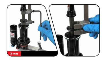
25 从虎钳上取下避震器,并将IFP上可能溢出的油液倒入油盘。用干净碎布擦去IFP储油罐内侧的残余油液。
