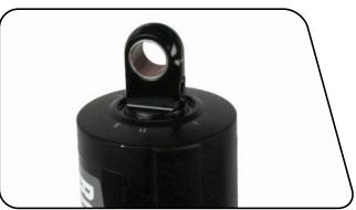
47 在空气罐锁环螺纹和轴孔眼螺纹上喷异丙醇,并用碎布清洁。将红螺纹锁固 凝胶涂在锁环螺纹上。在轴孔眼上安装锁环,然后用销子螺丝扳手继续转动 锁环,直到开始变紧。从虎钳上取下避震器。
