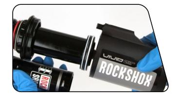
空气罐拆卸/无底圈安装 16
