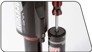
**5** 核实起始冲程回弹旋钮已沿顺时针旋转,直到转不动。用手指握住起始冲程回弹旋钮以防其转动,然后用2.5 mm六角扳手逆时针方向旋转螺栓,从轴孔眼上卸下螺栓和旋钮。
