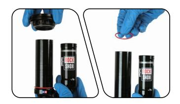
18 阻尼器内部构件拆卸
