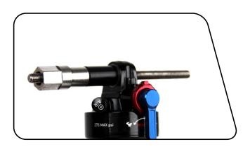
将定位器的开敞大头旋到螺纹杆上,直至抵住孔眼。
