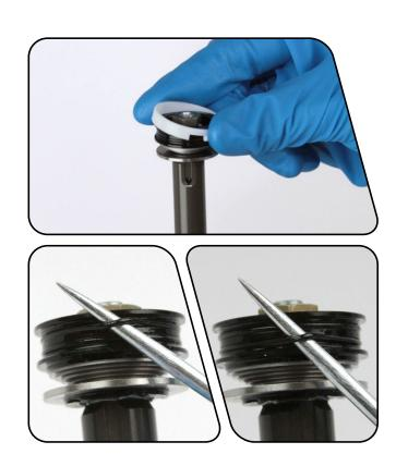
5 用带10 mm套筒的套筒扳手旋下活塞螺帽。将2 mm六角扳手穿过活塞螺帽,并插入活塞螺栓、主活塞和薄叠垫圈。将所有部件保持在一起,从轴上小心卸下活塞组件和六角扳手并放在一边。
