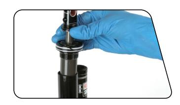
4 从虎钳上取下避震器,并将油液从阻尼器身倒入油盘。 从阻尼器身倾倒油液时,阻尼管定中环将脱出。 在阻尼管和定中环上喷异丙醇,并用碎布清洁。
