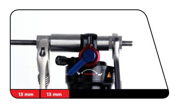
5 从螺纹杆上旋下定位器。 卸下设备上的端头垫片和轴衬销子。 将固定机件放在一旁,直至完成避震器保养。 在器身孔眼上重复上述操作。
