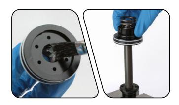
3 用2 mm六角扳手将活塞组件安装到轴上。用带10 mm套筒的扭矩扳手拧紧螺母,扭矩7.9 N·m。
