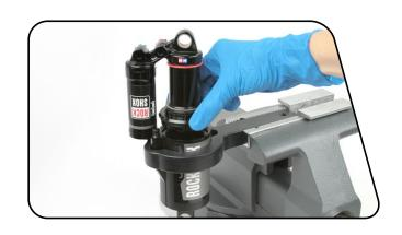
在阻尼器身上缠上电工胶布。用中轴工具顺时针转动空气罐束锁圈,并紧固至28.2 N·m。从RockShox Vivid Air空气罐扳手上取下避震器。 更换电工胶布。
