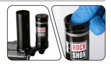
**万** 用尖头针从IFP储油罐中卸下固定夹。
