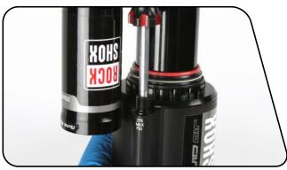
用TIO TORX®扳手卸下IFP储油罐注液盖。用小六角扳手或尖头针压下美式 嘴阀,释放储油罐中的所有气压。
