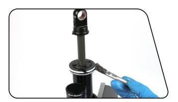
37 对齐轴孔眼,使之与器身孔眼平行,同时使起始行程回弹旋钮的位置位于您为避震器所记录的该旋钮相对于IFP储油罐的位置。
