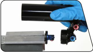
**12** 将2 mm六角扳手插入压缩阀的螺母侧,以推出压缩针。
