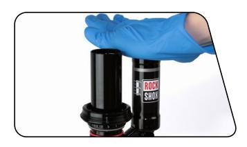
73 将IFP装入储油罐,平边朝上。用拇指均匀而缓慢地将IFP推入储油罐,刚好过储油罐中的梯度。
