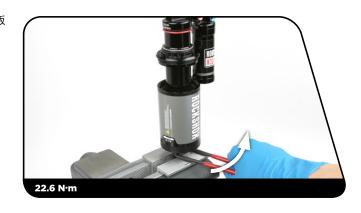
相房钳夹住RockShox Vivid Air空气罐扳手,并将空气罐放入其中。将空气罐束锁圈向下推到阻尼器身上,并将其旋入空气罐。
