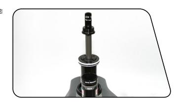
**38** 回想您记录的空气罐顶部数字。这将有助您将空气罐与起始行程回弹旋钮适当对齐。
