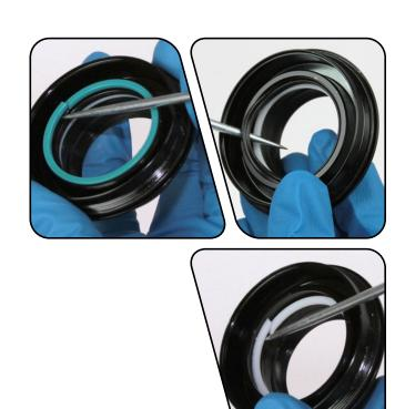
5 用尖头针卸下并更换空气罐束锁圈外侧螺纹下方的O型圈。在空气罐束锁圈上喷异丙醇,并用碎布擦净。
