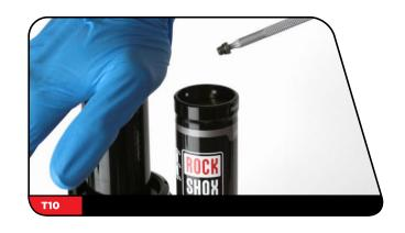
75 将更多的油液倒入阻尼器身,直至油液与螺纹顶部保持水平。
