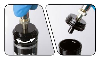
4. 卸下并更换IFP储油罐盖O型圈。
