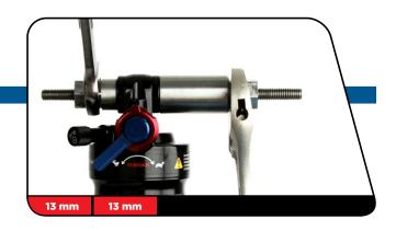
4 将螺纹杆和插针重新插入轴孔眼。 将定位器的开敞大头旋到螺纹杆上,直至抵住轴孔眼。 用13 mm扳手将插针旋到螺纹杆上,直到抵住端头垫片。
