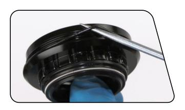
**6** 将新的白色备用环、方形密封圈和蓝色备用环 (带梯度一侧朝上) 装入空气罐束锁圈带螺纹的一侧。
