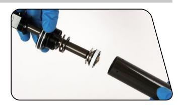
**2** 卸下并更换位于轴孔眼螺纹底部的轴孔眼O型圈。
