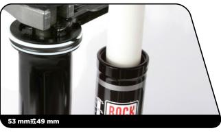
用T10 TORX® 扳手将排空螺钉装入排空口并旋紧,直到IFP 开始转动。
