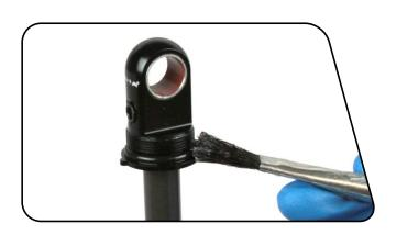
在空气罐束锁圈方形密封圈和滑动环上涂抹足量Parker® O-Lube。
