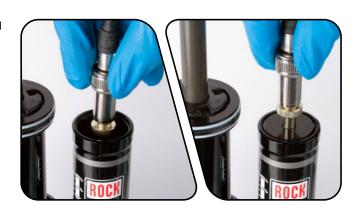
31 利用打气筒将IFP储油罐加压至200 psi。
