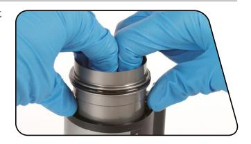
**2** 卸下并更换空气罐内套管O型圈。
