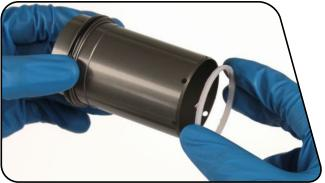
**5** 将空气罐内套管装入空气罐,先装定中环一侧。将空气罐内套管在空气罐内居中,并用手压空气罐,直到定中环卡入空气罐底部的槽中。
