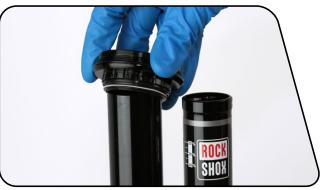
8 卸下并更换阻尼管定中环上的抗压垫片。
