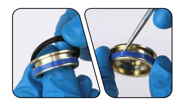
8 卸下并更换IFP储油罐O型圈和位于IFP储油罐内侧螺纹上的凸肩垫圈。
