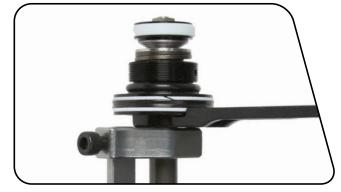
**18** 将轴组件以45度角插入阻尼器身,同时将活塞旋入阻尼器身内的油液中。 在避震器下放一块碎布,接住阻尼器身溢出的油液。
