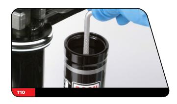
7/1 用3 mm六角扳手旋松压缩器的下止动螺栓,并从轴组件中卸下。
