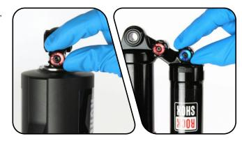
2 记录与减震器上起始冲程回弹旋钮一致的空气罐计时数,以协助重新组装空气罐。请同时记下空气罐和起始冲程回弹旋钮与IFP储油罐的相对位置。
