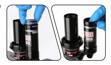
14 保持用手盖住阻尼器身,并用T10 TORX\*扳手将排空螺钉装入排空口并旋紧,直到IFP开始转动。
