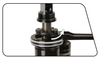
17 阻尼器内部构件拆卸
