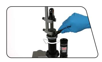
用插入螺丝扳手槽内的扭矩扳手将密封头紧固至28.2 N·m。 扭矩扳手应按90度角装到螺丝扳手中,以获得准确的扭矩读数。
