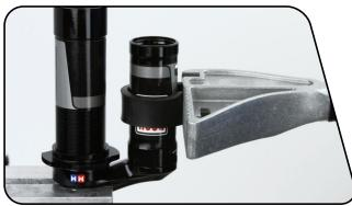
■ **万** 用1.5 mm六角扳手将压缩针推入压缩阀。这将确保避震器排空路径。
