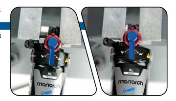
6 继续按压孔眼轴衬,直到它卡入轴孔眼。 从虎钳上卸下避震器,并对另一个轴衬和孔眼重复安装过程。
