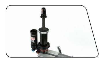
27 在IFP储油罐盖O型圈上涂少量润滑脂。将储油罐盖压入IFP储油罐,直到可以看到固定环槽。
