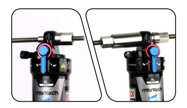
**2** 用虎钳夹住定位器,或用13 mm扳手夹稳。 用另一把13 mm扳手将插针旋到螺纹杆上,直到插针将孔眼轴衬推出孔眼。
