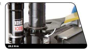
75 用2.5 mm六角扳手顺时针旋转螺栓,以安装起始冲程回弹旋钮。
