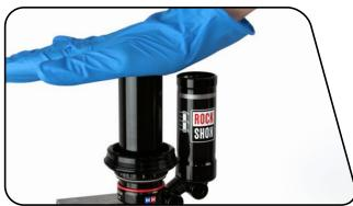
12 一旦来自阻尼器身的大多数油液移入了储油罐,用手掌反复向下轻击阻尼器身顶部,使油液流回阻尼器身。这将有助于从系统中清除气泡。 请勿让阻尼器身或IFP储油罐中的油位变低,这将把空气逼入系统。 继续这一轻击阻尼器身和储油罐的过程,直到两侧不再有气泡冒出。
