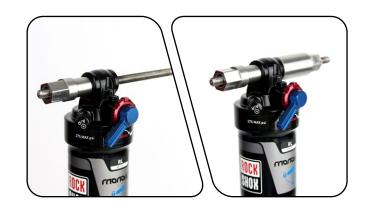
用虎钳夹住定位器,或13 mm开口扳手或可调节扳手夹稳。 用另一把13 mm扳手将插针旋到螺纹杆上,直到抵住端头垫片。 从螺纹杆上旋下插针,并卸下该侧的端头垫片。
