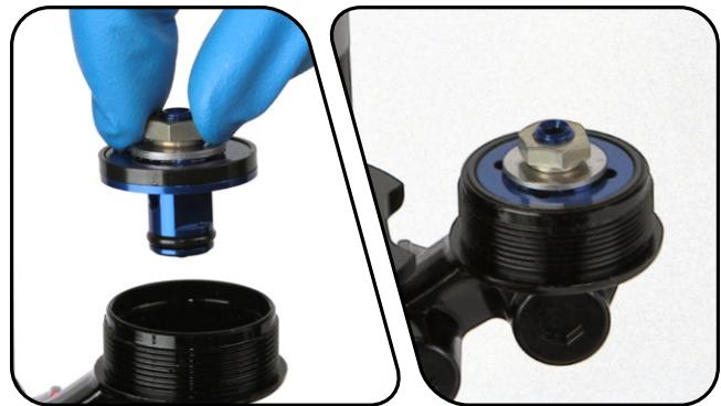
用手将 IFP 储油罐旋到器身孔眼上。用 31 mm 扁平板手或带式扳手将 IFP 储油罐紧固至 11.3 N·m。IFP 储油罐与器身孔眼之间能看到细缝。这属于正常现象。
