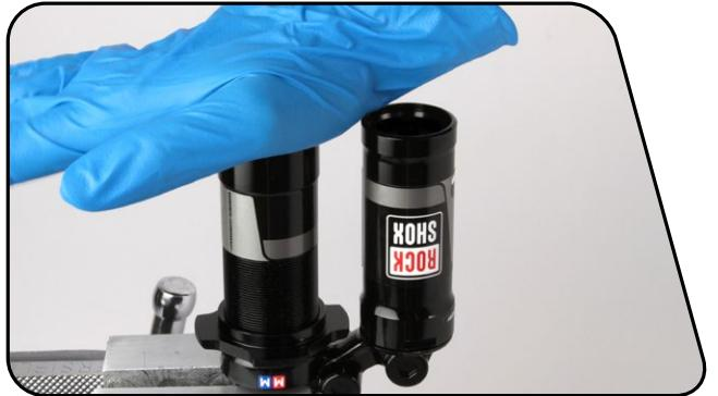
一旦来自阻尼器身的大多数油液移入了储油罐，用手掌反复向下轻击阻尼器身顶部，使油液流回阻尼器身。这将有助于从系统中清除气泡。
