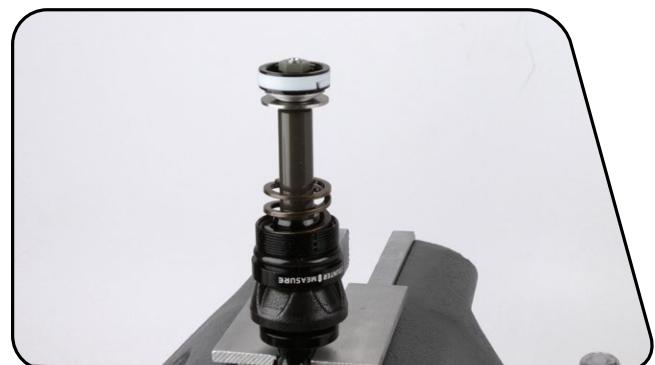
卸下并更换活塞滑动环和位于滑动环下的两个 O 型圈。
