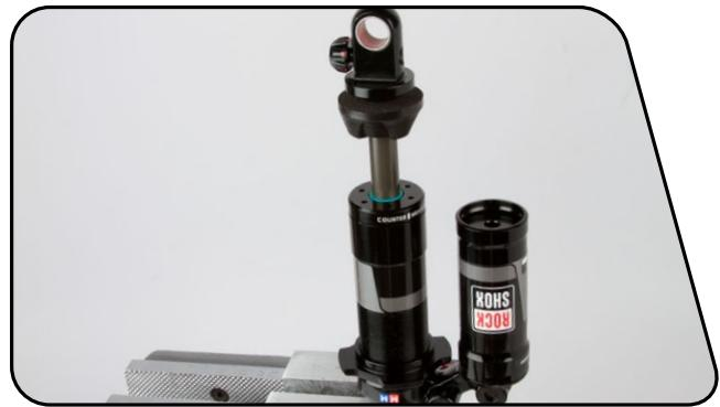
在 IFP 储油罐盖 O 型圈上涂少量润滑脂。将储油罐盖压入 IFP 储油罐，直到可以看到固定环槽。
