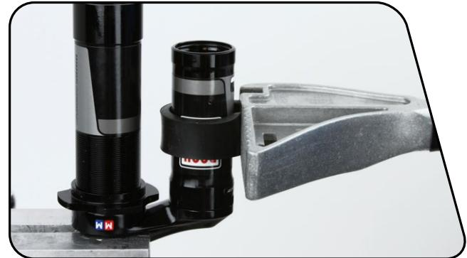
用 1.5 mm 六角扳手将压缩针推入压缩阀。这将确保减震器排空路径。
