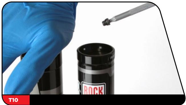
将更多的油液倒入阻尼器身，直至油液与螺纹顶部保持水平。
