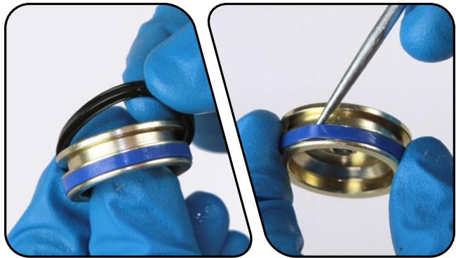
卸下并更换 IFP 储油罐 O 型圈和位于 IFP 储油罐内侧螺纹上的凸肩垫圈。
