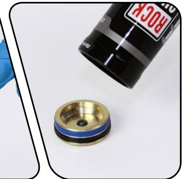
卸下并更换 IFP 方形密封圈和滑圈。
