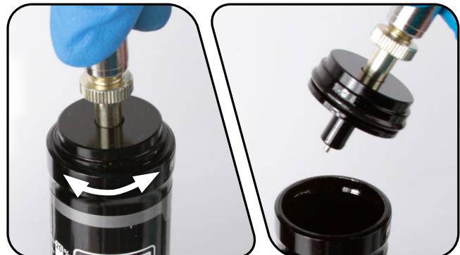
卸下并更换 IFP 储油罐盖 O 型环。
