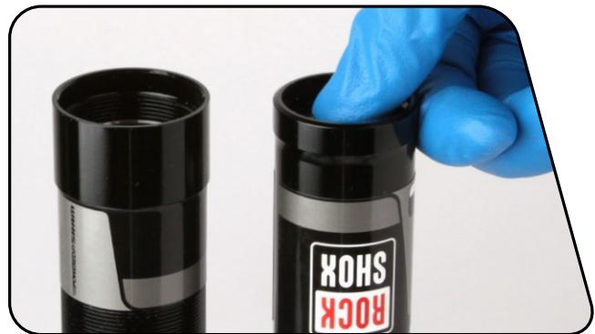
保持用手盖住阻尼器身，并用 T10 TORX® 扳手将排空螺钉装入排空口并旋紧，直到 IFP 开始转动。
