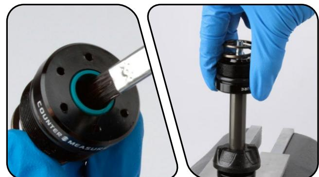
用 2 mm 六角扳手将活塞组件安装到轴上。用带 10 mm 套筒的扭矩扳手拧紧螺母，扭矩 7.9 N·m。
