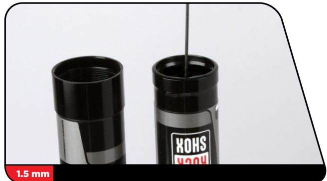
卸下并更换阻尼管定中环上的抗压垫片。
