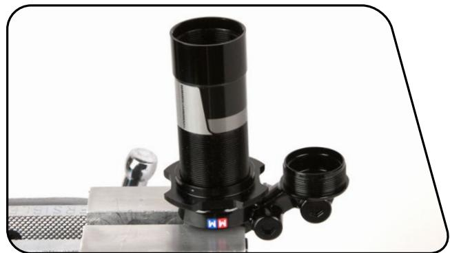
逆时针转动压缩旋钮，直到金属压缩调节凸轮达到最低点。
