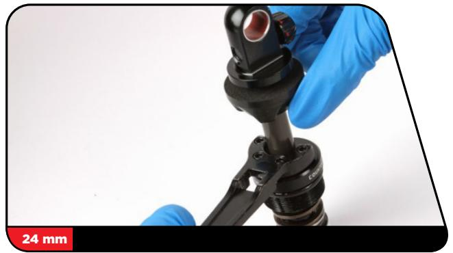
如图所示将 Counter Measure™ 压缩器放在轴组件上。将上下止动夹相互分离，以将螺丝扳手夹入密封头。用 3 mm 六角扳手紧固上止动螺栓。
