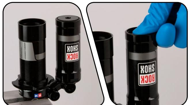
用尖头针从 IFP 储油罐中卸下固定夹。
