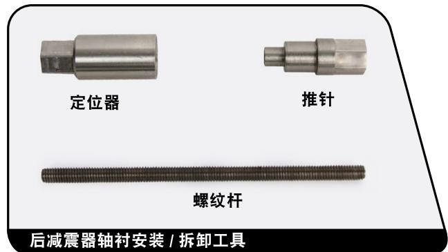
将推销的小头旋到螺纹杆上, 直到螺纹杆与推销的六角形头齐平或略微突出。
