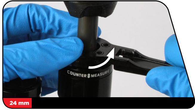
用手从阻尼器身上卸下轴组件。拆卸轴组件时阻尼管应脱出。
