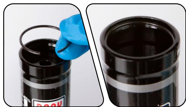
用美式嘴阀门工具将新的美式嘴阀门装入 IFP 储油罐盖。
