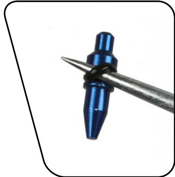
如图所示，用手指将压缩针推入压缩阀。
