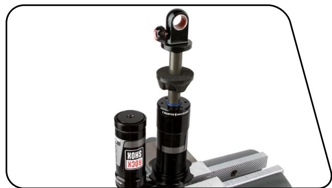
夹住触底缓冲器从密封头上移开，并将 RockShox Vivid 24 mm 螺丝扳手插入密封头的销孔。逆时针转动螺丝扳手，从阻尼器身上卸下密封头。
