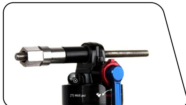
将定位器的开敞大头旋到螺纹杆上，直至抵住孔眼。
