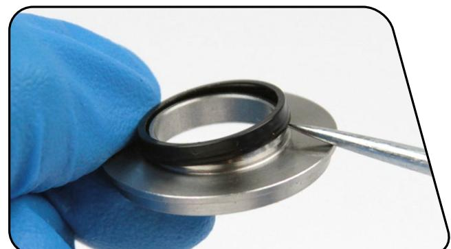
将阻尼管定中环放到阻尼管没有孔的一头。握住减震器，使阻尼器身开口朝下。将阻尼管插入阻尼器身并旋转，直至定中环卡到槽内。
