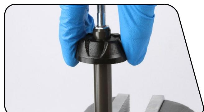
用尖头针卸下并更换主轴密封圈、位于密封头内部的 O 型圈以及位于密封头外部的 O 型圈。
