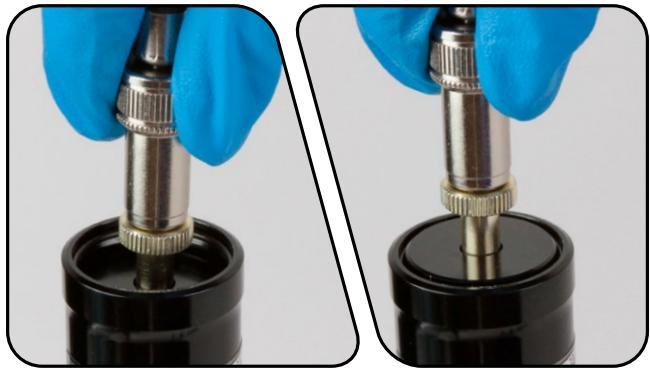
利用泵将 IFP 储油罐加压至 200 psi。
