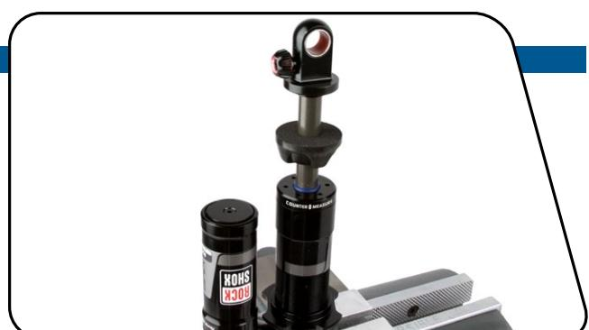
用 T10 TORX® 扳手卸下 IFP 储油罐注液盖。用小六角扳手或尖头针压下，释放 IFP 储油罐中的所有气压。
