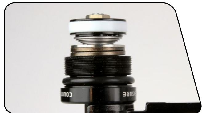
将轴组件以 45 度角插入阻尼器身，同时将活塞旋入阻尼器身中的油液。
