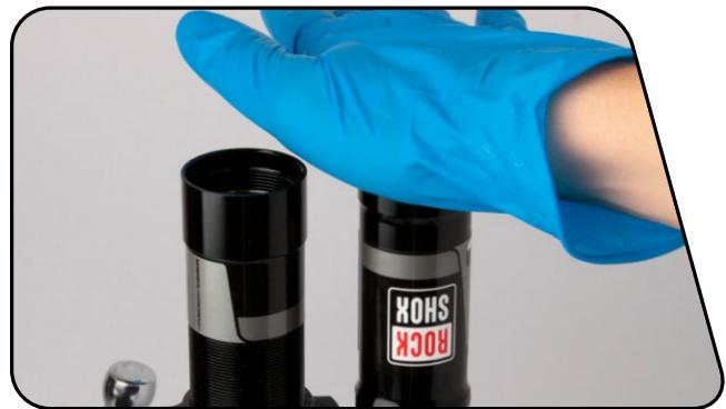
将 IFP 装入储油罐，平边朝上。用拇指均匀而缓慢地将 IFP 推入储油罐，刚好过储油罐中的梯度。
