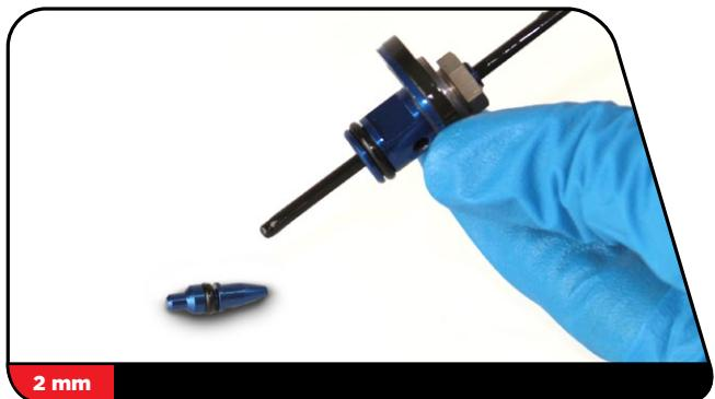
卸下并更换压缩阀 O 型圈和抗压垫片以及压缩针 O 型圈。
