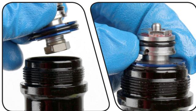
**14** Schrauben Sie den IFP-Ausgleichsbehälter von Hand auf das Auge. Ziehen Sie den IFP-Ausgleichsbehälter mit einem Drehmomentschlüssel mit einem 27-mm-Hahnenfuß-Steckschlüsselaufsatz mit 8,4 N•m an.
