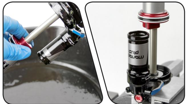
**20** Bauen Sie mit einem Schrader-Ventilwerkzeug ein neues Schrader-Ventil in die Kappe des IFP-Ausgleichsbehälters ein.
