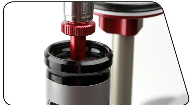
**24** Pumpen Sie den IFP-Ausgleichsbehälter mit der Pumpe auf 17 bar auf. Nachdem Sie den Ausgleichsbehälter wieder mit Druck beaufschlagt haben, entfernen Sie den Monarch-Luftventiladapter vom Lufteinfüllstutzen, **bevor** Sie ihn von der Dämpferpumpe abnehmen.
