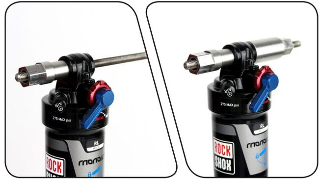
**3** Spannen Sie den Aufnehmer in einem Schraubstock ein oder fixieren Sie ihn mit einem 13-mm-Maulschlüssel bzw. einem verstellbaren Schlüssel.
