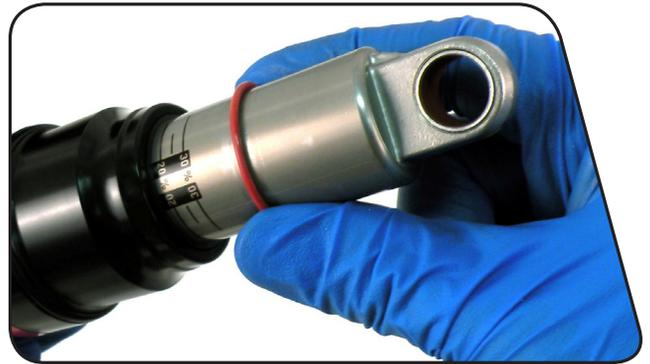
**8** Bringen Sie die Dämpfer-Befestigungsteile wieder an (siehe Abschnitt [Wartung der Befestigungsteile und Buchsen](#)).
