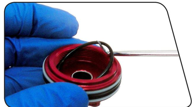
**9** Entfernen und ersetzen Sie die untere Anschlagsscheibe und den unteren O-Ring von der Dämpferführungsstange.
