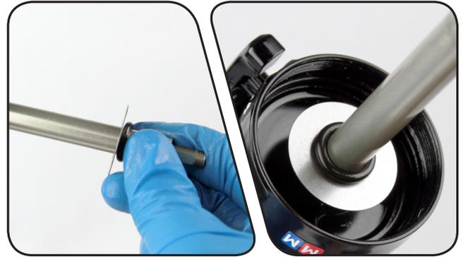
**10** Entfernen und ersetzen Sie mit den Fingern den O-Ring im Inneren des Gewindes des Führungsstangenauge.
