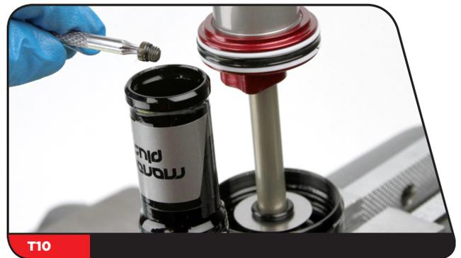
**19** Entnehmen Sie den Dämpfer aus dem Schraubstock. Gießen Sie das Öl aus dem IFP-Ausgleichsbehälter. Sprühen Sie Isopropyl-Alkohol in den IFP-Ausgleichsbehälter und säubern Sie ihn mit einem Lappen.
