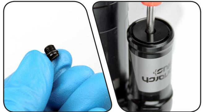
**26** Sprühen Sie den Dämpfer mit Isopropyl-Alkohol ein und säubern Sie ihn mit einem Lappen.
