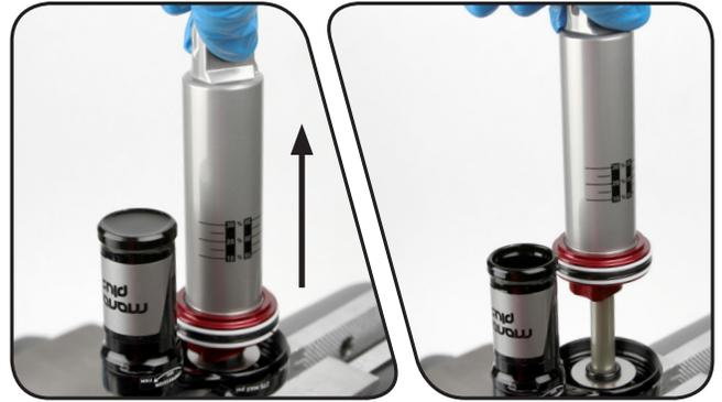
**18** Bringen Sie mit einem T10 TORX®-Schlüssel die IFP-Entlüftungsschraube am IFP an. Die Entlüftungsschraube muss vollständig in das Öl eingetaucht sein.
