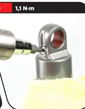
**15** Entfernen Sie mit einem T10 TORX®-Schlüssel die IFP-Entlüftungsschraube vom IFP.
