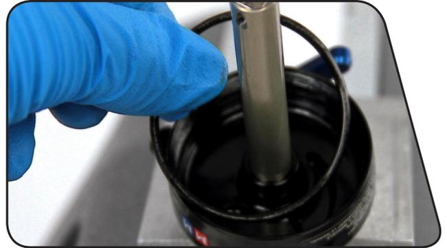
**11** Montieren Sie die Dichtkopf/Luftkolben-Baugruppe wieder auf der Dämpferführungsstange.
