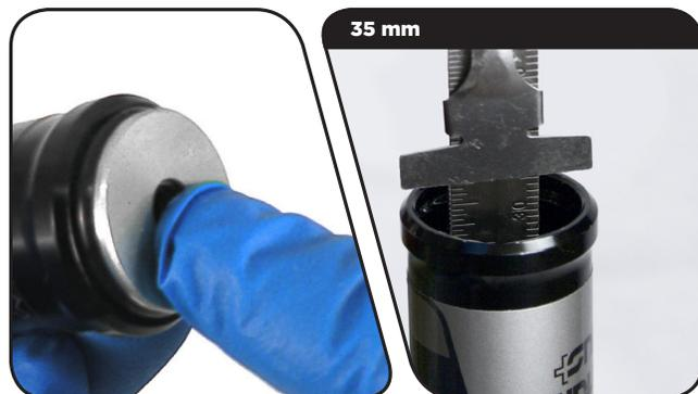
**13** Nur Monarch Plus™ RC3: Bauen Sie die Druckstufen-Baugruppe mit der Mutter zuerst in die mit einem Gewinde versehene Seite des IFP-Ausgleichsbehälters ein. Drücken Sie die Druckstufen-Baugruppe bis zum Anschlag in den Ausgleichsbehälter.
