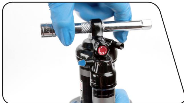
**5** Fixieren Sie die Luftkammer mit einem Bandschlüssel, damit sie sich nicht drehen kann. Ziehen Sie die Luftkammer mit einem Drehmomentschlüssel mit einem 13-mm-Hahnenfußaufsatz mit 4,5 N•m an.
