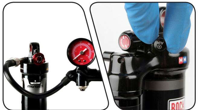
**11 Nur DebonAir™-Luftkammern:** Beaufschlagen Sie mit einer Dämpferpumpe den Dämpfer mit dem gewünschten Luftdruck. Nachdem Sie Luft zum Dämpfer hinzugefügt haben, muss der Druck zwischen den Dämpferkammern ausgeglichen werden.
