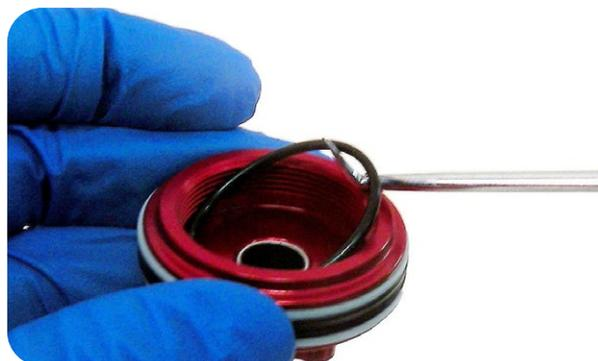
**9** 从阻尼轴上卸下并更换触底垫片和 O 型圈。
