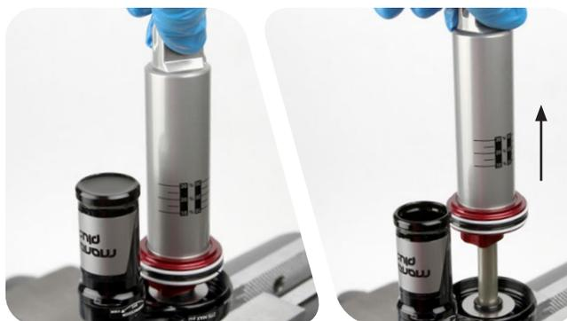
**10** 用 T10 TORX 扳手将 IFP 排空螺钉装入 IFP。排空螺钉应浸入油液中。
