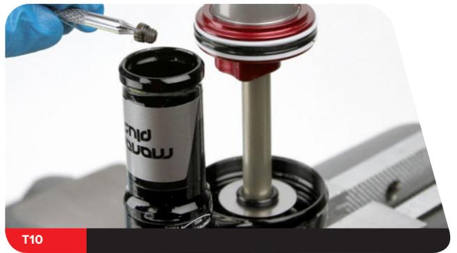
**19** 从虎钳上取下减震器。从 IFP 储油罐中倒出油液。向 IFP 储油罐内喷异丙醇，并用碎布擦净。
