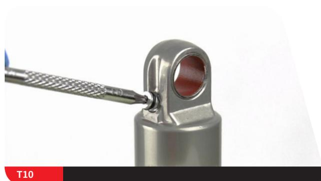
**12** 用一块干净的碎布包住阻尼器身。缓缓向下推阻尼器身，将气泡从阻尼器身孔眼上的排空口排出。
