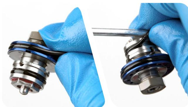
**8** 用手指拆下并更换孔眼螺纹内的 O 型圈。
