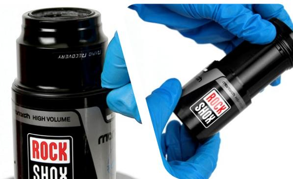
**10** 大容量空气罐：用手指取下并更换大容量套筒 O 型圈。
