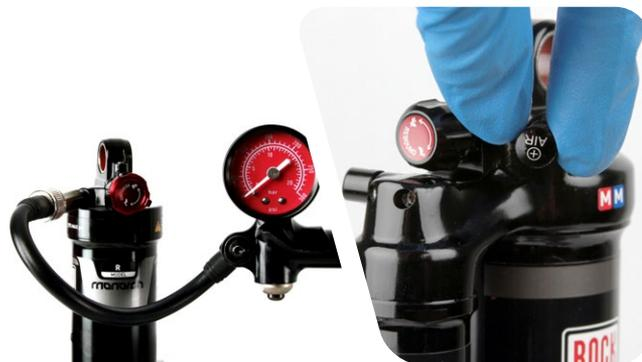
**11** 仅适用于 DebonAir 空气罐：用减震器打气筒将减震器加压至理想气压值。向减震器压入空气后，需平衡一下减震器气室之间的压力。记录打气筒上的空气压力值，然后将其从减震器上旋下。慢慢地用力向下压车座或坐在车座上，向减震器施加压力，直到听到“嘶嘶”声。这种声音表明减震器气室之间在转移空气。记录空气压力，然后将打气筒从减震器上旋下。重复此操作，直到达到理想的垂度。
