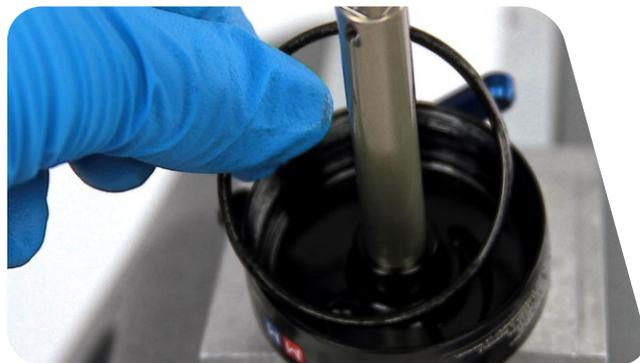
**11** 将密封头 / 空气活塞安装到阻尼轴上。
