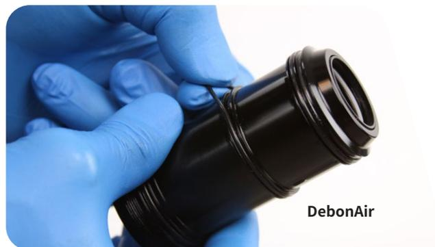
**11** 大容量空气罐：在套筒内表面涂抹少量减震器专用润滑脂。这能防止在套筒滑过 O 型圈时 O 型圈转动。
