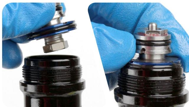
**14** 用手将 IFP 储油罐旋到孔眼上。用带 27 mm 爪形套筒的扭矩扳手拧紧 IFP 储油罐，扭矩 8.4 N·m。
