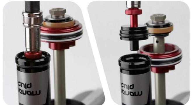
**4** 卸下并更换 IFP 储油罐盖 O 型圈。
