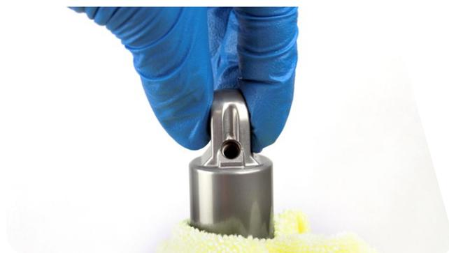
**13** 如果阻尼器身完全推下了，却仍有气泡冒出，则重新安装阻尼器排空螺钉，卸下 IFP 排空螺钉，然后重复第 9-12 步，直到不再有气泡冒出。
