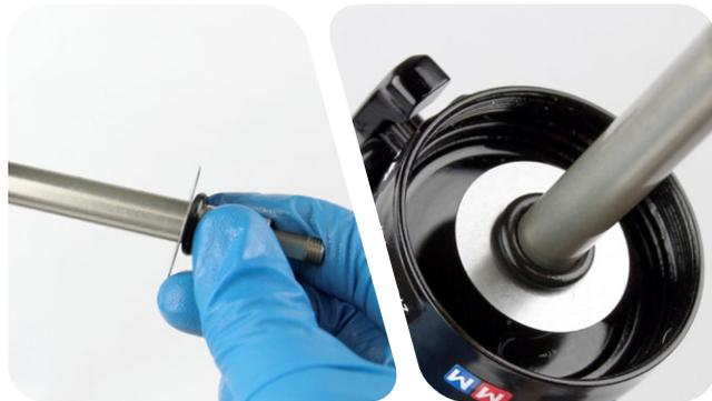
**10** 用手指卸下并更换轴孔眼螺纹内的 O 型圈。
