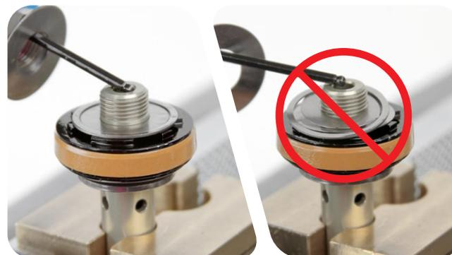
**15** 在螺母的螺纹上涂抹 242 Blue Loctite，然后将螺母旋到阻尼轴上。用带 12 mm 套筒的扭矩扳手将主活塞螺母拧紧至 4.5 N·m。
