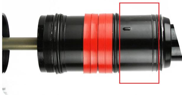
**4** 将 5 英寸套筒延长杆插入轴孔眼。向下推轴孔眼，同时向上拉空气罐，直到空气罐螺纹与孔眼螺纹啮合。
