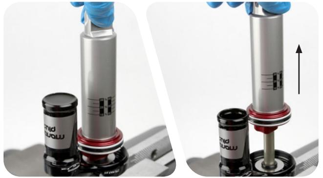
**18** 用 T10 TORX 扳手将 IFP 排空螺钉装入 IFP。排空螺钉应浸入油液中。
