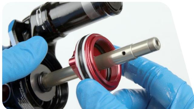
**12** 用手指取下并更换密封头 / 空气活塞密封圈和滑环。
