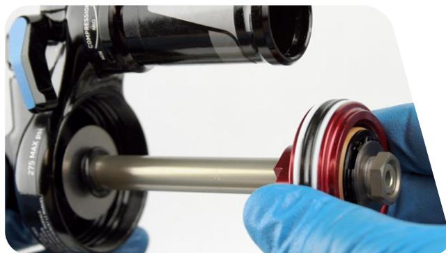
**3** 用 RockShox 后减震器虎钳块将阻尼轴夹入虎钳。
