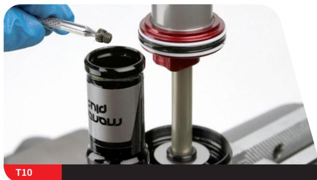
**16** 将更多的 RockShox 3wt / Maxima PLUSH 3wt 避震油倒入 IFP 储油罐，直至油液与储油罐顶部平齐。
