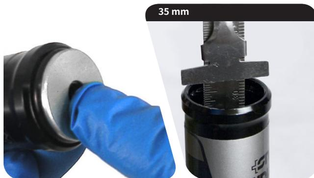
**13** 仅适用于 Monarch Plus RC3：将压缩组件装入 IFP 储油罐螺纹侧，压缩组件的螺母侧朝内。将压缩组件推入储油罐，直到推不动。检查压缩杆是否仍在解锁（最小）位置，压缩针是否仍朝上。
