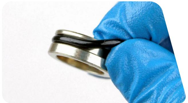
**12** 将 IFP 装入 IFP 储油罐内，平坦一侧朝外。用公制卡尺或米尺将 IFP 推入储油罐，推入深度为 35 mm。
