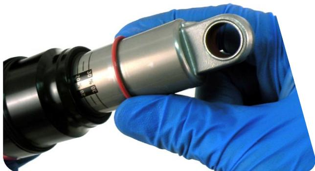
**8** 重新安装减震器固定机件（参见[固定机件和轴衬保养](#)一节）。
