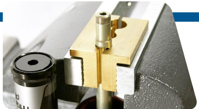
**14** 将第 5 步中卸下的主活塞组件安装到阻尼轴上。为确保三角填隙片居中，请用手指挤压填隙片，并使填隙片叠在主活塞上居中。
