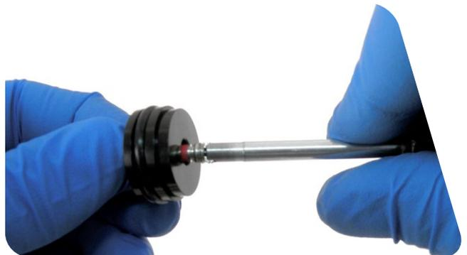
**21** 在 IFP 储油罐盖 O 型圈上涂少量润滑脂。将 IFP 储油罐盖推入 IFP 储油罐，直到可以看到固定环槽。
