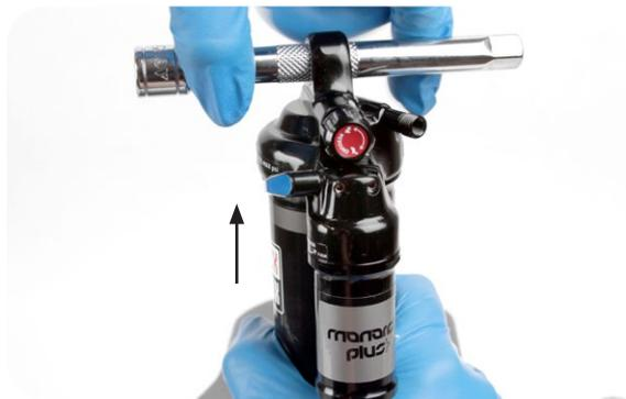
**5** 用带式扳手稳住空气罐，以防其转动。用带 13 mm 爪形套筒的扭矩扳手拧紧空气罐，扭矩 10 N·m。
