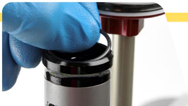
**23** 将打气筒和 Monarch 气阀接合器工具旋入 IFP 储油罐盖。向上拉动打气筒，使储油罐盖抵住固定环。
