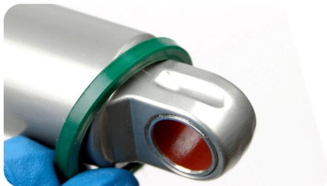
**3** 用 17 mm 开口扳手从阻尼器身上旋松密封头 / 空气活塞组件。用手卸下组件。
