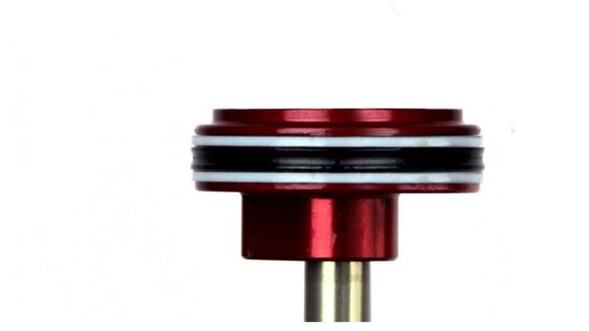
**13** 用 RockShox 后减震器虎钳块将阻尼轴夹入虎钳。
