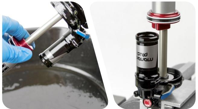
**20** 用美式嘴阀工具将新的美式嘴阀装入 IFP 储油罐盖。
