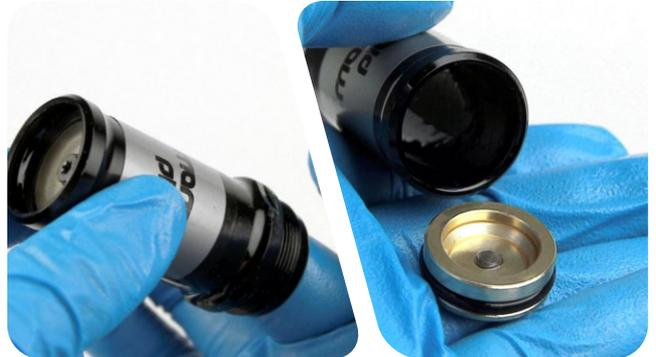
**10** 用 T10 TORX 扳手卸下 IFP 排空螺钉。更换 IFP 排空螺钉上的 O 型圈。
