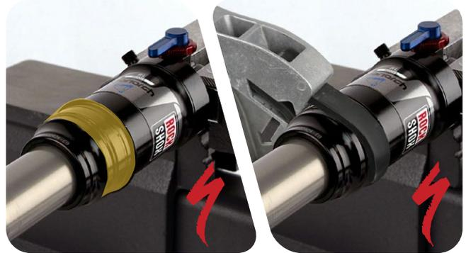
**DebonAir 空气罐：**卸下套筒固定 O 型圈和外套筒。清洁空气罐套筒。
