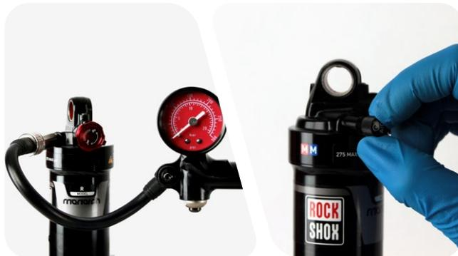
**12** 仅适用于 DebonAir 空气罐：用减震器打气筒将减震器加压至理想气压值。向减震器压入空气后，需平衡一下减震器气室之间的压力。记录打气筒上的气压值，然后将打气筒从减震器上旋下。慢慢地用力向下压车座或坐在车座上，向减震器施加压力，直到听到“嘶嘶”声。这种声音表明减震器气室之间在转移空气。记录气压值，然后将打气筒从减震器上旋下。重复此操作，直到达到理想的垂度。
