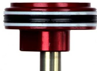
**14** 将密封头 / 空气活塞安装到阻尼轴上。
