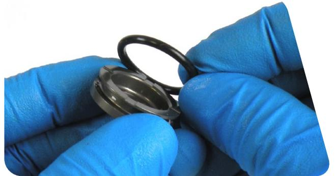
**4** 将 IFP 装入阻尼器身，带梯级的一侧朝外。用公制卡尺或米尺将 IFP 推到以下表格规定的深度。
