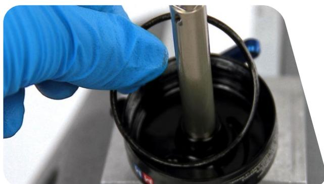
**13** 用手指取下并更换密封头 / 空气活塞密封圈和滑环。
