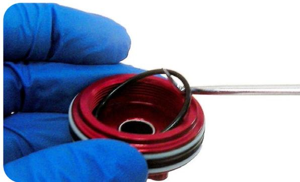
**10** 用 1.5 mm 六角扳手将压缩球从密封头背面推出，穿过排空口。
