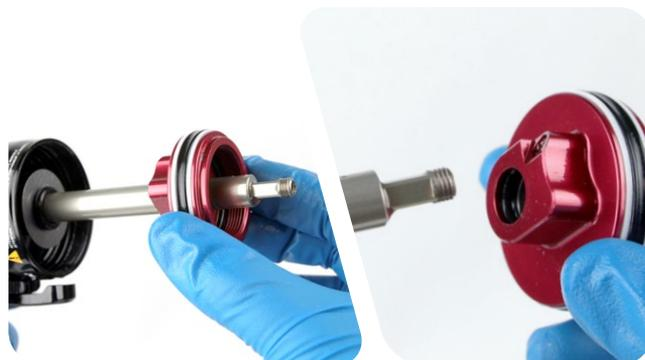
**8** 用尖头针卸下并更换位于内部密封盖内的内部密封 O 型圈。
