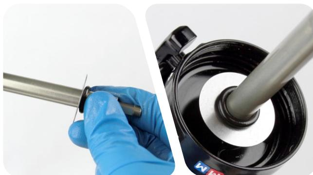
**12** 用手指卸下并更换轴孔眼螺纹内的 O 型圈。
