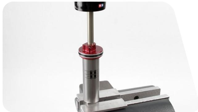
**5** 用 2 mm 六角扳手卸下位于密封头 / 空气活塞内的排空螺钉。
