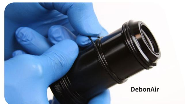
**11** 大容量空气罐：在套筒内表面涂少量 RockShox 动态密封润滑脂。这能防止在套筒滑过 O 型圈时 O 型圈转动。
