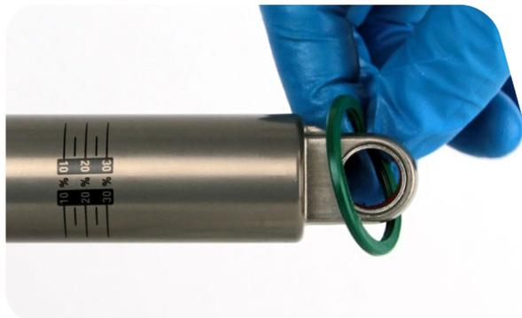
**2** 用美式嘴阀工具卸下阻尼器充气口盖。用小六角扳手或尖头针压下美式嘴阀，释放阻尼器中的所有气压。
