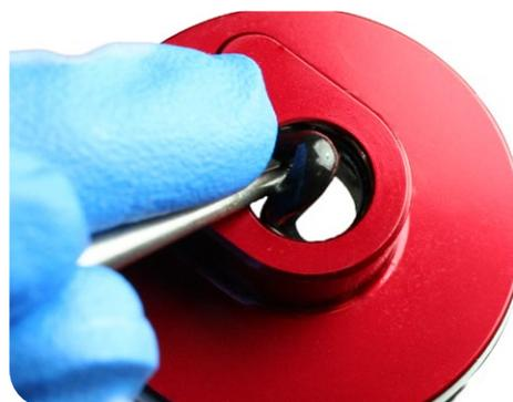
**9** 用尖头针卸下并更换位于密封头 / 空气活塞内螺纹底部的内部 O 型圈。
