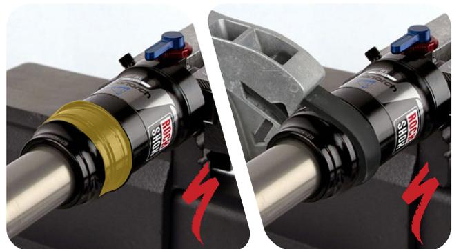
**DebonAir-Luftkammern:** Entfernen Sie den Rückhalte-O-Ring der Hülse und die äußere Hülse. Legen Sie die Luftkammerhülse beiseite. Platzieren Sie einen Bandschlüssel auf der Luftkammer. Drehen Sie den Bandschlüssel gegen den Uhrzeigersinn, um die Luftkammer zu entfernen.
