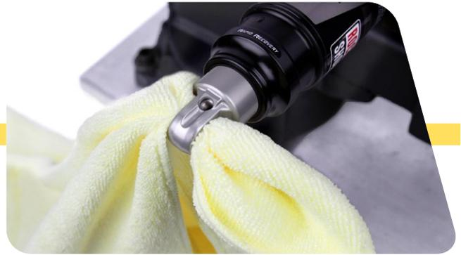
**5** Verwenden Sie einen Bandschlüssel, um die Luftkammer auszubauen. Wickeln Sie das Band um den Teil der Luftkammer, der am weitesten vom Führungsstangenauge entfernt ist. Drehen Sie den Schlüssel gegen den Uhrzeigersinn, um die Luftkammer abzuschrauben.
