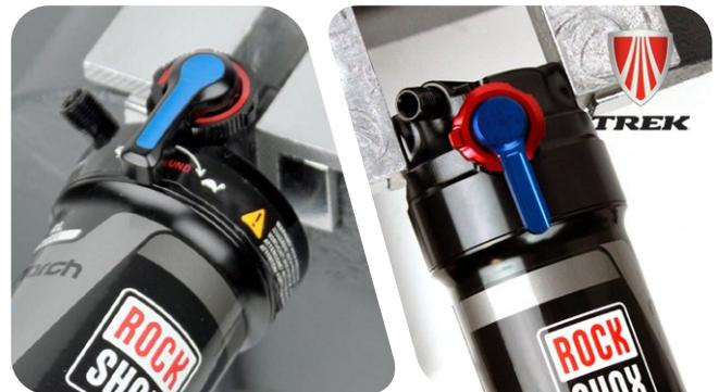
**4** Wenn der Dämpfer zusammengedrückt ist, sodass nur ein kleiner Teil des Dämpferkörpers sichtbar ist, steht die Luftkammer noch unter Druck.
