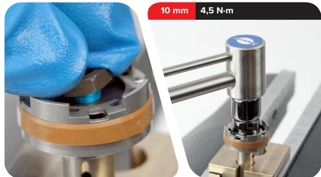
**17** Installieren Sie die Feder und die Scheibe der oberen Verschlusskappe auf der Druckstange. Halten Sie die Druckstange senkrecht, sodass die Feder in der Nut in der oberen Verschlusskappe sitzt.
