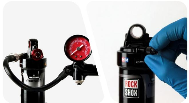
**12** **Nur DebonAir-Luftkammern:** Beaufschlagen Sie mit einer Dämpferpumpe den Dämpfer mit dem gewünschten Luftdruck. Nachdem Sie Luft zum Dämpfer hinzugefügt haben, muss der Druck zwischen den Dämpferkammern ausgeglichen werden.
