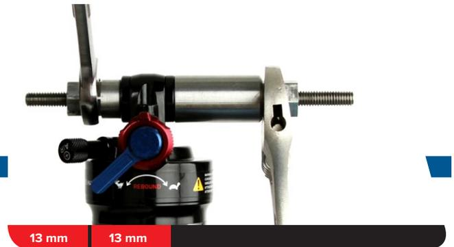
**4** Stecken Sie die Gewindestange und den Druckstift wieder durch das Führungsstangenauge.
