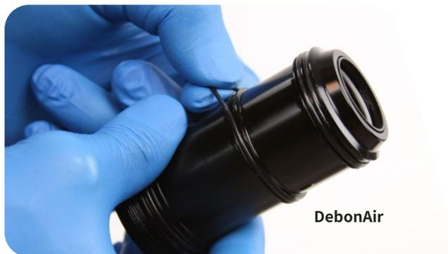
**11** 大容量空气罐：在套筒内表面涂少量 RockShox 动态密封润滑脂。这能防止在套筒滑到 O 型圈上时 O 型圈转动。
