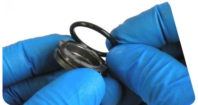
**4** 将 IFP 装入阻尼器身，带梯级的一侧朝外。用公制卡尺或米尺将 IFP 推到以下表格注明的深度。
