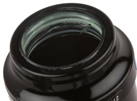
**9** 大容量空气罐：卸下大容量套筒上的固定 O 型圈。紧紧握住大容量套筒，并将其从空气罐上滑下。
