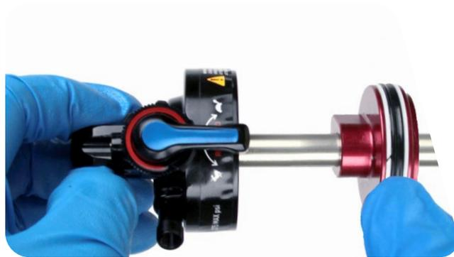
**3** 用带 10 mm 轴夹的虎钳块将阻尼轴夹入虎钳。
