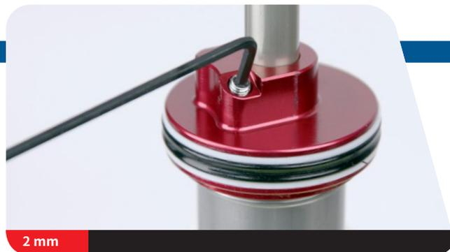
**8** **Monarch RT3**：用带 Monarch 气阀接合器的减震器打气筒将阻尼器身加压至 350 psi。
