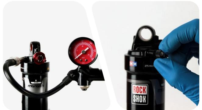
**12** 仅适用于 DebonAir 空气罐：用减震器打气筒将减震器加压至理想气压值。向减震器压入空气后，需平衡一下减震器气室之间的压力。记录打气筒上的气压值，然后将其从减震器上旋下。慢慢地用力向下压车座或坐在车座上，向减震器施加压力，直到听到“嘶嘶”声。这种声音表明减震器气室之间在转移空气。记录气压值，然后将其从减震器上旋下。重复此操作，直到达到理想的垂度。
