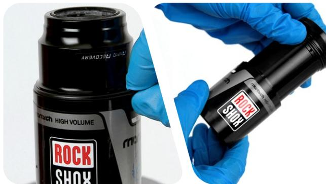
**10** 大容量空气罐：用手指取下并更换大容量套筒 O 型圈。
