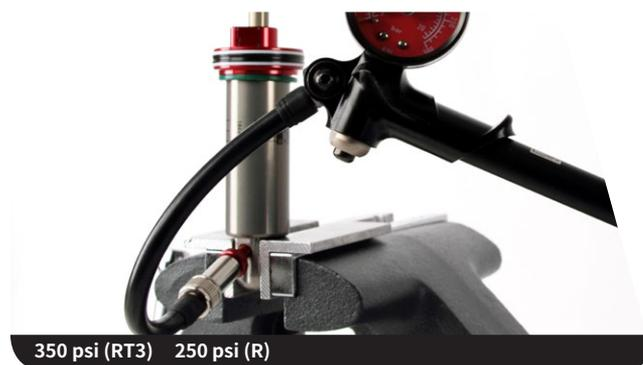
**9** 用美式嘴阀工具安装阻尼器空气 / 氮气充气口盖。
