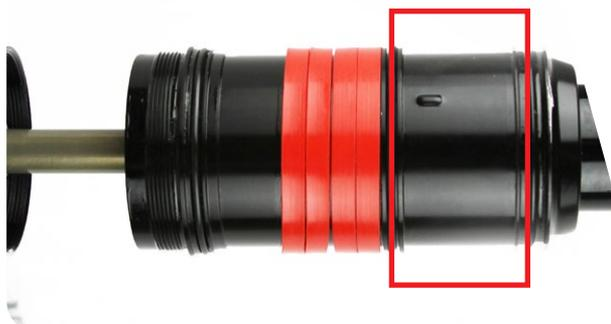
**4** 将空气罐按压到阻尼器上，然后将其旋到轴孔眼上，直到用手旋不动。
