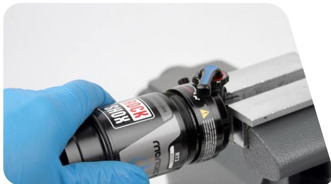
**5** 从虎钳上取下减震器。翻转减震器，用虎钳夹住阻尼器身孔眼。
