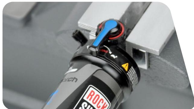
**4** 如果减震器缩拢，能看到极少量的阻尼器身，则说明空气罐中仍有气压。在阻尼器身孔眼中插入一块碎布。这将防止拆解时空气罐从减震器上强力弹出。
