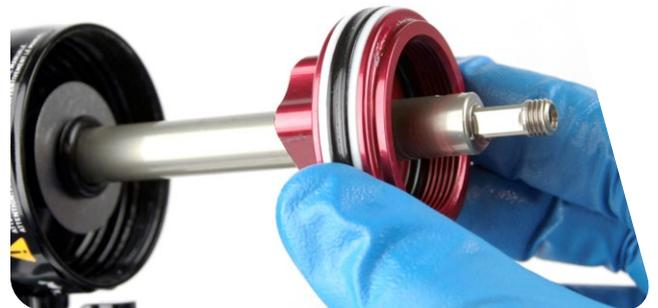
**14** 用带 10 mm 轴夹的虎钳块将阻尼轴夹入虎钳。
