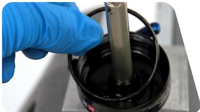
**12** 用手指取下并更换密封头 / 空气活塞密封圈和滑环。
