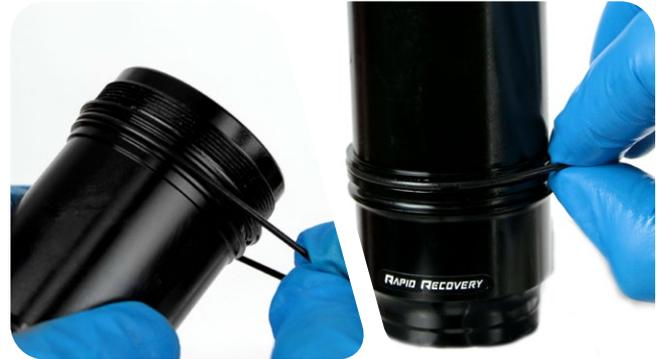
**DebonAir-Luftkammern:** Entfernen und ersetzen Sie die drei O-Ringe mit den Fingern.
