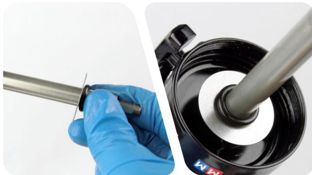
**11** Entfernen und ersetzen Sie mit den Fingern den O-Ring im Inneren des Gewindes des Führungsstangenauges.
