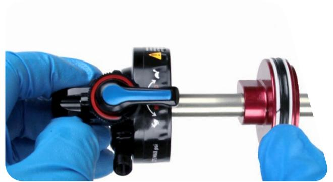
**3** Spannen Sie die Führungsstange mit einem Schraubstockblock und der 10-mm-Führungsstangenklemme in einen Schraubstock ein.
