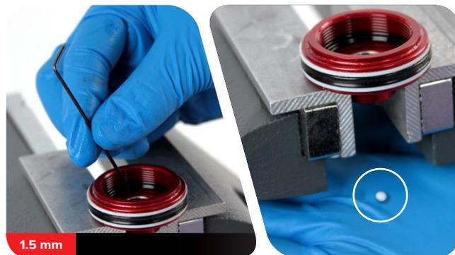
**10** Entfernen und ersetzen Sie die untere Anschlagsscheibe und den unteren O-Ring von der Dämpferführungsstange.
