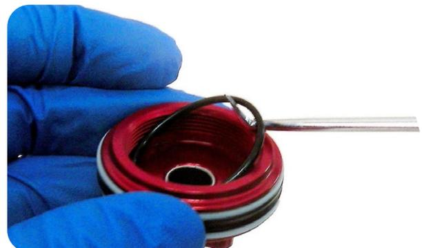
**9** Schieben Sie mit einem 1,5-mm-Inbusschlüssel die Druckkugel durch die Entlüftungsöffnung aus der Rückseite des Dichtkopfes heraus.
