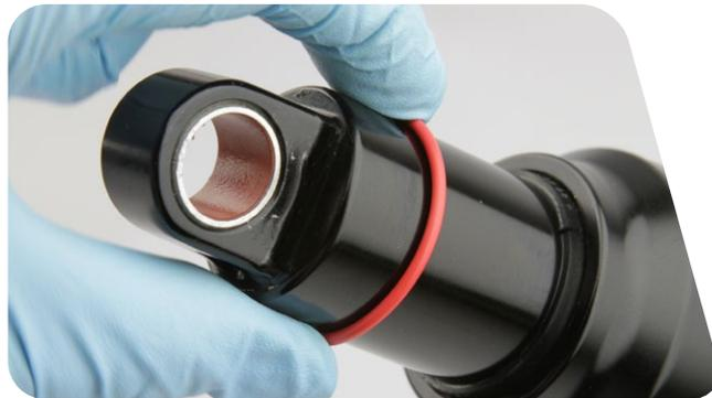
5 在阻尼器身孔眼中插入一块碎布，防止空气罐从减震器上强力弹出。
