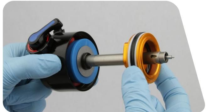
8 用尖头针穿透并卸下位于内部密封盖内的内部密封 O 型圈。
