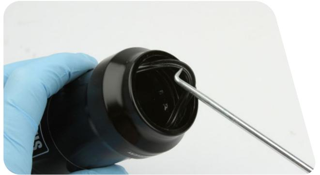
**5** 在空气罐内喷异丙醇，并用碎布擦净。取下一只手套，用手指检查空气罐内外侧，看是否有刮痕、缺口或其他表面变形现象。如果空气罐有刮痕或已损坏，则请更换。
