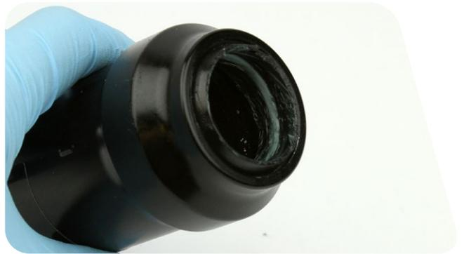
**10** 用手指取下密封头 / 空气活塞密封圈和滑环。
