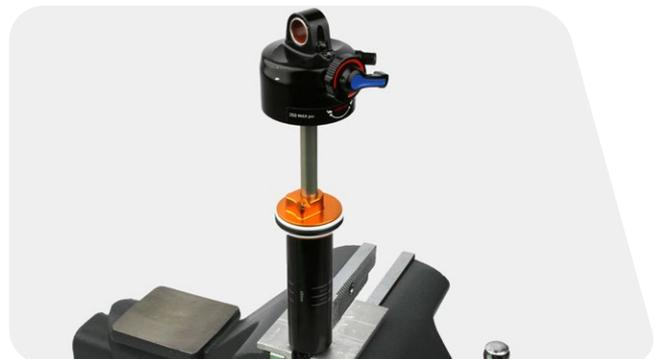
4 用 2 mm 六角扳手卸下位于密封头 / 空气活塞的排空螺钉。
