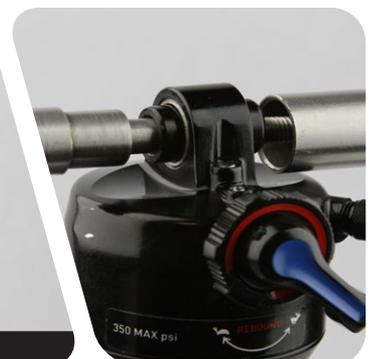
**5** 在轴衬销子的两端分别压上一枚端头垫片，大直径一侧朝内。
