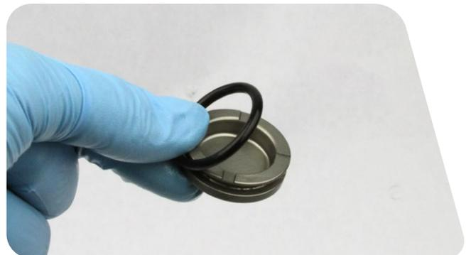
**4** 将 IFP 装入阻尼器身，带梯级的一侧朝外。使用公制卡尺或米尺将 IFP 推入阻尼器身，推入深度为 75 mm。
