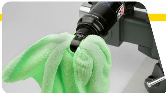
**6** 用带式扳手卸下空气罐。用带式扳手包住空气罐离轴孔眼最远的部分。逆时针转动扳手，旋开空气罐。
