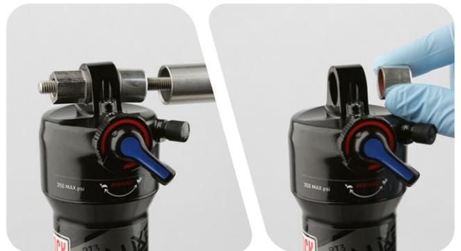
Avant de procéder à l'entretien de votre amortisseur arrière, vous devez d'abord le démonter du cadre du vélo en suivant les instructions du fabricant. Une fois l'amortisseur démonté, déposez les éléments de fixation avant de procéder à toute opération d'entretien (reportez-vous au chapitre intitulé [Entretien des éléments de fixation et des bagues](#)).
