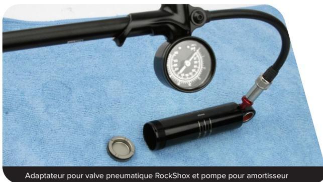
Adaptateur pour valve pneumatique RockShox et pompe pour amortisseur
