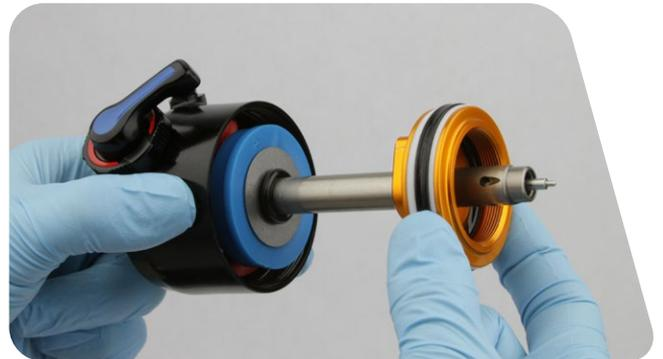
**8** À l'aide d'une pointe, piquez et retirez le joint torique interne situé dans la cannelure pour joint interne.
