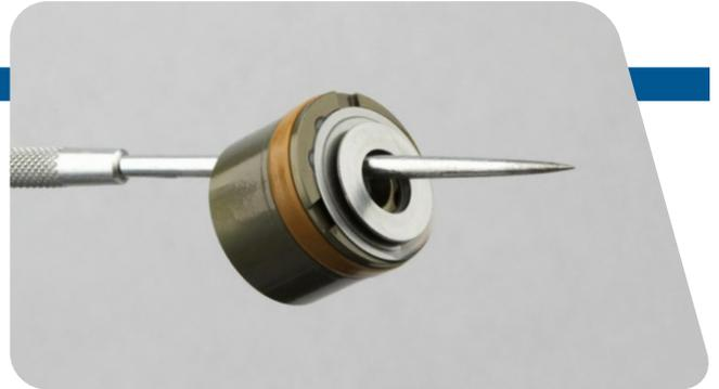
**7** Retirez l'unité tête d'étanchéité/piston pneumatique hors de la came de l'amortisseur.
