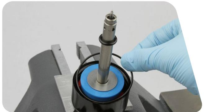
**12** Mettez en place l'unité tête d'étanchéité/piston pneumatique sur la came de l'amortisseur.
