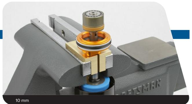
**3** À l'aide de l'outil pour piston RE:aktiv, retirez le piston dégressif hors du piston principal.
