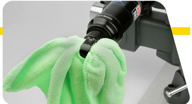
**6** À l'aide d'une clé à sangle, retirez la cartouche pneumatique. Serrez la sangle autour de la partie de la cartouche pneumatique située à l'opposé de l'œillet de la came. Faites tourner la clé dans le sens inverse des aiguilles d'une montre pour dévisser la cartouche pneumatique.
