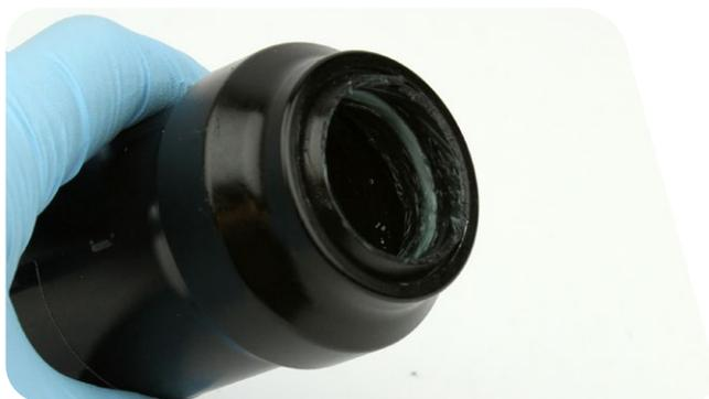
**10** Avec les doigts, retirez le joint et les anneaux de coulissage de l'unité tête d'étanchéité/piston pneumatique.
