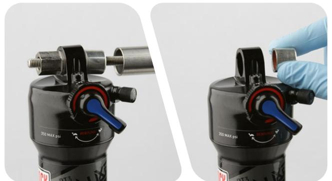
Bevor Sie Ihren Hinterbau-Dämpfer warten, bauen Sie ihn gemäß den Anweisungen des Fahrradherstellers aus dem Fahrradrahmen aus. Nachdem Sie den Dämpfer auf dem Fahrrad ausgebaut haben, entfernen Sie die Befestigungsteile, bevor Sie zur Wartung übergehen (siehe Abschnitt [Wartung der Befestigungsteile und Buchsen](#)).
