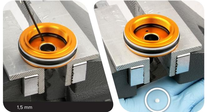
**11** Entfernen Sie mit den Fingern den O-Ring im Inneren des Gewindes des Führungsstangenauges.
