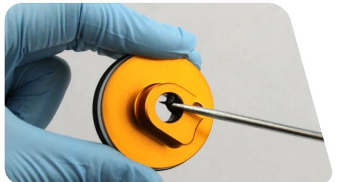
**9** Entfernen Sie mit einem Dorn den inneren O-Ring an der Gewindebasis in der Dichtkopf/Luftkolben-Baugruppe.
