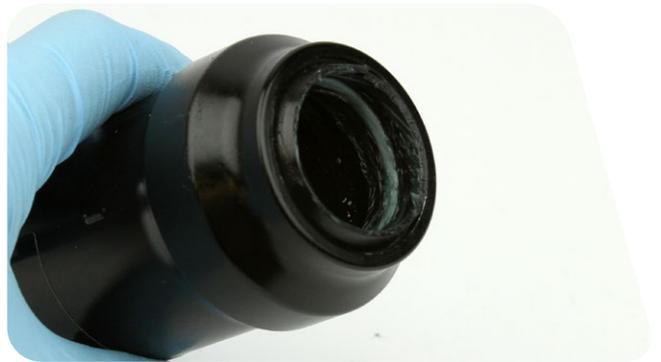
**10** Entfernen Sie die Dichtung der Dichtkopf/Luftkolben-Baugruppe und die Gleitrings mit den Fingern.
