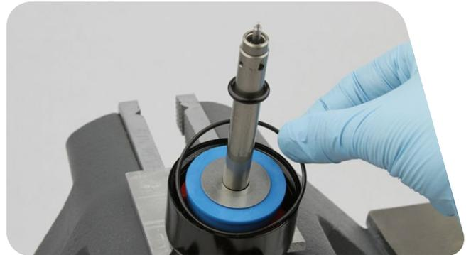
**12** Montieren Sie die Dichtkopf/Luftkolben-Baugruppe wieder auf der Dämpferführungsstange.
