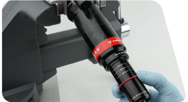
7 À l'aide d'une clé à sangle, retirez le réservoir pneumatique. Enroulez la sangle autour de la partie du réservoir pneumatique où il n'y a pas de décalcomanies. Faites tourner la clé dans le sens inverse des aiguilles d'une montre pour dévisser le réservoir pneumatique.
