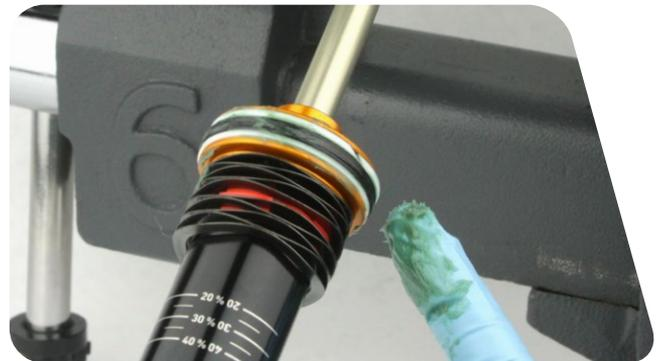
**2** Injectez la moitié de la dosette (1 mL) de Maxima Maxum4 Extra 15w50 ou Maxima PLUSH Dynamic Suspension Lube Light dans le réservoir pneumatique avant d'installer le réservoir pneumatique sur l'amortisseur. Appuyez fermement sur le réservoir pneumatique vers l'œillet jusqu'à ce que l'unité tête d'étanchéité/piston pneumatique soit insérée dans le réservoir pneumatique.
