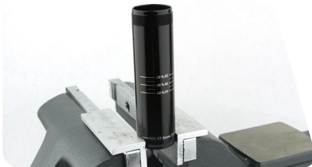
**9** Insérez le bouchon de purge Thru Shaft dans la base du corps de l'amortisseur de manière à ce que le joint maintienne le raccord en place.
