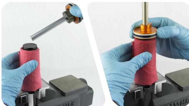
**12** Serrez l'unité tête d'étanchéité/piston pneumatique.
