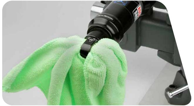
**Fixation à roulements :** si l'unité de l'œillet à roulements a été préalablement retirée, réinstallez-la temporairement sur le corps de la cartouche d'amortissement. Enroulez un chiffon autour de l'unité de l'œillet à roulements pour la protéger.
