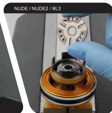
Alignez la goupille de guidage sur le piston avec l'orifice de guidage dans l'outil pour piston de verrouillage RCT/NUDE. Commencez par visser le piston de verrouillage à la main, puis utilisez une clé plate de 24 mm sur l'outil pour piston de verrouillage RCT/NUDE pour serrer le piston de verrouillage à un couple de 4,5 N·m
