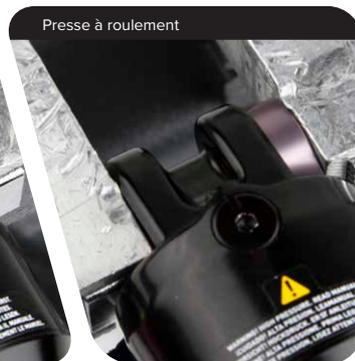
**3** Retirez l'amortisseur de l'étau. Les roulements doivent être enfoncés d'environ 1 mm par rapport au bord externe de leur emplacement. Remettez en place les protections anti-poussière avant de remonter l'amortisseur sur le vélo.
