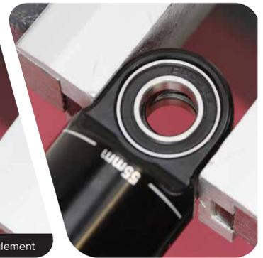
Poinçon de petit diamètre pour roulement
