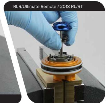
**4** **RLR/Ultimate Remote / RL/RT** : À l'aide d'une pointe, retirez les joints toriques de la tige de compression.
