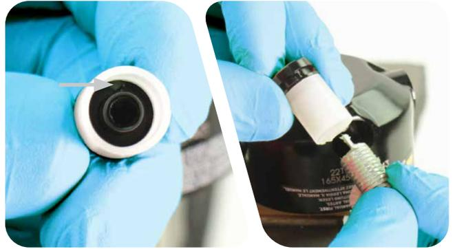
La pointe du ressort doit être visible au travers du pré-tendeur lorsque l'installation est correcte.
