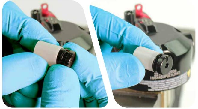
5 Installez le ressort dans la bague et insérez la pointe du ressort dans l'orifice du pré-tendeur du ressort.
