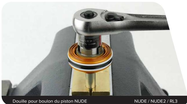
**RLR/Ultimate Remote / 2018 RL/RT / R** : à l'aide d'une clé à douille de 10 mm, retirez l'écrou du piston.
