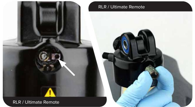
Mettez une bague neuve en place dans l'œillet avec son côté à épaulement tourné vers l'extérieur de l'œillet.
