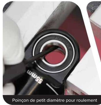
Poinçon de petit diamètre pour roulement
