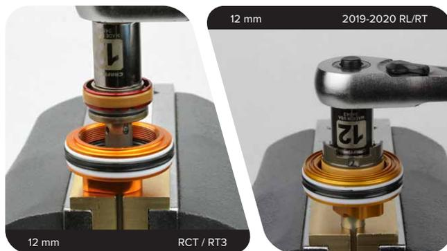
**NUDE / NUDE2 / SCOTT RL3** : à l'aide de la douille pour boulon du piston NUDE, desserrez le boulon du piston.
