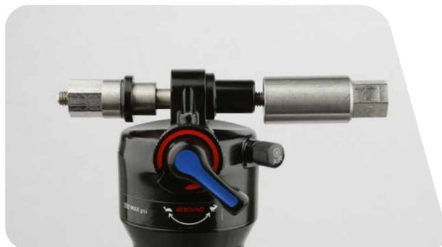
**4** Si la clavette de la bague ne sort pas facilement, réinsérez la tige filetée et la clavette de pression à travers l'œillet de la came.
