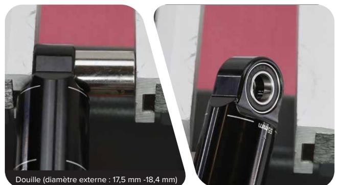
**6** Retirez l'amortisseur serré dans l'étau. Le roulement doit se trouver à environ 1 mm sous le bord externe de l'emplacement du roulement.
