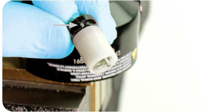
Insérez le pré-tendeur, la bague et le ressort dans l'œillet et insérez la pointe du ressort dans l'orifice prévu à cet effet dans l'œillet.
