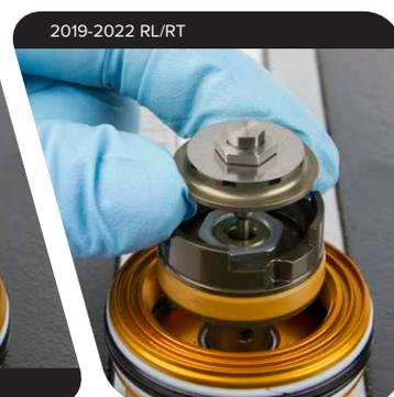
**RLR/Ultimate Remote / 2018 RL/RT** : installez le ressort du capuchon supérieur ainsi que la rondelle du capuchon supérieur sur la tige de compression. Maintenez la tige de compression en position verticale afin d'insérer le ressort dans la cannelure interne au capuchon supérieur.
