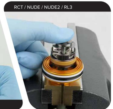
**2019-2022 RL/RT:** Tragen Sie ein wenig Fett auf die Spitze der neuen Druckstange auf. Bauen Sie die Druckstange und die obere Verschlusskappe in die Hauptkolben-Baugruppe ein.
