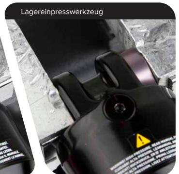
**3** Entnehmen Sie den Dämpfer aus dem Schraubstock. Die Lager sollten ca. 1 mm unter dem äußeren Rand der Lagerbohrung abschließen. Bringen Sie die Staubabdeckungen wieder an, bevor Sie den Dämpfer wieder am Fahrrad montieren.
