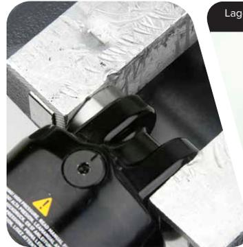
Lagereinpresswerkzeug mit 22 mm Außen- und 10 mm Innendurchmesser
