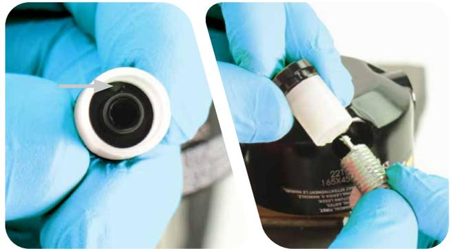
Bei richtiger Montage sollte der Federzapfen durch den Vorspanner sichtbar sein.
