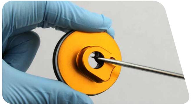
**12** Entfernen Sie mit einem Dorn den inneren O-Ring an der Gewindebasis in der Dichtkopf/Luftkolben-Baugruppe.
