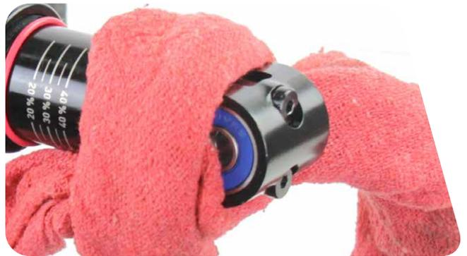
**6** Bauen Sie die Luftkammer mit einem Bandschlüssel aus. Wickeln Sie das Band um den Teil der Luftkammer, der am weitesten vom Führungsstangenauge entfernt ist. Drehen Sie den Schlüssel gegen den Uhrzeigersinn, um die Luftkammer abzuschrauben.
