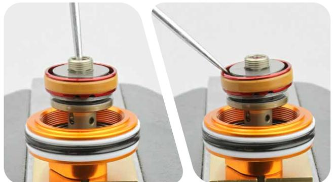
**18** Sprühen Sie Isopropyl-Alkohol auf die Gewindegänge der Kolbenmutter und reinigen Sie sie mit einem Lappen.
