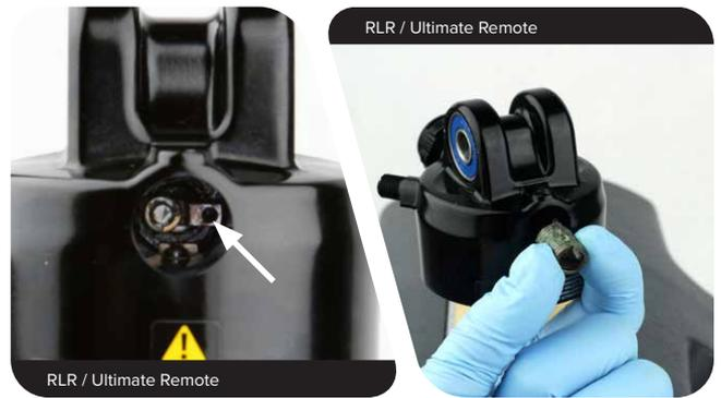
Setzen Sie eine neue Buchse mit dem eingekerbten Rand nach außen in das Auge ein.
