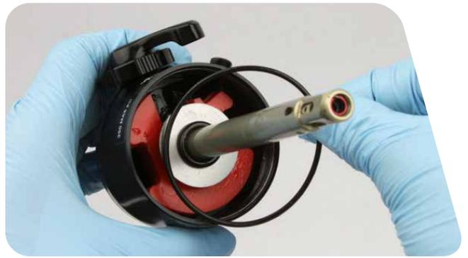
**15** Montieren Sie die Dichtkopf/Luftkolben-Baugruppe wieder auf der Dämpferführungsstange.
