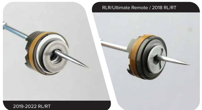
**9** Entfernen Sie die Dichtkopf/Luftkolben-Baugruppe von der Dämpferführungsstange.
