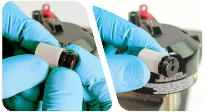
**5** Führen Sie die Feder in die Buchse ein und setzen Sie den Federzapfen in der dafür Öffnung im Federvorspanner ein.
