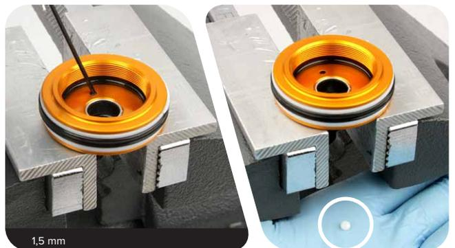
**14** Entfernen Sie mit den Fingern den O-Ring im Inneren des Gewindes des Führungsstangenauges.
