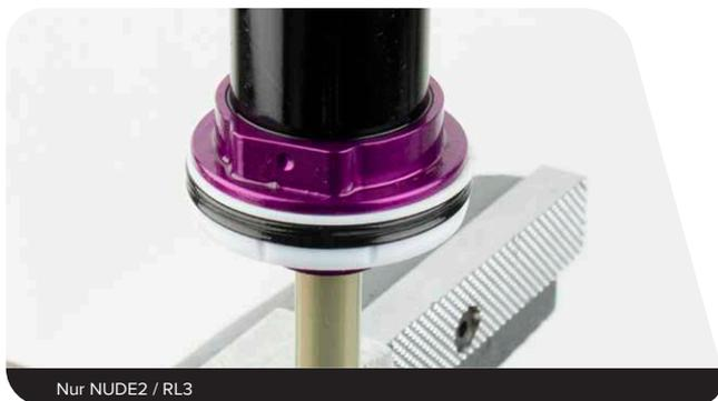
**Alle anderen Dämpfermodelle:** Klemmen Sie das Auge senkrecht im Schraubstock ein.
