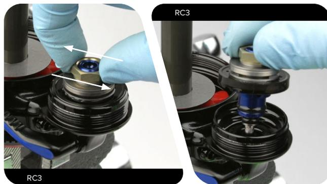
**Ultimate / RCT/ Ultimate DH / RC:** Retire el conjunto de compresión del soporte del depósito del IFP y déjelo a un lado.
