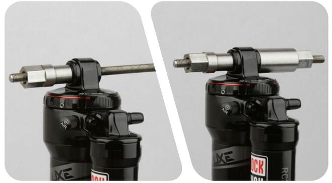
**3** Sujete la pieza receptora con una llave inglesa fija o ajustable de 13 mm.
