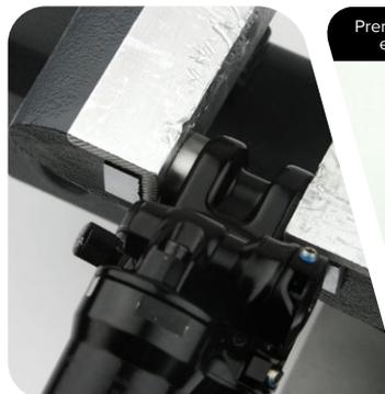
Prensa para casquillos de 22 mm (diámetro externo) x 10 mm (diámetro interno)
