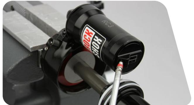
**4** Sujete el ojal al tornillo de banco en posición vertical. Empuje a tope la tapa del depósito del pistón flotante interno (IFP) hacia dentro del depósito.
