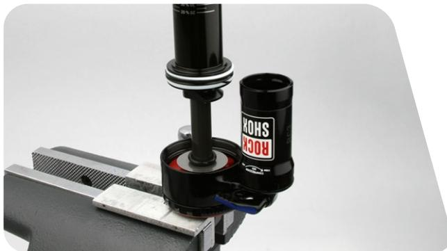
**15** Retire el tornillo de purgado del IFP del propio IFP.
