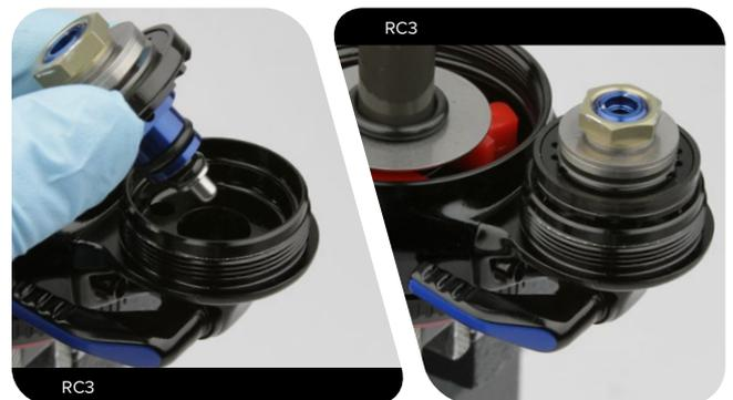
**2b** **Ultimate / RCT / Ultimate DH / RC:** Instale el conjunto de compresión en el soporte del depósito, sobre el obturador de compresión. Gire el conjunto suavemente de lado a lado hasta que la interfaz hexagonal se alinee y se bloquee en su sitio.
