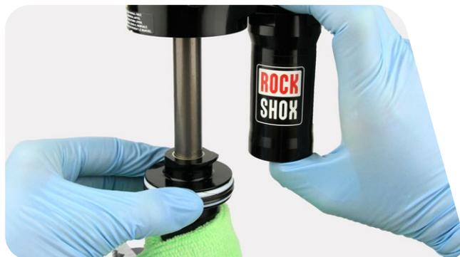
**13** Apriete el conjunto de cabezal de sellado/pistón neumático con un par de 28 N·m.
