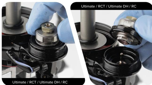
**RTR / Ultimate Remote / Select+:** Retire el resorte de retención y la cuña de retención y déjelos a un lado.
