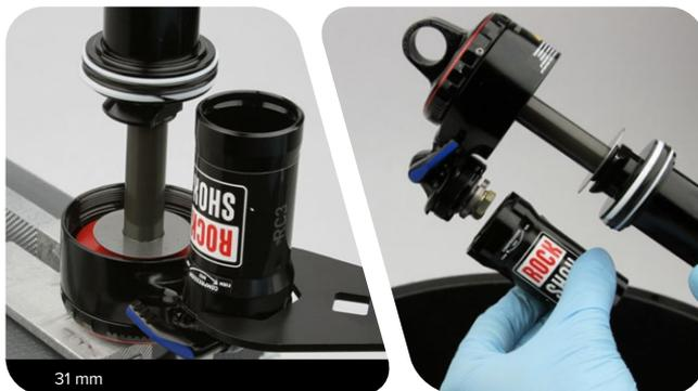
**9** Empuje el pistón IFP para sacarlo del depósito del IFP.
