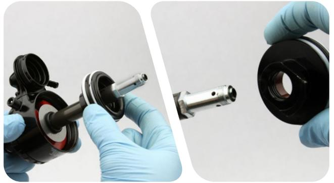
**7** Instale el junta tórica de tope en el eje del amortiguador.
