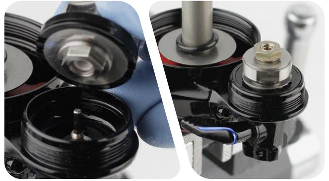
**3** **RTR / Ultimate Remote / Select+:** Utilice un punzón para comprobar que la cuña de bloqueo esté bien instalada. Inserte el punzón en los orificios de rellenado del conjunto de compresión para asegurarse de que la cuña de bloqueo pueda flexionar. Si la cuña de bloqueo no puede flexionar, retire el conjunto de compresión, enderece la cuña y vuelva a instalar el conjunto de compresión.
