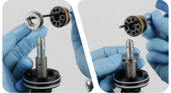
Separe el pistón de la pila de cuñas superior, aún en la llave Allen o en el punzón, y retírelo. Deslice el pistón HotDog en la llave Allen o el punzón, con el lado "HotDog" del pistón hacia el extremo de la llave Allen.
