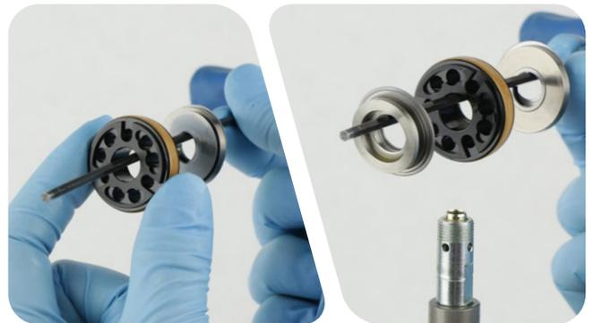
**6** Separe el conjunto cabeza/pistón del eje del amortiguador.
