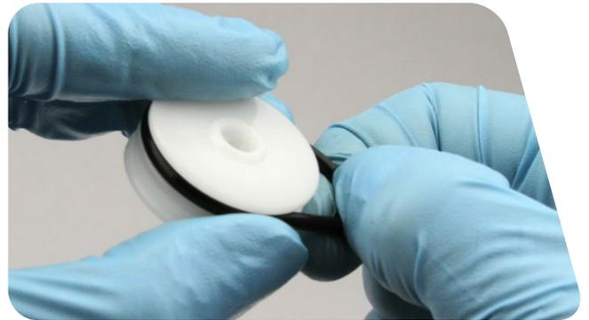
**12** **RTR / Ultimate Remote / Select+ / RC3:** Tire de la tuerca del pistón mientras la balancea lateralmente para retirar el conjunto de compresión del soporte del depósito del IFP y déjelo a un lado.
