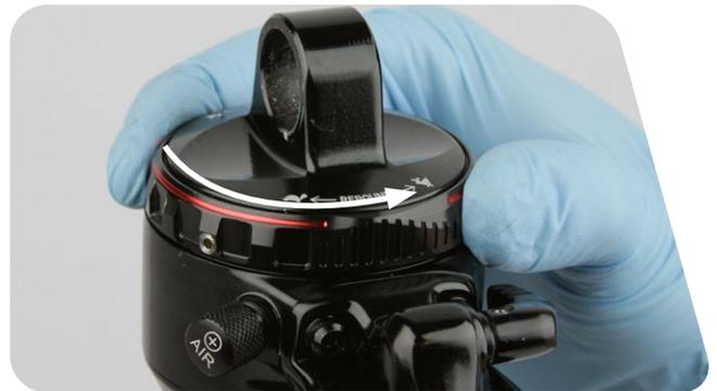
**Ultimate / RCT:** Gire a tope el mando del regulador de compresión en sentido antihorario y luego gire la palanca de umbral hasta la posición de desbloqueo.
