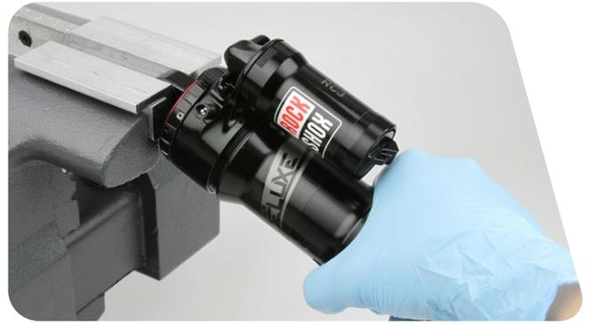
**5** Retire el amortiguador del tornillo de banco. Déle la vuelta y sujete por el ojal el cuerpo del amortiguador con el tornillo de banco.
