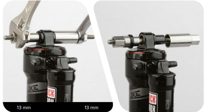
**4** Si el pasador del cojinete no sale con facilidad, desenrosque del vástago roscado el empujador para extraer el espaciador final, y luego vuelva a instalar el empujador en el vástago roscado.
