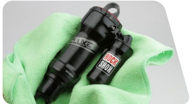
**7** Instale la junta tórica del indicador de prehundimiento ("sag").
