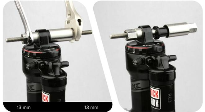
**5** Desenrosque del vástago roscado la pieza receptora.
