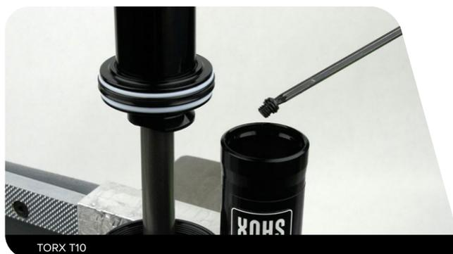
**16** Utilice una regla o un calibre métricos para empujar el IFP hacia dentro del depósito hasta una profundidad de 20 mm.
