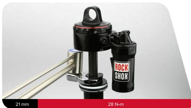
**14** Suelte el amortiguador del tornillo de banco. Dé la vuelta al amortiguador y sujete el ojal del eje al tornillo de banco.
