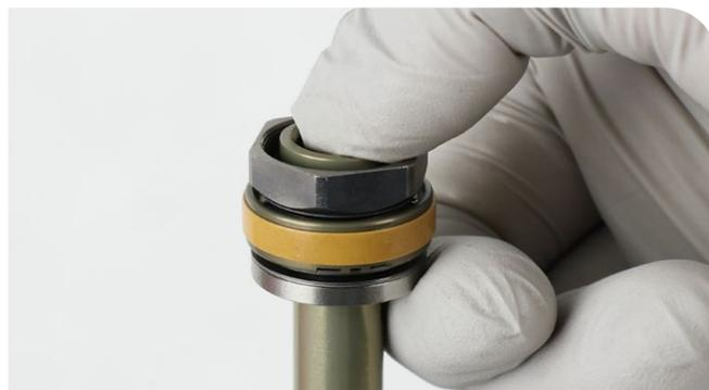
**17** Si le capuchon du piston s'est séparé de la coupelle de la valve lors du démontage, installez un joint torique neuf dans la coupelle de la valve. Vissez le capuchon du piston sur la coupelle de la valve puis serrez l'unité du piston au couple recommandé.
