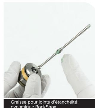
Graisse pour joints d'étanchéité dynamique RockShox.
