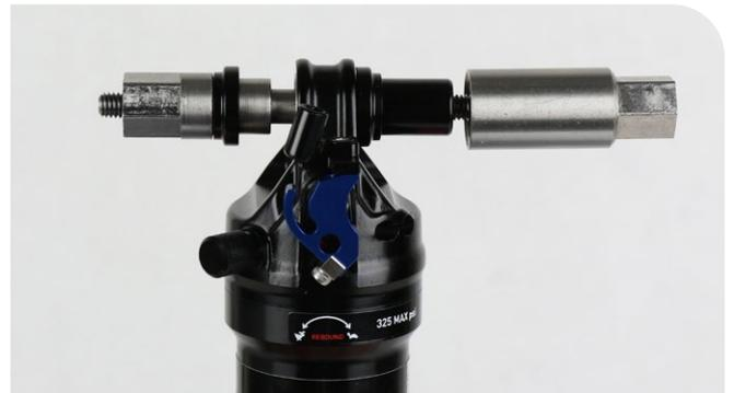
**4** Si la clavette de la bague ne se démonte pas facilement, réinsérez la tige filetée et la clavette de pression à travers l'œillet de la came.
