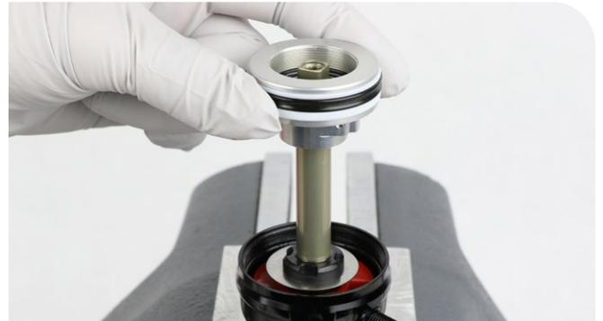
**6** Retirez la butée de talonnage et la rondelle de talonnage de la tige de l'amortisseur.
