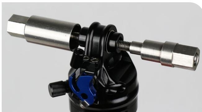
**5** Insérez une entretoise de butée avec son côté le plus large en premier sur chaque extrémité de la clavette de la bague.
