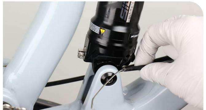
**Amortisseurs arrière à 90° avec rappel à distance :** Pour l'entretien 200 heures, un câble doit être inséré dans l'œillet afin que l'unité de l'œillet ne se désassemble pas pendant l'entretien. Quand l'amortisseur est déposé du cadre, installez le câble dans la butée de gaine de la commande à distance. Tirez le câble pour que la tête du câble soit fermement au contact de l'œillet, et serrez la vis de fixation.
