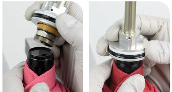
**5** Serrez l'unité tête d'étanchéité/piston pneumatique.
