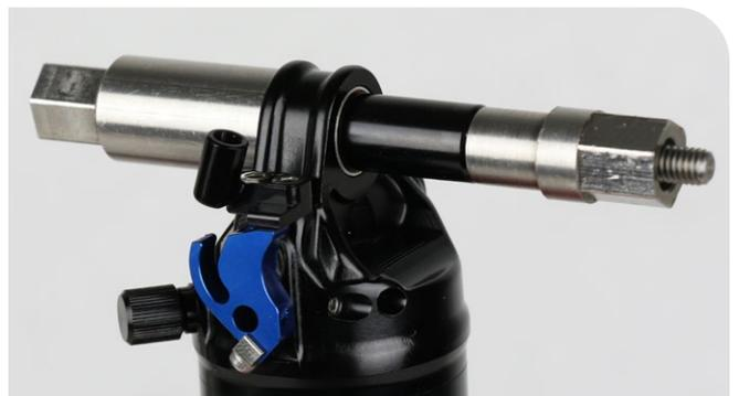
**4** Serrez le receveur dans un étau ou bloquez-le fermement à l'aide d'une clé plate de 13 mm.
