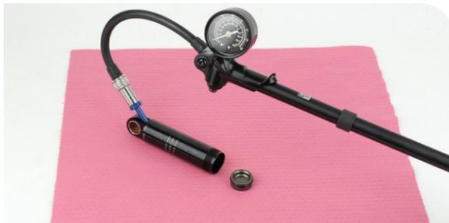
Adaptateur pour valve pneumatique SIDLuxe et pompe pour amortisseur
