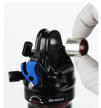
Pour remplacer les bagues de l'œillet et les éléments de fixation, consultez le chapitre [Montage de l'œillet de l'amortisseur](#).
