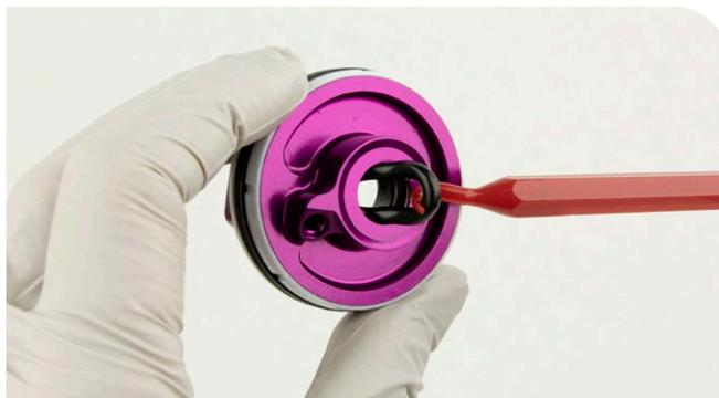
**10** Retirez le joint torique interne situé à la base du filetage à l'intérieur de l'unité tête d'étanchéité/piston à air. Mettez en place un joint torique interne neuf dans l'unité tête d'étanchéité/piston à air.
