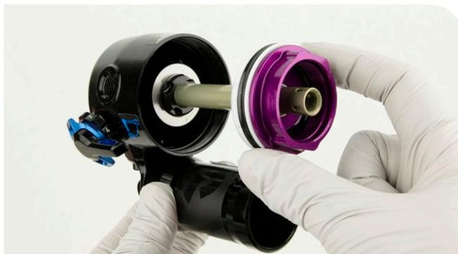
**9** Retirez le joint torique interne situé dans la cannelure pour joint interne. Mettez en place un joint torique interne neuf dans la cannelure pour joint.
