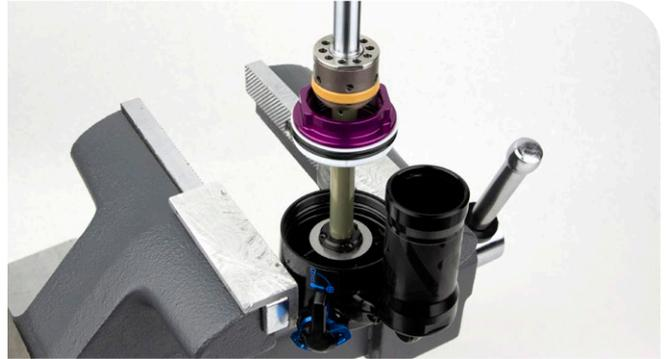
**2** Versez de l'huile de suspension Maxima PLUSH 7wt dans le réservoir du PFI jusqu'à ce que son niveau affleure avec le haut du réservoir.
