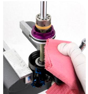
**4** Retirez l'amortisseur de l'étau. Tapotez avec douceur l'amortisseur sur le banc de travail à plusieurs reprises pour purger toutes bulles restantes. Installez la vis de purge du PFI sur le PFI. La vis de purge doit être entièrement immergée dans le liquide.
