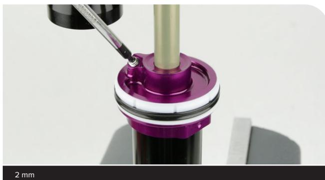
**3** Posez un récipient pour recueillir l'huile sous le corps de l'amortisseur. Desserrez l'unité tête d'étanchéité/piston à air située sur le corps de l'amortisseur.
