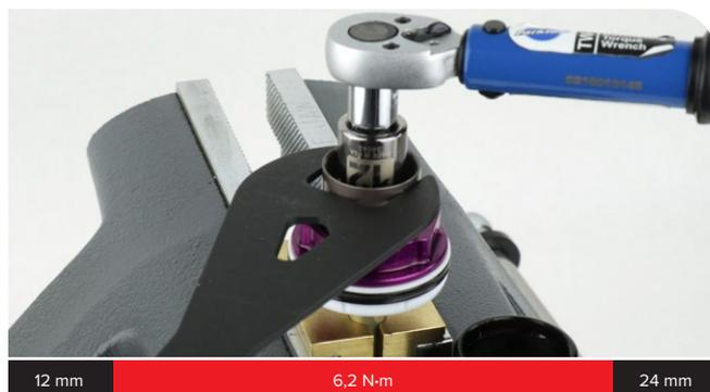
**17** Installez les rondelles intercalaires, la (les) rondelle(s) de verrouillage et le piston de verrouillage, dans cet ordre, sur l'unité du piston, en vérifiant que chaque élément est centré sur le boulon du piston.
