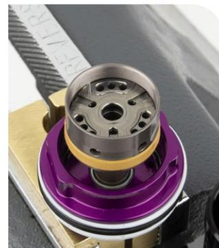
**18** Alignez la goupille de guidage sur le piston avec l'orifice de guidage dans l'outil pour piston de verrouillage RCT/NUDE. Vissez le piston de verrouillage à la main, puis utilisez une clé plate de 24 mm sur l'outil pour piston de verrouillage RCT/NUDE pour serrer le piston de verrouillage à un couple de 4,5 Nm.
