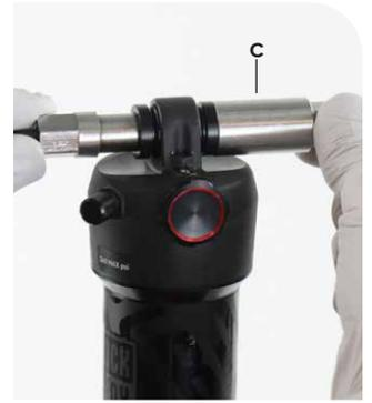
**3** Coloque el receptor en un tornillo de banco o sujételo con una llave de boca de 13 mm o inglesa.
