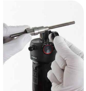
**4** Si el pasador del casquillo no sale fácilmente, vuelva a introducir la varilla roscada y el pasador de empuje a través del ojal del eje.
