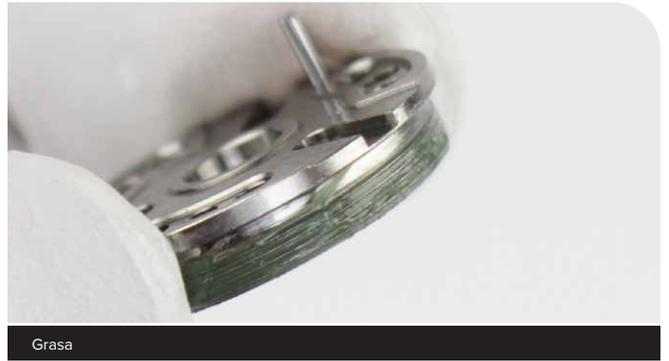
**29** **Ultimate RCT:** Alinee el pasador de guía del pistón de bloqueo con el orificio del pasador de guía de la herramienta de pistones de bloqueo RCT/NUDE Deluxe e introduzca el pistón de bloqueo en la herramienta.
