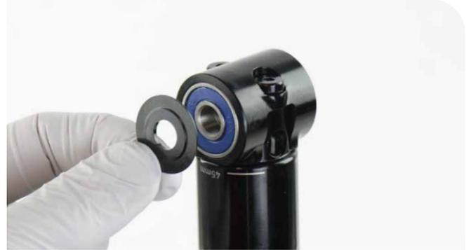
**2** **Ojal del cuerpo del amortiguador:** Sujete firmemente el ojal en bloques adaptadores para tornillo de banco de aluminio o plástico. Coloque el ojal de forma segura en una superficie plana.
