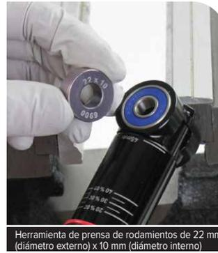
Herramienta de prensa de rodamientos de 22 mm (diámetro externo) x 10 mm (diámetro interno)
