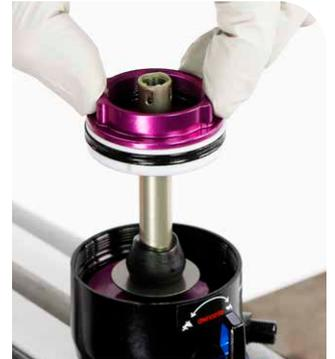
**20** Coloque el cabezal de sellado/pistón neumático justo debajo del extremo del eje del amortiguador.
