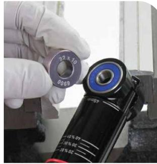
Herramienta de prensa de rodamientos de 22 mm (diámetro externo) x 10 mm (diámetro interno)
