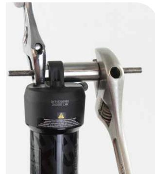
**3** Desenrosque el receptor de la varilla roscada. Retire la herramienta del ojal y deseche el casquillo.
