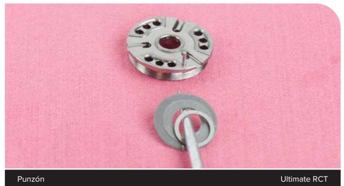
**7 Ultimate RCT, Select+ RT, Select+ RL:** Afloje la tuerca del pistón. No la saque completamente del conjunto del pistón para evitar que se separen las piezas.
