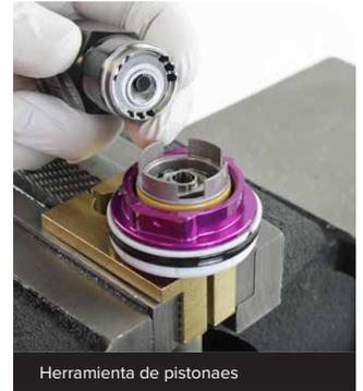
**6 Ultimate RCT:** Retire las cuñas espaciadoras de la tuerca del pistón. A continuación, coloque a un lado el pistón de bloqueo, las cuñas de bloqueo y las cuñas espaciadoras en el orden en que se han retirado del pistón.
