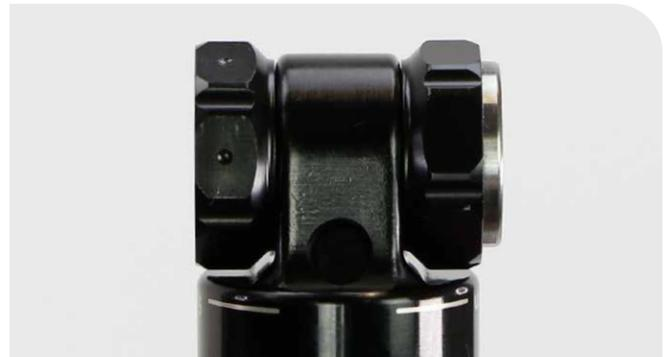
**6** Adaptador de rodamiento original (si se retiró antes del mantenimiento): Instale ambas cubiertas de los rodamientos.
