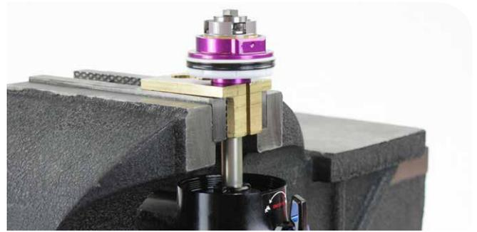
Bloques adaptadores para tornillo de banco RockShox (3 orificios) - ranura de 10 mm
