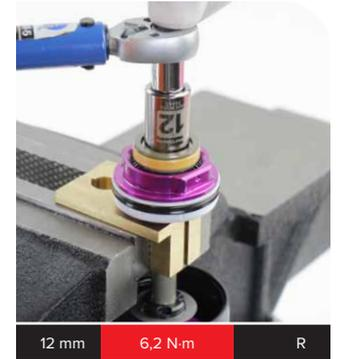
**27** **Ultimate RCT:** Siguiendo el mismo orden en que se retiraron, instale la pila de cuñas de bloqueo en el perno del pistón.
