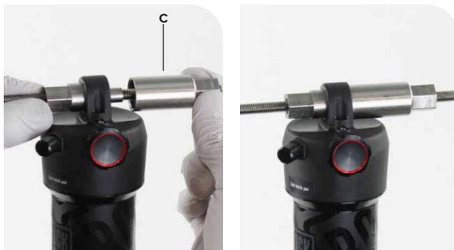
**2** Coloque el receptor en un tornillo de banco o sujételo con una llave de boca de 13 mm o inglesa.
