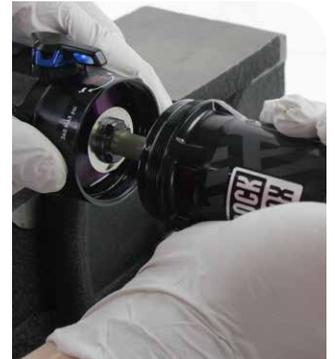
**7** Tire con fuerza de la lata de aire hasta que salga del cabezal de sellado/pistón neumático y retírela del amortiguador.
