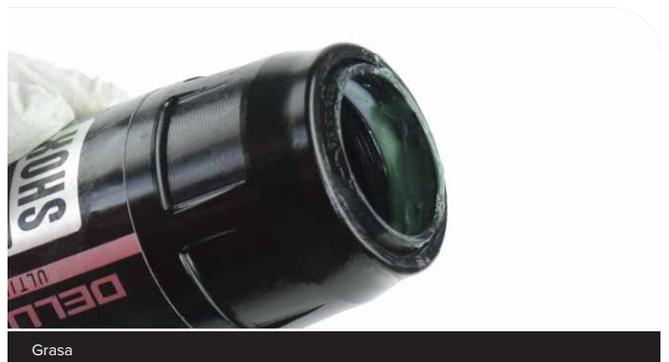
**8** Retire la junta tórica del exterior de la lata de aire.
