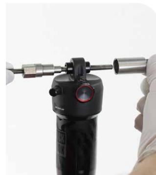
**6** Insérez une entretoise de butée par son côté à épaulement sur chaque extrémité de la clavette de la bague.
