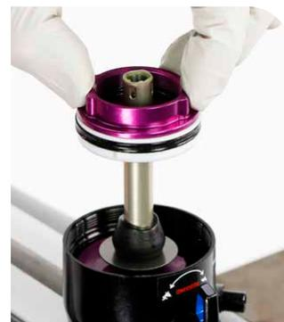
**20** Positionnez la tête d'étanchéité/piston à air juste en dessous de l'extrémité de la tige de la cartouche d'amortissement.
