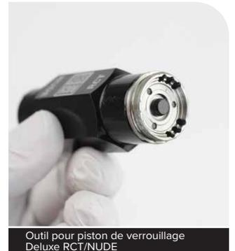
**30** Vissez le piston de verrouillage sur le piston à la main. Appliquez une certaine pression sur l'outil pour piston de verrouillage Deluxe RCT/NUDE pendant l'installation du piston de verrouillage afin d'éviter que l'outil ne glisse sur le piston et qu'il n'endommage la goupille de guidage.
