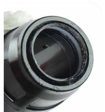
**7** Appliquez de la graisse sur le joint quadrilobe, la bague et le joint anti-poussière.
