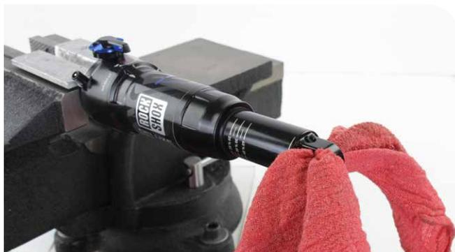
**Œillet à roulements** : si l'unité de l'œillet à roulements a été retirée lors d'une étape précédente, remettez-la en place de façon temporaire sur le corps de la cartouche d'amortissement. Enroulez un chiffon autour de l'unité de l'œillet à roulements pour la protéger.
