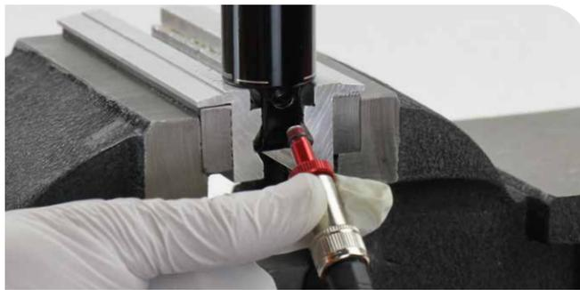
Adaptateur pour valve à air d'amortisseur arrière
