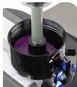
**19** Appliquez de la graisse sur le joint torique interne de la tête d'étanchéité et sur la bague.
