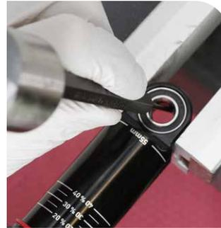
Poinçon pour roulements et Marteau
