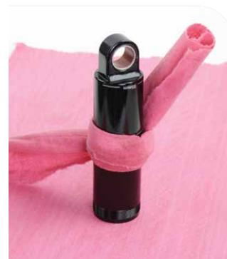
**10** À l'aide d'une lampe torche, inspectez les surfaces internes et externes du corps de la cartouche d'amortissement pour vérifier qu'il ne présente ni rayures ni bosses et qu'il n'est pas déformé. Si vous décelez des déformations, le corps de la cartouche d'amortissement devra être remplacé.
