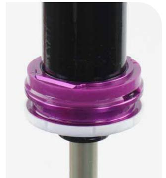
**2** Appliquez de la graisse sur un joint quadrilobe neuf, puis installez-le sur le piston.
