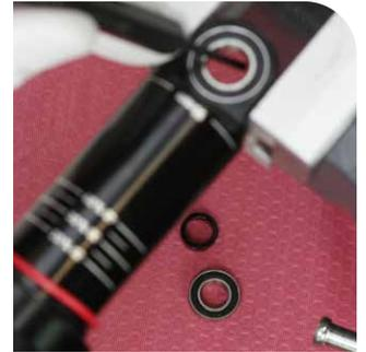
Poinçon de petit diamètre pour roulement
