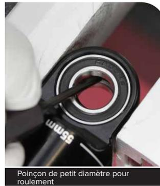
Poinçon de petit diamètre pour roulement
