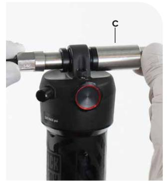
**3** Serrez le receveur dans un étau ou bloquez-le fermement à l'aide d'une clé plate de 13 mm ou d'une clé à molette.
