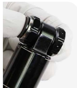
Un adaptateur à roulement neuf (23 mm) comprend un roulement dans l'adaptateur sans poinçon qui n'est pas complètement mis en place et qui doit obligatoirement être enfoncé et inséré dans l'adaptateur avant de pouvoir installer l'amortisseur sur le vélo.
