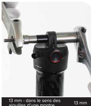
13 mm - dans le sens des aiguilles d'une montre 13 mm
