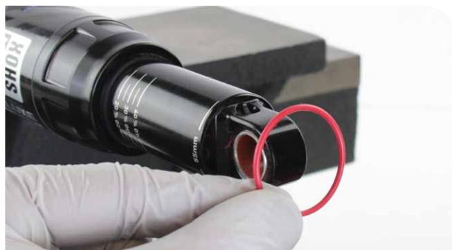
**5** **Œillet standard** : insérez un chiffon à travers l'œillet du corps de la cartouche d'amortissement pour éviter que la chambre d'air ne soit violemment éjectée de l'amortisseur.
