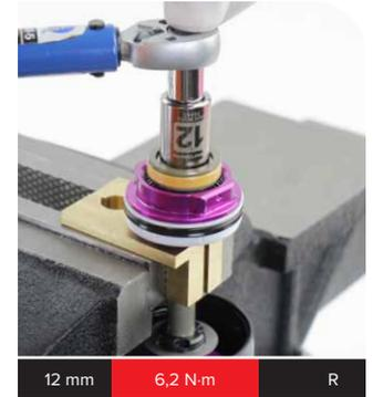
**27** **Ultimate RCT** : sans changer l'ordre des pièces, installez la pile des rondelles de verrouillage sur la vis du piston.
