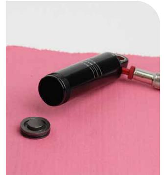
**2** Sprühen Sie RockShox Suspension Cleaner auf die Innen- und Außenseite des Dämpferkörpers.
