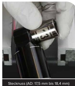
Stecknuss (AD: 17,5 mm bis 18,4 mm)
