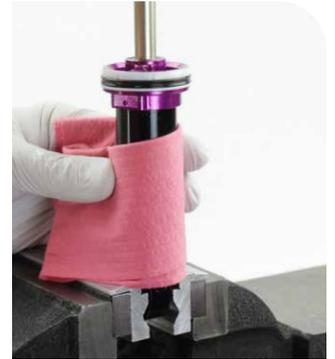
Ersetzen Sie den O-Ring oder die Dichtung durch ein neues Teil aus dem Wartungssatz. Entfernen Sie den O-Ring oder die Dichtung mit den Fingern oder einem Dorn.
