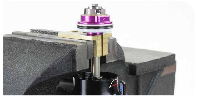
RockShox-Schraubstockblöcke (3 Löcher) – 10-mm-Nut
