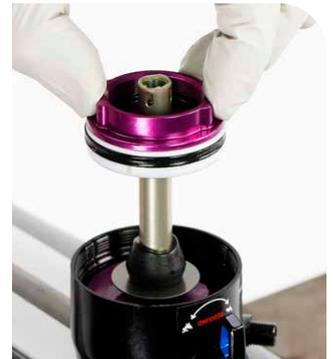
**20** Positionieren Sie die Dichtkopf/Luftkolben-Baugruppe direkt unter dem Ende der Dämpferführungsstange.
