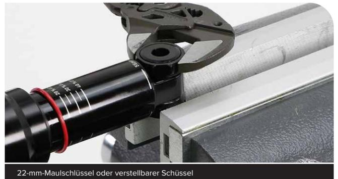
22-mm-Maulschlüssel oder verstellbarer Schlüssel
