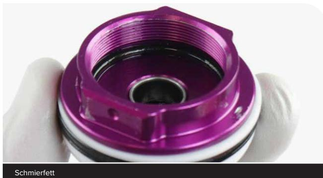
**15** Entfernen Sie die Nylondruckkugel von der Dichtkopf/Luftkolben-Baugruppe.
