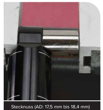
Stecknuss (AD: 17,5 mm bis 18,4 mm)
