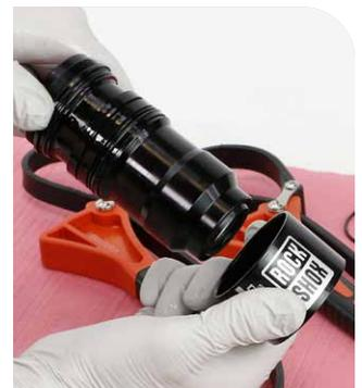
**3** Entfernen und entsorgen Sie die O-Ringe der Hülse.
