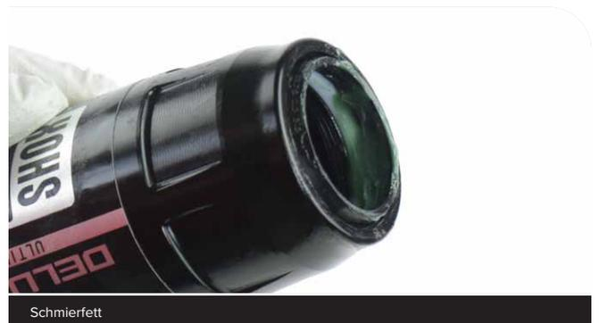
**8** Entfernen Sie den O-Ring auf der Außenseite der Luftkammer.
