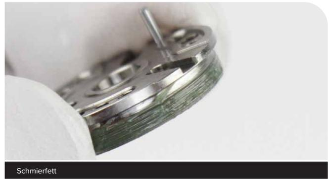
**29** **Ultimate RCT:** Richten Sie den Führungsstift des Verschlusskolbens auf die Führungsstiftbohrung im Deluxe RCT / NUDE Verschlusskolbenwerkzeug aus und setzen Sie den Verschlusskolben auf das Werkzeug auf.
