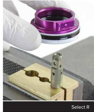
**10** Entfernen Sie den Anschlagpuffer-O-Ring und entsorgen Sie ihn.
