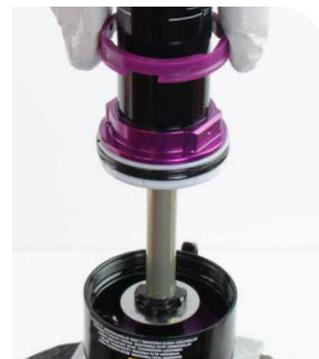
**1** Entfernen Sie den O-Ring unter dem Gewinde des Führungsstangenauges.
