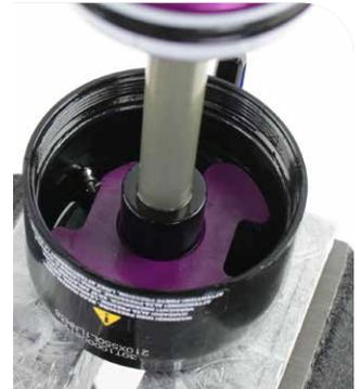
**2** Entfernen und entsorgen Sie die Staubabstreiferdichtung der Luftkammer.
