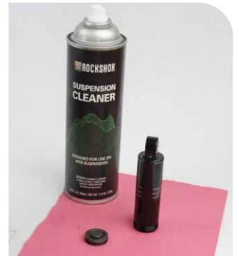
**3** Entfernen und entsorgen Sie den IFP-O-Ring.
