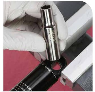
Stecknuss (AD: 14,5 mm bis 16,25 mm)
