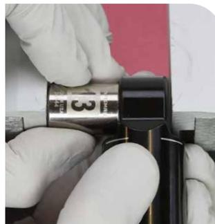
Stecknuss (AD: 17,5 mm bis 18,4 mm)
