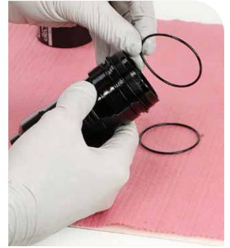
**4** Entfernen Sie alle montierten Bottomless Tokens.
