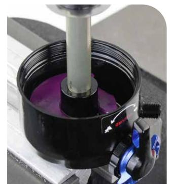
**19** Tragen Sie Schmierfett auf den inneren O-Ring des Dichtkopfes und die Buchse auf.
