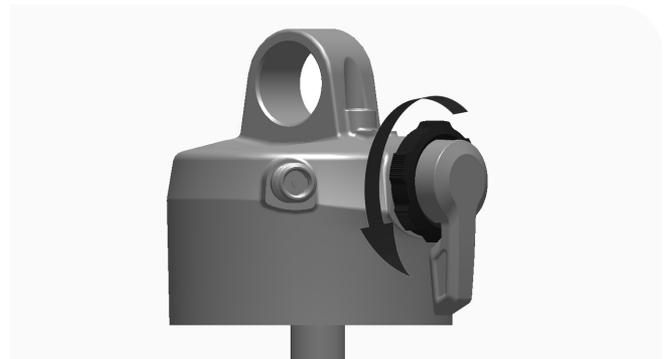
**Ultimate RCT :** vérifiez que le régleur de la compression (A) est tourné sur la position zéro/centrale. Tournez le levier (B) en position ouverte/déverrouillée.
