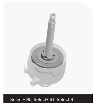
**5** **Select+ RL, Select+ RT, Select R** : serrez la tige de la cartouche d'amortissement dans un étau équipé de cales RockShox (3 trous) (encoche de 10 mm), juste en dessous de l'œillet.
