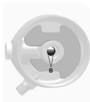
Lorsque l'extrémité fendue de la tige de détente est alignée et insérée dans les bords plats situés à l'intérieur de l'œillet, vissez l'unité de la tige de la cartouche d'amortissement à l'intérieur de l'œillet à la main jusqu'à ce qu'elle se bloque.
