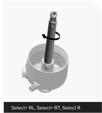
**4** **Select+ RL, Select+ RT, Select R** : serrez la tige de la cartouche d'amortissement dans un étau équipé de cales RockShox (3 trous) (encoche de 10 mm), juste en dessous de l'œillet.
