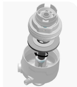
**11 Ultimate RCT :** serrez la tige de la cartouche d'amortissement dans un étau équipé de cales d'étau RockShox (3 trous) (encoche de 10 mm), juste en dessous de l'œillet et de la butée de talonnage.
