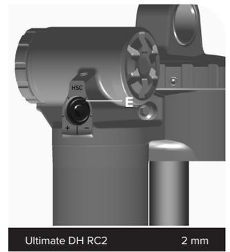
**3** **Select+ RT** : desserrez la vis de fixation du levier.
