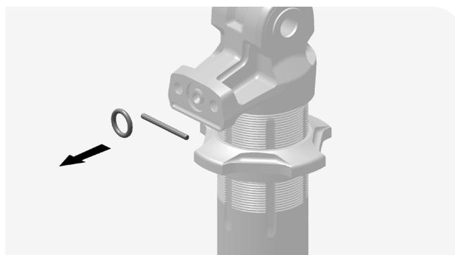
**1** Installez le joint torique du réservoir et la goupille d'alignement.
