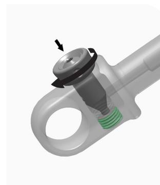
**3** Appliquez de la graisse sur (A) les joints toriques de l'aiguille de détente. Appliquez de la graisse sur l'extrémité de l'aiguille.
