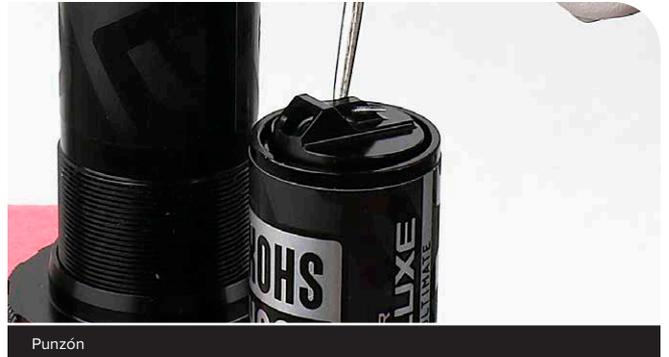
**7** Retire la junta tórica de la tapa del depósito del IFP. Instale una junta tórica nueva. Aplique grasa a la junta tórica y a la tapa del depósito.
