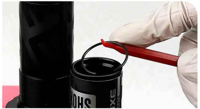
**6** Quite la tapa del depósito del IFP del propio depósito.
