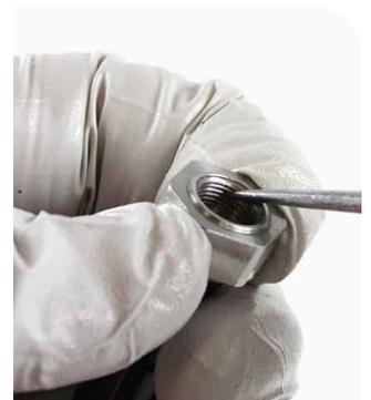
**27** Aplique Loctite a las 3 primeras roscas del eje del amortiguador.
