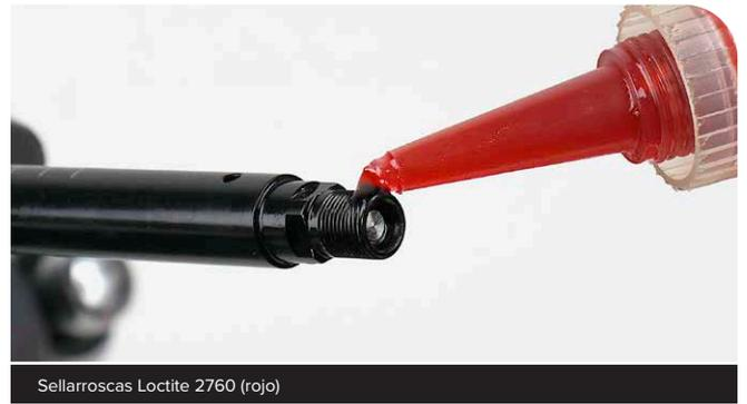
**28** Instale el conjunto del cabezal de sellado en el eje del amortiguador.
