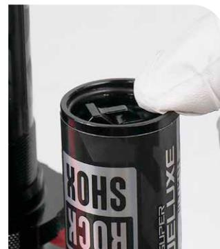
**18** Tire hacia arriba de la tapa del depósito del IFP para asentarla contra el anillo de retención.
