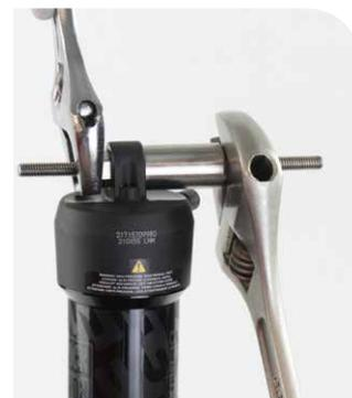
**3** Desenrosque el receptor de la varilla roscada. Retire la herramienta del ojal del eje y deseche el casquillo antiguo.
