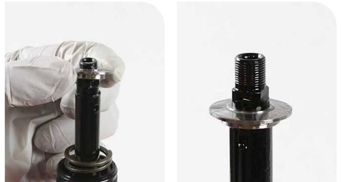
**30** Instale la pila de cuñas de compresión, el plato superior y la pila de cuñas de retención en el eje del amortiguador.
