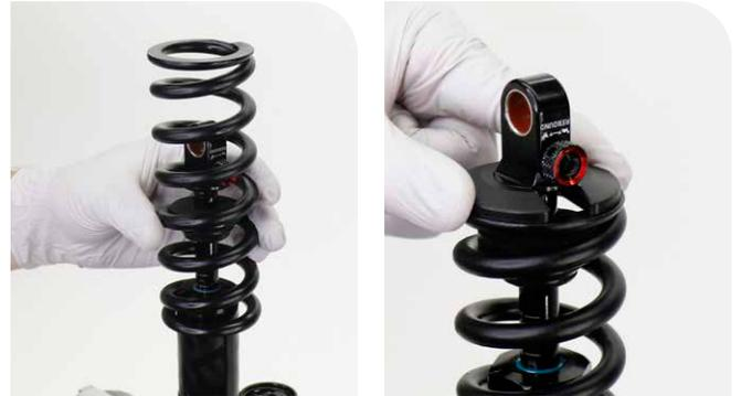
**25** Consulte los ajustes de rebote y compresión del amortiguador que anotó al iniciar el mantenimiento. Ajuste cada regulador con el número registrado de clics/vueltas.
