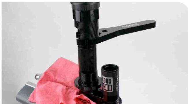
**16** Empuje la tapa del depósito en el depósito del IFP hasta que quede visible la ranura del anillo de retención.
