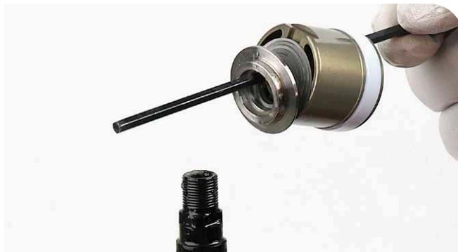
**17** Saque el cabezal de sellado del eje del amortiguador.
