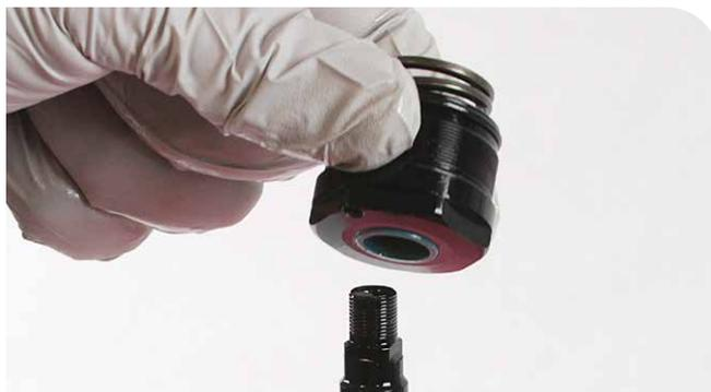
**18** Tire del resorte Counter Measure para sacarlo del cabezal de sellado.
