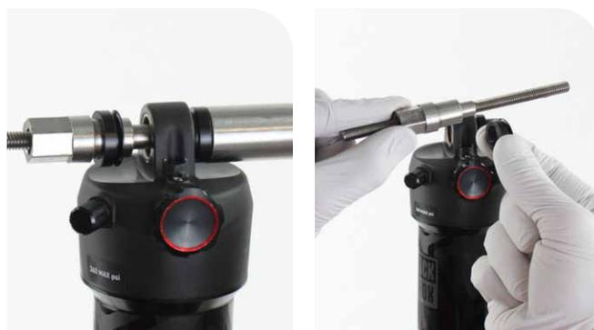
**4** Si no consigue sacar fácilmente el pasador del casquillo, vuelva a insertar la varilla roscada y el pasador de empuje a través del ojal del eje.
