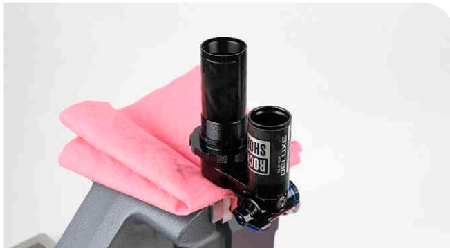
**2** Vierta aceite para suspensiones en el depósito del IFP hasta llegar al tope del depósito. El aceite comenzará a pasar al cuerpo del amortiguador.
