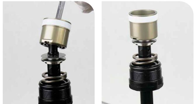
**31** Enrosque el poste inferior en el eje del amortiguador y apriételo a 8,5 N-m.
