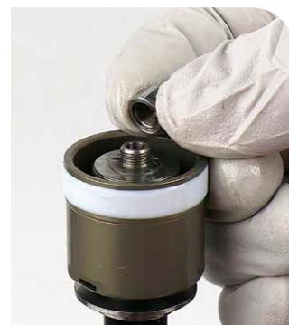
**15** Deslice las dos cuñas superiores, el pistón de retención y las dos cuñas inferiores para sacarlos del eje y recogerlos en una llave Allen pequeña o un punzón.
