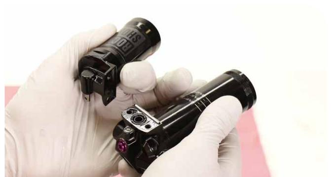
**3 Ultimate DH RC2:** Desenrosque el perno expuesto izquierdo del depósito (3 mm).
