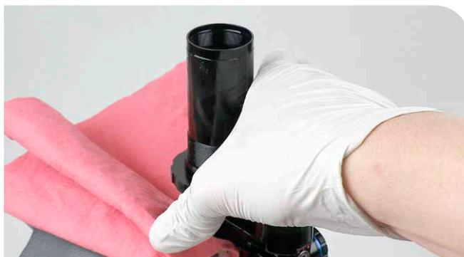
**3** Una vez que la mayor parte del aceite del depósito del IFP haya pasado al cuerpo del amortiguador, use la palma de la mano para golpear repetidamente la parte superior del cuerpo del amortiguador a fin de hacer volver el aceite al depósito. Esto ayudará a purgar aún más las burbujas de aire del sistema.
