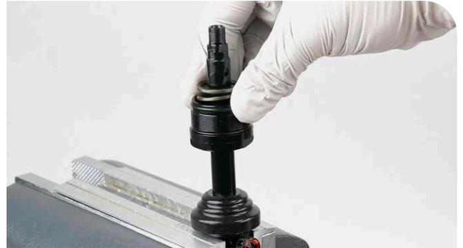
**29** Instale el plato superior en el eje del amortiguador.
