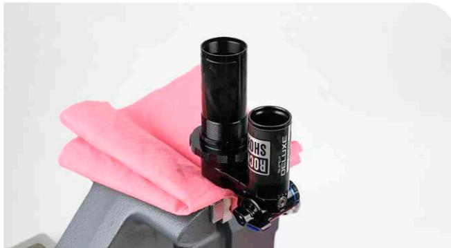
**2** Versez de l'huile de suspension dans le réservoir du PFI jusqu'à ce que son niveau affleure avec le haut du réservoir du PFI. De l'huile va commencer à passer dans le corps de la cartouche d'amortissement.
