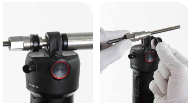
**4** Si la clavette de la bague ne se démonte pas facilement, réinsérez la tige filetée et la clavette de pression à travers l'œillet de la tige.
