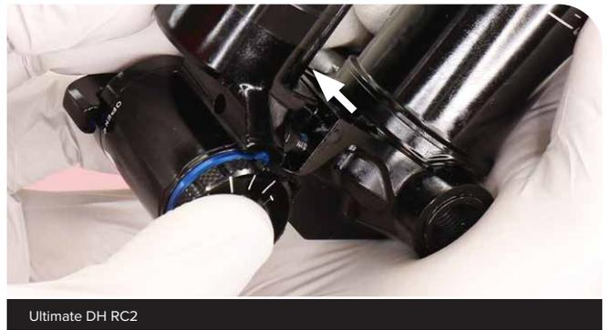
Retirez la vis gauche du réservoir ainsi que l'unité du réservoir.
