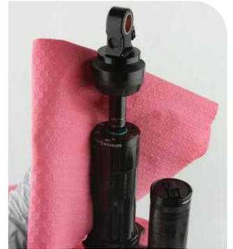
Remplacez le joint ou joint torique par un neuf fourni dans le kit d'entretien. Avec vos doigts ou une pointe, retirez le joint ou joint torique usagé.
