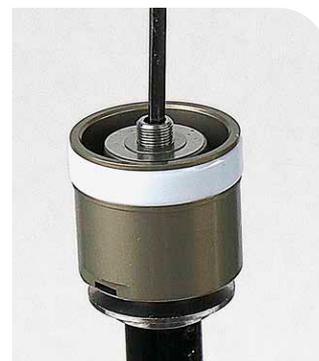
**33** Vissez l'écrou du piston de contrôle sur la tige de la cartouche d'amortissement, puis serrez-le au couple de 2,26 N·m.
