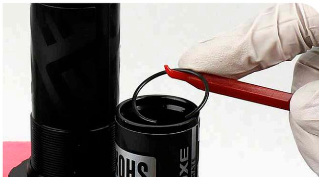
**6** Retirez le capuchon du réservoir du PFI situé sur le réservoir du PFI.
