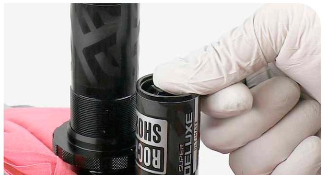
**5** Retirez le circlip situé sur le réservoir du PFI.
