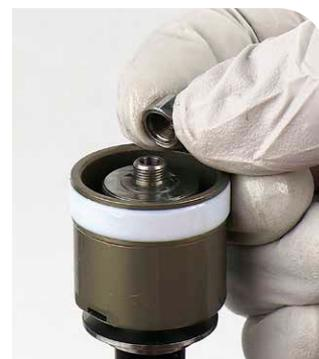
**15** Faites coulisser les deux rondelles supérieures, le piston de contrôle et les deux rondelles inférieures en dehors de la tige et faites-les passer sur une petite clé hexagonale ou une pointe.
