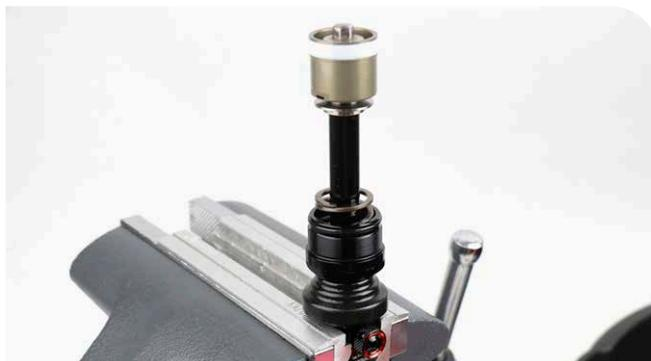
**14** Retirez l'écrou du piston de contrôle.
