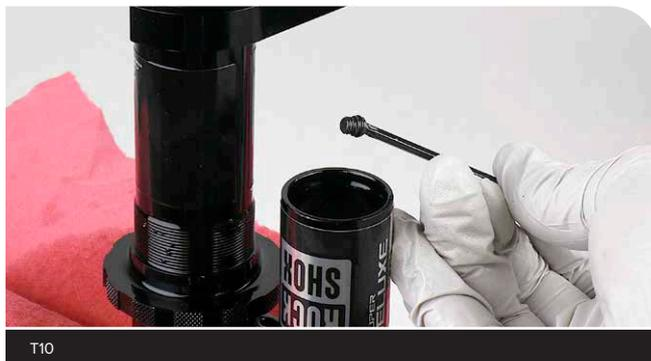
10 Enroulez un chiffon autour du réservoir du PFI pour éponger les coulures d'huile. Insérez une petite clé hexagonale dans l'encoche près du repère 41 mm ou 35 mm sur l'outil de réglage de la hauteur du PFI, en fonction du débattement de votre amortisseur.
