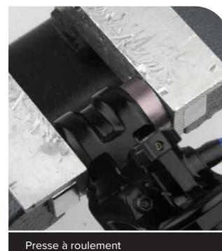
**3** Retirez l'amortisseur hors de l'étau. Les roulements doivent être enfoncés à environ 1 mm en-dessous du bord externe de leur emplacement.
