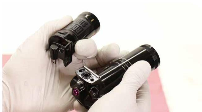
**3** **Ultimate DH RC2** : dévissez la vis gauche du réservoir qui est visible (3 mm).
