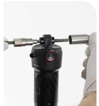
**6** Insérez une entretoise de butée par son côté à épaulement sur chaque extrémité de la clavette de la bague.
