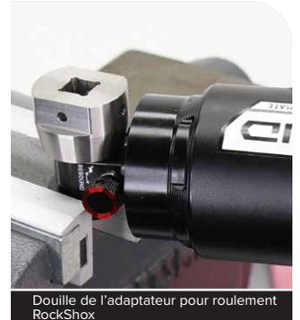
**6** Serrez le roulement au couple recommandé.
