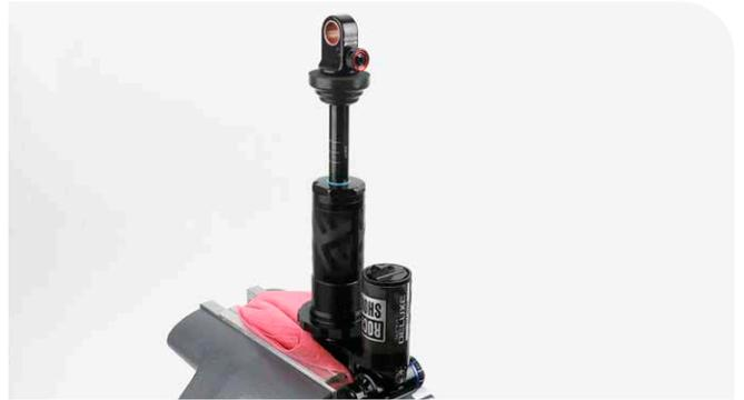
**2** Retirez le capuchon de la valve du réservoir du PFI. Appuyez sur la valve Schrader pour évacuer toute la pression pneumatique contenue dans le réservoir du PFI.
