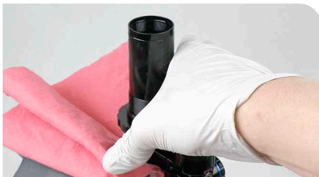
**3** Une fois que la plus grande partie de la quantité d'huile contenue dans le réservoir du PFI est passée dans le corps de la cartouche d'amortissement, tapez sur le dessus du corps de la cartouche d'amortissement à plusieurs reprises avec la paume de la main pour refaire passer l'huile dans le réservoir. Ceci permet de retirer les bulles d'air toujours présentes dans le circuit.
