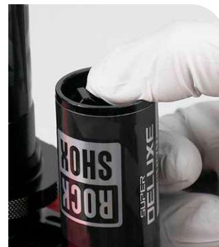
**17** Mettez le circlip neuf en place dans sa cannelure.
