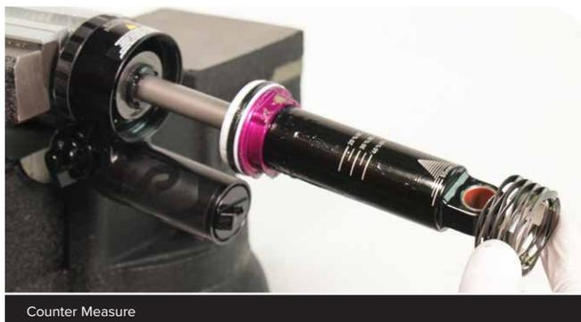
Les Bottomless Tokens réduisent le volume d'air de la chambre d'air de l'amortisseur arrière et augmentent la progressivité ou la résistance du ressort sur la partie finale du débattement de l'amortisseur. Ajoutez ou retirez des Bottomless Token pour affiner le réglage de la résistance du ressort.
