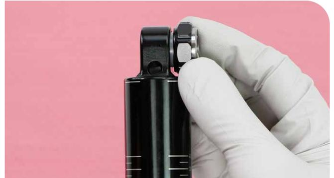
**3** Installez l'adaptateur à roulement avec filetage externe (avec poinçon sur ses bords hexagonaux) dans l'œillet et vissez-le dans le roulement avec filetage interne.
