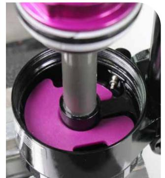
Repoussez la butée et la rondelle de talonnage vers le bas.
