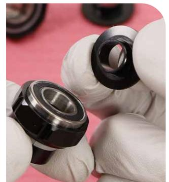
**2** Vérifiez que la rondelle d'écrasement est parfaitement installée dans la cannelure de l'adaptateur.
