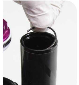
**5** Retirez le capuchon du réservoir du PFI situé sur le réservoir du PFI.
