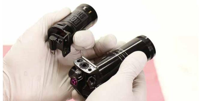
**3** **Select+ RCT, Ultimate DH RC2** : dévissez la vis gauche du réservoir (A) qui est visible (3 mm).
