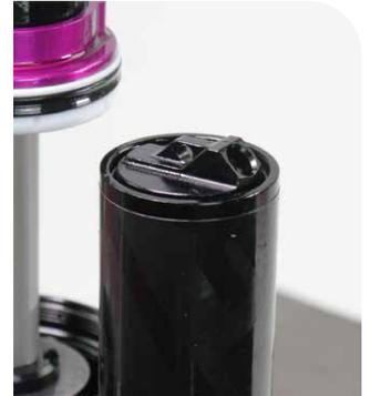
**28** Réinstallez la valve Schrader dans le capuchon du réservoir du PFI.
