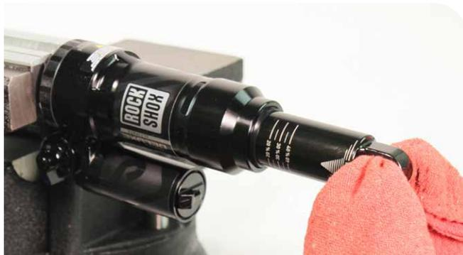
**Œillet à roulements** : si l'unité de l'œillet à roulements a été retirée lors d'une étape précédente, remettez-la en place sur le corps de la cartouche d'amortissement pour éviter que la chambre d'air ne soit violemment éjectée de l'amortisseur.
