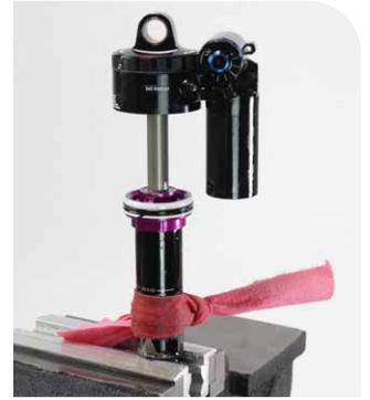
**12** Maintenez le corps de la cartouche d'amortissement sous l'unité tête d'étanchéité/piston à air. Bloquez la clé avec votre main pour éviter que la clé ne glisse et ne raye la tige de la cartouche d'amortissement.
