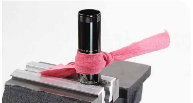
**10** Versez de l'huile pour suspension Maxima PLUSH 7wt dans le corps de la cartouche d'amortissement jusqu'à ras bord.
