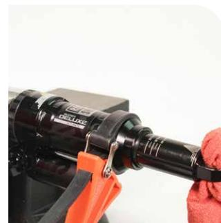
Clé à sangle en caoutchouc Chambre d'air standard
