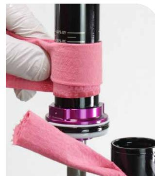
**24** Pour vérifier la qualité de la purge, insérez de nouveau l'outil de mesure de la hauteur du PFI RockShox V2 (Super Deluxe) dans le réservoir du PFI et appuyez sur le PFI avec une force d'environ 11 kg/111 N.
