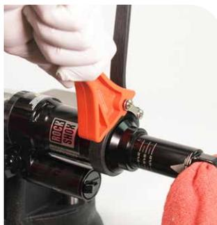
Clé à sangle en caoutchouc Chambre d'air standard
