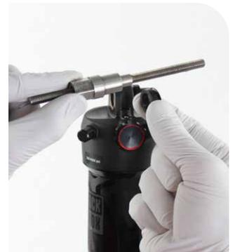
**4** Si la clavette de la bague ne se démonte pas facilement, réinsérez la tige filetée et la clavette de pression à travers l'œillet de la tige.
