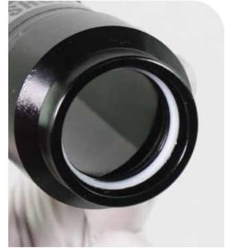
**6** Installez le joint anti-poussière neuf dans la chambre d'air.
