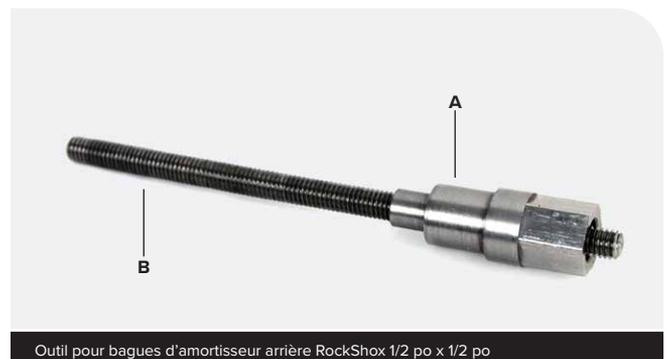
**2** Insérez la tige filetée (A) à travers l'œillet jusqu'à ce que la clavette de pression (B) vienne en appui contre la clavette de la bague.
