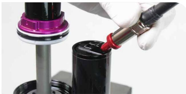
Adaptateur pour valve à air d'amortisseur arrière
