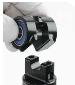
**3** Installez l'unité de fixation de l'œillet à roulements neuve avec ses vis sur l'amortisseur.
