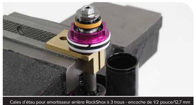
Cales d'étau pour amortisseur arrière RockShox à 3 trous - encoche de 1/2 pouce/12,7 mm
