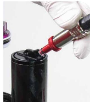
**30** Installez un joint torique neuf sur le capuchon de la valve à air du réservoir.
