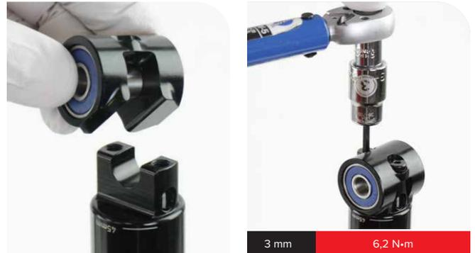
Une fois l'amortisseur remis en place sur le vélo, installez les protections anti-poussière des roulements.
