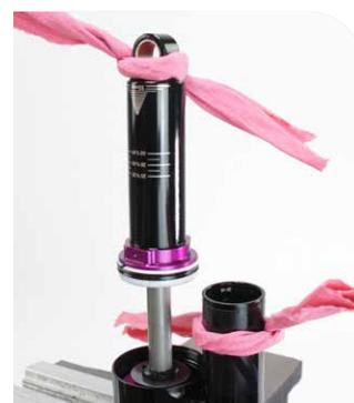
**21 Réglage du PFI à la profondeur indiquée** : insérez une clé hexagonale de 3 mm dans la fente de l'outil de mesure de la hauteur du PFI RockShox V2 (Super Deluxe) au niveau de la valeur de la profondeur appropriée au modèle de l'amortisseur correspondant.
