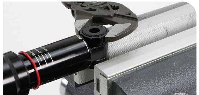
22-mm-Maulschlüssel oder verstellbarer Schlüssel
