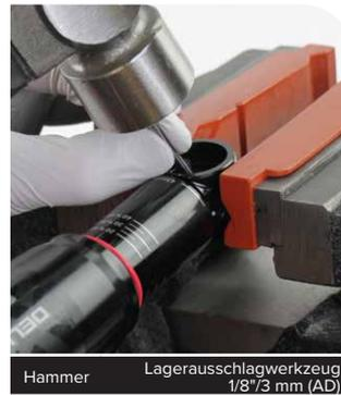
Hammer Lagerausschlagwerkzeug 1/8"/3 mm (AD)
