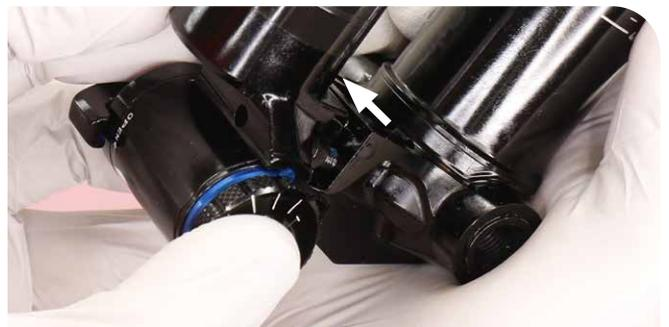
Entfernen Sie die linke Ausgleichsbehälterschraube und die Ausgleichsbehälter-Baugruppe.
