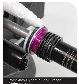
RockShox Dynamic Seal Grease-Dichtungsfett
