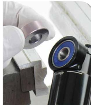
**3** Setzen Sie ein neues Distanzstück in das Auge ein und platzieren Sie ein neues Lager in der anderen Lagerbohrung.
