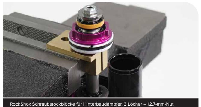
RockShox Schraubstockblöcke für Hinterbaudämpfer, 3 Löcher – 12,7-mm-Nut
