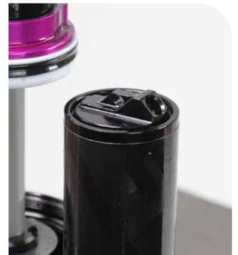
**28** Bauen Sie das Schrader-Ventil wieder in die Kappe des IFP-Ausgleichsbehälters ein.
