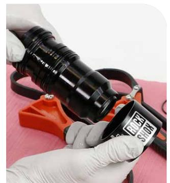
**3** Entfernen und entsorgen Sie die O-Ringe der Hülse.
