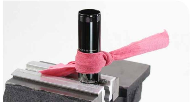
**10** Füllen Sie den Dämpferkörper bis zum oberen Rand mit neuem Maxima PLUSH 7 WT-Federungsöl.
