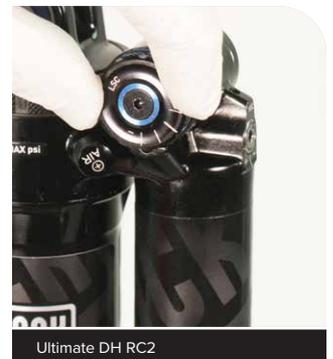
**Ultimate RC2T, Ultimate DH RC2:** Drehen Sie den Highspeed-Druckstufeneinsteller (HSC) bis zum Anschlag gegen den Uhrzeigersinn in die vollständig offene Position und zählen Sie dabei die Rasterungsklicks. [Notieren Sie sich diese Zahl](#) zur Unterstützung bei der Abstimmung nach der Wartung.
