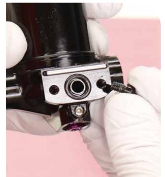
**4** Entfernen Sie den Ausrichtungsstift und den O-Ring des Ausgleichsbehälters.
