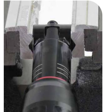
**2** Lösen Sie den Schraubstock, richten Sie das Lagereinpresswerkzeug mittig auf dem Lager aus und ziehen Sie den Schraubstock langsam wieder fest. Vergewissern Sie sich, dass das Lagereinpresswerkzeug mittig und nicht über dem Lagerrand sitzt.
