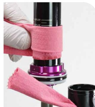
**24** Um die Qualität der Entlüftung zu prüfen, setzen Sie das RockShox IFP Height Tool V2 (Super Deluxe) wieder in den IFP-Ausgleichsbehälter ein und drücken Sie den IFP mit einer Kraft von ca. 111 N nach unten.
