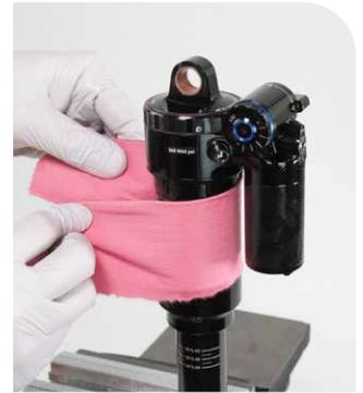
**10** Bringen Sie einen Gummibandschlüssel um den Teil der Luftkammer an, der am weitesten vom Führungsstangenauge entfernt ist (siehe Abbildung).
