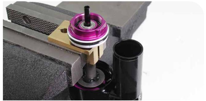
RockShox Schraubstockblöcke für Hinterbaudämpfer, 3 Löcher – 12,7-mm-Nut
