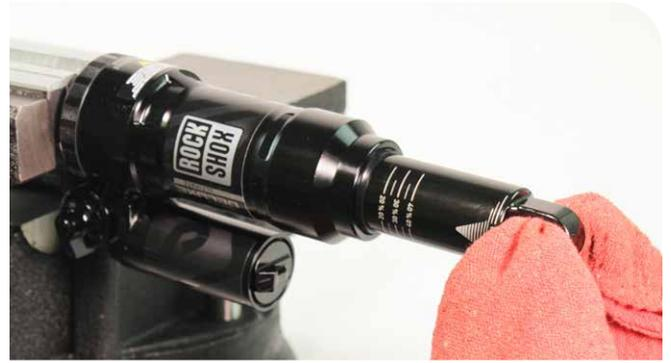
**Lagerauge:** Falls Sie sie zuvor ausgebaut haben, bringen Sie die Lageraugen-Baugruppe am Dämpferkörper an. Wickeln Sie ein Stofftuch um die Lageraugen-Baugruppe, um sie zu schützen.
