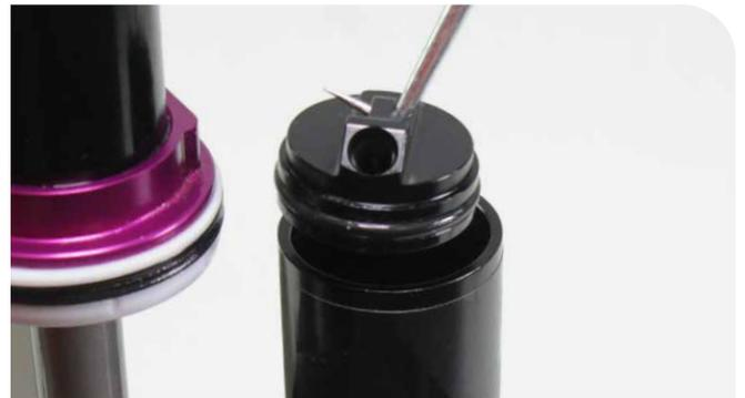
**6** Entfernen Sie den O-Ring der Kappe des IFP-Ausgleichsbehälters und entsorgen Sie ihn.
