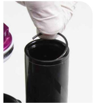
**5** Entfernen Sie die Kappe des IFP-Ausgleichsbehälters vom IFP-Ausgleichsbehälter.
