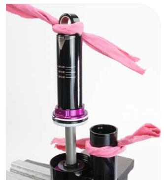
**21 IFP auf die angegebene Tiefe einstellen:** Führen Sie einen 3-mm-Inbusschlüssel durch den Schlitz im RockShox IFP Height Tool V2 (Super Deluxe) an der passenden Tiefe für das entsprechende Dämpfermodell ein.
