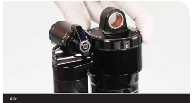
**Select RT (C2), Select+ RT (C1), Ultimate RC2T, Select+ RCT (C2):** Drehen Sie den Auslöseschwellen-Hebel (Pedal) in die geöffnete Position.
