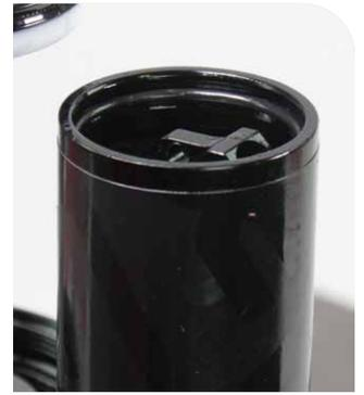
**27** Ziehen Sie die Kappe des IFP-Ausgleichsbehälters nach oben, damit sie am Sicherungsring anliegt.
