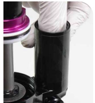
**4** Entfernen Sie den Sicherungsring vom IFP-Ausgleichsbehälter.
