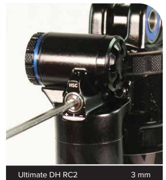
**2** **Notieren** Sie sich die Luftdruckeinstellung zur Unterstützung bei der Abstimmung nach der Wartung.
