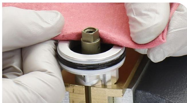
**6** **SIDLuxe IsoStrut y SIDLuxe IsoStrut Flight Attendant:** Introduzca el punzón en el centro del eje del amortiguador e instale el conjunto del pistón en el eje. Centre las piezas en el extremo cuadrado del eje del amortiguador.
