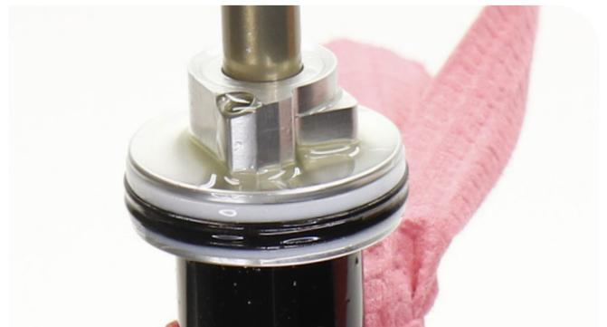
**10** Apriete el cabezal de sellado/pistón neumático al par especificado.
