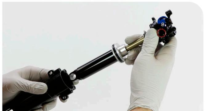
**9** Vuelva a instalar la lata de aire IsoStrut en el pasador de mantenimiento del amortiguador trasero, colocándola horizontalmente.
