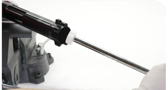
**2** Introduzca el disco de extracción del manguito de sellado de la lata de aire IsoStrut en un alargador de vaso de 5/8" de largo. Introduzca el disco de extracción en la lata de aire IsoStrut a través del extremo del ojal hasta que el borde de la herramienta del disco se detenga contra el manguito de sellado.
