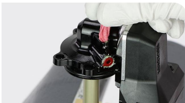
**13** Aplique un poco de grasa al extremo de una llave Allen de 2 mm para sujetar el tornillo de fijación de la retención. Instale el tornillo de fijación de la retención y apriételo hasta que quede al ras con el ojal/ soporte.
