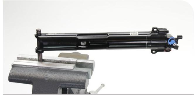
Pasador de mantenimiento del amortiguador trasero de 10 mm      SIDLuxe IsoStrut
