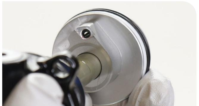
**9** Deslice el cabezal de sellado/pistón neumático hacia arriba y hacia fuera del pistón hasta que se detenga contra el tope.
