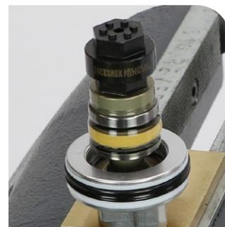
Herramienta de vaso para la copa de la válvula y el perno del pistón SIDLuxe/IsoStrut
