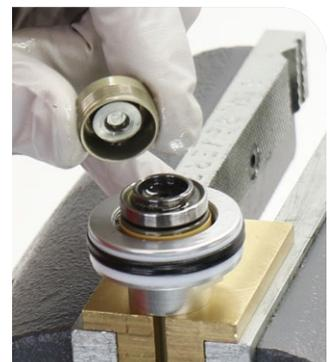
**SIDLuxe IsoStrut Flight Attendant:** Desenrosque y retire la copa de la válvula del pistón.
