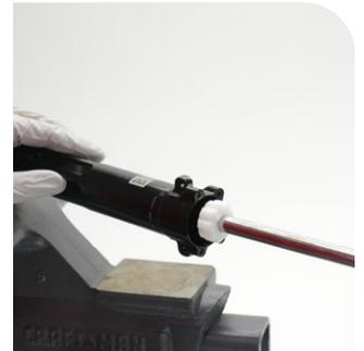
Herramienta de vaso para el manguito de sellado de la lata de aire IsoStrut
