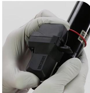
Instalar la batterie SRAM
