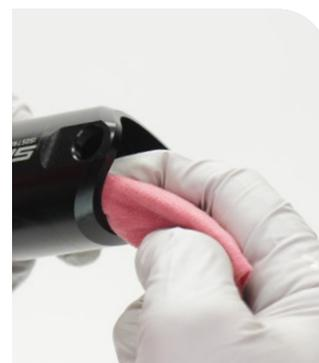
**9** Limpie la lata de aire IsoStrut, incluidas las ranuras del manguito de sellado, por dentro y por fuera.
