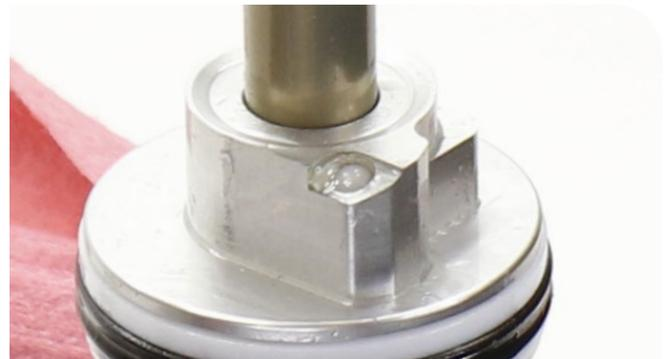
**12** Aplique un poco de grasa al extremo de una llave Allen de 2 mm para sujetar el tornillo de purgado.
