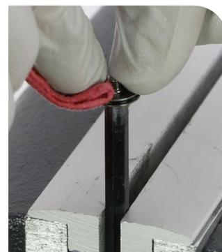
Instale las cuñas de ajuste medio en el perno de ajuste medio, en el orden correcto. Consulte la *Guía de ajuste de cuñas del amortiguador trasero RockShox* para conocer las especificaciones de ajuste medio de SIDLuxe IsoStrut.
