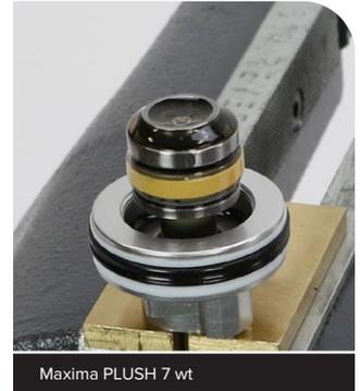
**SIDLuxe IsoStrut Flight Attendant:** Inyecte aceite para suspensiones PLUSH 7 wt en la copa y el deslizador de la válvula antes de instalar el conjunto de pistón/eje del amortiguador en el cuerpo del amortiguador. Inyecte aceite hasta que la copa y el deslizador queden completamente sumergidos en aceite. Esto limitará o reducirá el aire atrapado en las piezas durante el montaje del amortiguador.
