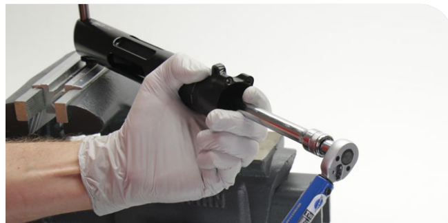
Herramienta de vaso para el manguito de sellado de la lata de aire IsoStrut
