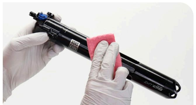
**10** Instale una junta tórica del indicador de hundimiento nueva.
