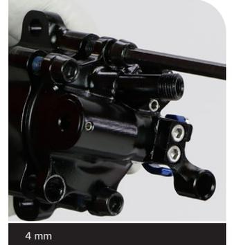
Enrosque los pernos hasta que el ojal quede al ras con la lata de aire IsoStrut.
