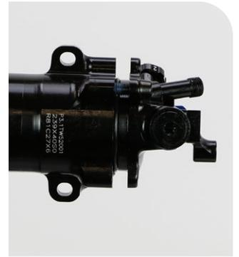
**7** Instale el segundo perno en el orificio situado en diagonal y enrósquelo dos vueltas completas.
