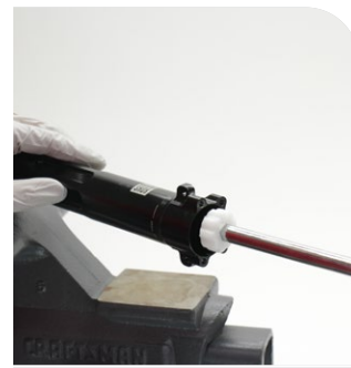
Herramienta de vaso para el manguito de sellado de la lata de aire IsoStrut
