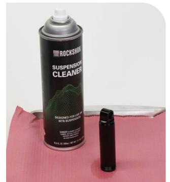
**6** Inspeccione con una luz las superficies interior y exterior del cuerpo del amortiguador, en busca de arañazos, abolladuras u otras deformaciones. Si nota alguna deformación, deberá sustituir el cuerpo del amortiguador.
