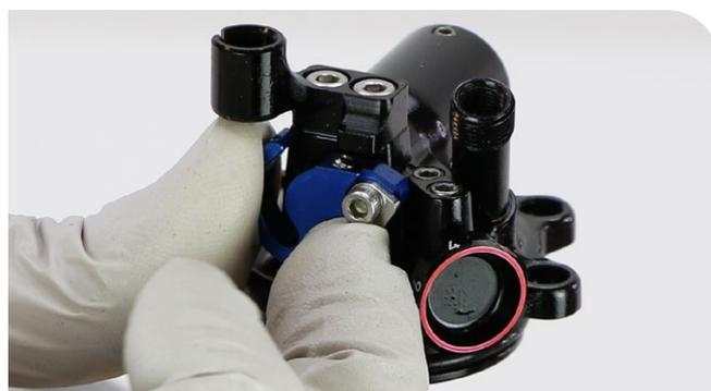
Si se daña, sustituya el tope de la funda del cable de control remoto.
