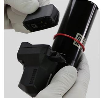
Extracción de la batería SRAM
