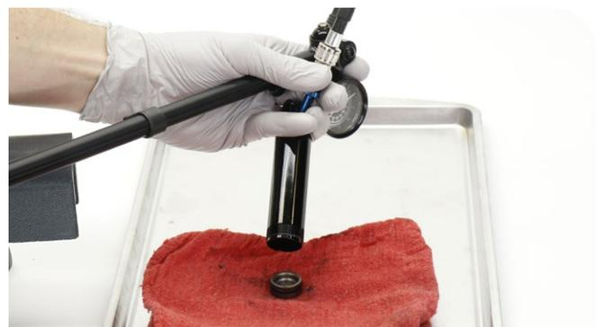
**3** Desenrosque el adaptador para válvulas de aire del cuerpo del amortiguador.
