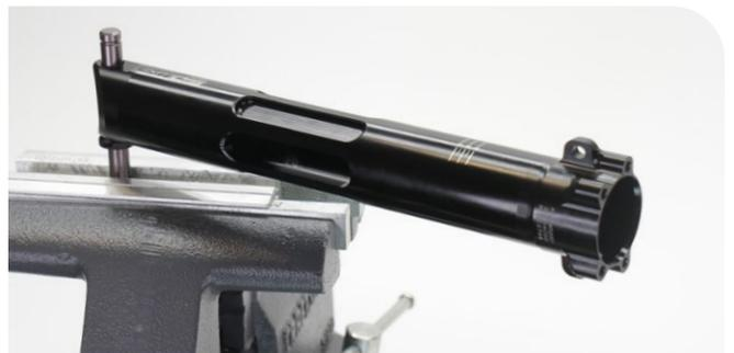
Pasador de mantenimiento del amortiguador trasero de 10 mm
