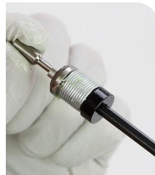
**17** Introduzca la leva de bloqueo del control remoto, el muelle y el precargador en el ojal/soporte. Sujete el casquillo exterior de la leva por el otro lado con el dedo.
