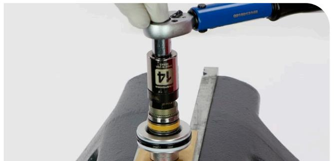
Herramienta de vaso para la copa de la válvula y el perno del pistón SIDLuxe/IsoStrut, vaso de 14 mm
