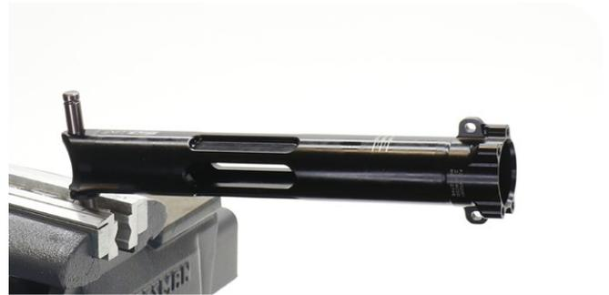
Pasador de mantenimiento del amortiguador trasero RockShox de 10 mm
