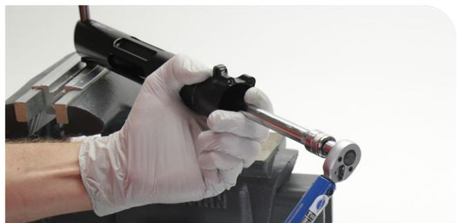
Herramienta de vaso para el manguito de sellado de la lata de aire IsoStrut
