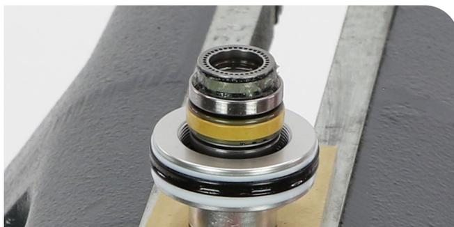
Incorrecto: el amortiguador de compresión está en posición bloqueada. No continuar.
