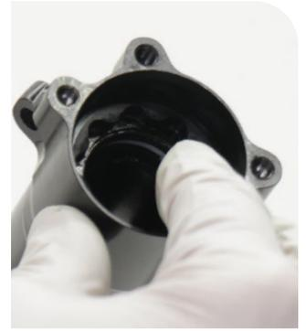
**12** Introduzca la lata de aire IsoStrut en el pasador de mantenimiento del amortiguador trasero.
