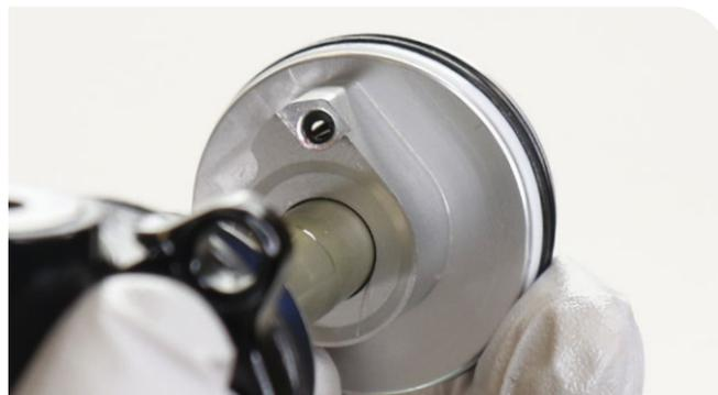
**9** Faites coulisser la tête d'étanchéité/piston à air vers le haut pour l'éloigner du piston jusqu'à ce que cet ensemble se bloque contre la butée.
