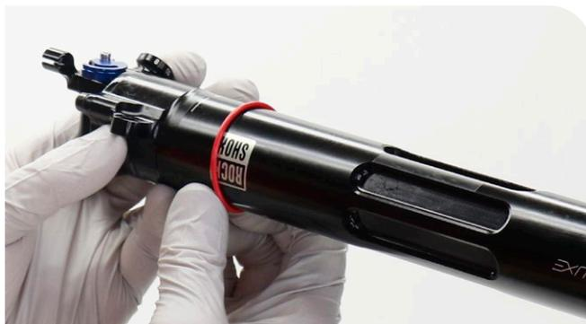
**11** Installez le corps de la valve Schrader et serrez-le à la main.
