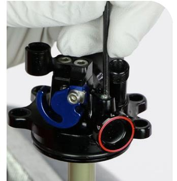
**11** Aplique un poco de grasa al extremo de una llave Allen de 2 mm para sujetar el tornillo de fijación de la retención. Instale la vis de fixation du système cranté et serrez-la jusqu'à ce qu'elle affleure avec l'œillet/fixation.
