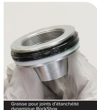
Graisse pour joints d'étanchéité dynamique RockShox
