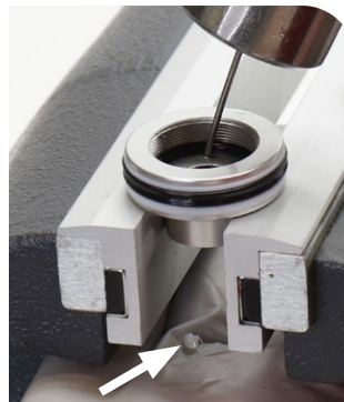
Poinçon pour roulement : 1/16 po/1,5 mm (diam. ext.)
