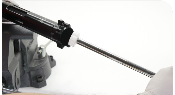
Outil à douille pour manchon d'étanchéité négative de la chambre d'air IsoStrut
