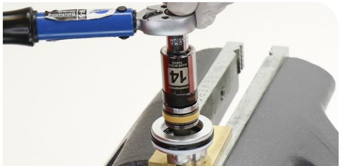
Outil à douille pour vis du piston et coupelle de valve SIDLuxe/IsoStrut : douille de 14 mm
