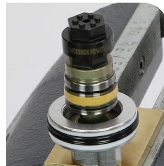
Outil à douille pour vis du piston et coupelle de valve SIDLuxe/IsoStrut
