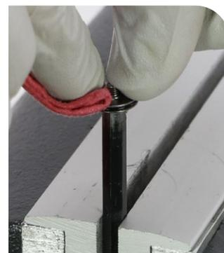
Installez la ou les rondelles du réglage intermédiaire sur la vis du réglage intermédiaire dans l'ordre approprié. Pour prendre connaissance des caractéristiques du réglage intermédiaire SIDLuxe IsoStrut, consultez le *Guide de réglage des rondelles d'amortisseur arrière RockShox*.
