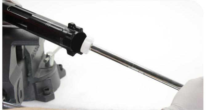
**2** Insérez la rondelle de démontage du manchon d'étanchéité de la chambre d'air IsoStrut sur une longue rallonge pour douille de 5/8 po. Insérez la rondelle de démontage dans la chambre d'air IsoStrut par son extrémité à œillet jusqu'à ce que le bord de la rondelle se bloque contre le manchon d'étanchéité.
