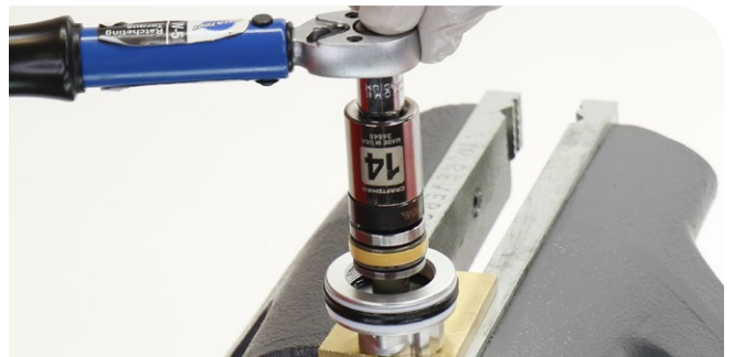
Outil à douille pour vis du piston et coupelle de valve SIDLuxe/IsoStrut : douille de 14 mm
