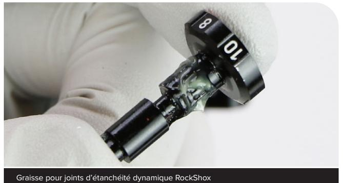
**9** Insérez le réglage de la détente à l'intérieur de l'œillet/fixation en alignant vers le haut la butée de la vis de limite avec l'orifice de la vis de limite situé dans l'œillet/fixation. La vis de limite se bloque contre cette surface lorsque le réglage de la détente est tourné en position d'ouverture maximale.
