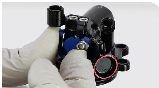
Si la butée de gaine du câble de la commande à distance est endommagée, elle doit être remplacée.
