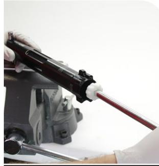
Outil à douille pour manchon d'étanchéité négative de la chambre d'air IsoStrut
