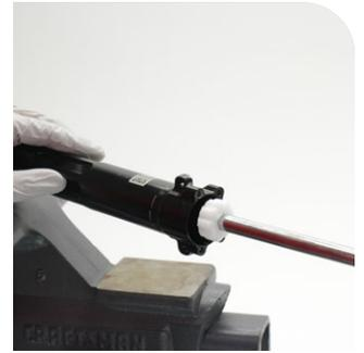
Outil à douille pour manchon d'étanchéité de la chambre d'air IsoStrut
