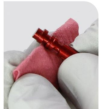
**10** Appliquez de la graisse sur les joints toriques neufs puis installez-les.
