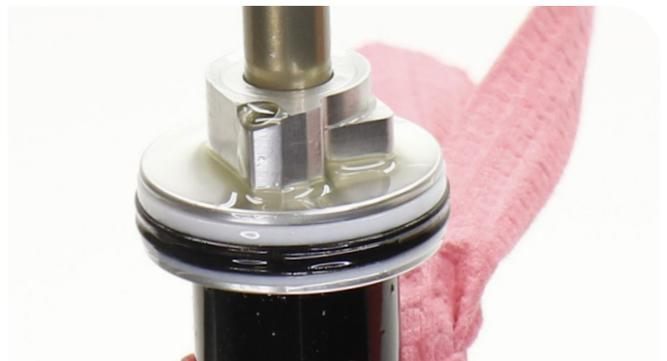
**10** Serrez la tête d'étanchéité/piston à air au couple recommandé.
