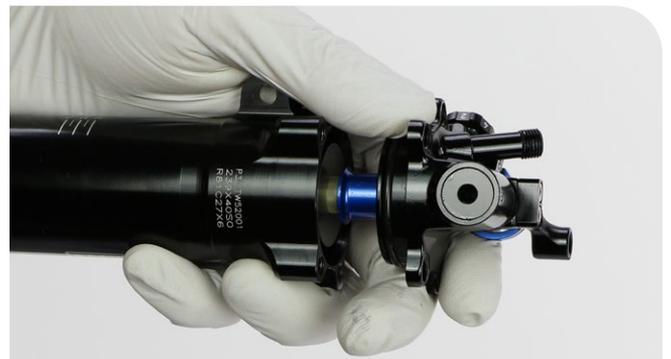
**8** Retirez l'amortisseur inséré dans la goupille d'entretien pour amortisseur arrière.
