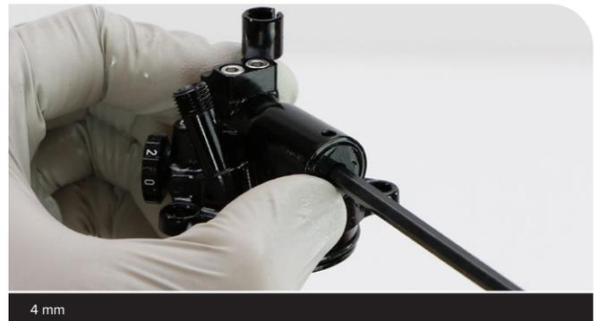
**5** Retirez le réglage de la précontrainte à ressort de la commande à distance.
