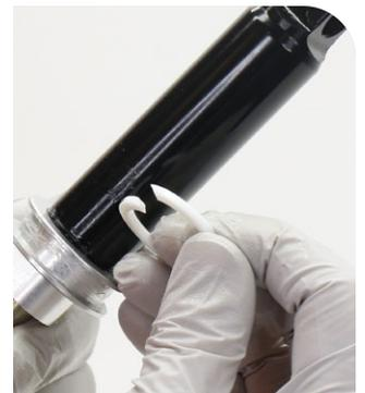
**2** Retirez le joint torique externe de l'œillet/chambre d'air IsoStrut, puis jetez-le.
