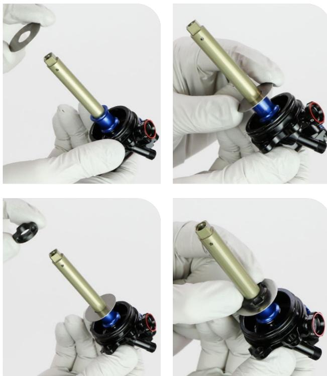
**3** Nettoyez la tige de la cartouche d'amortissement et serrez-la dans les cales d'étau pour amortisseur arrière RockShox (10 mm).
