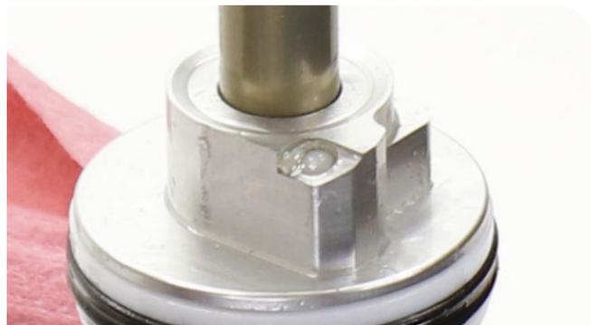
**12** Appliquez une noisette de graisse sur l'extrémité d'une clé hexagonale de 2 mm pour retenir la vis de purge.
