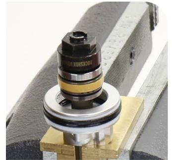
Outil à douille pour vis du piston et coupelle de valve SIDLuxe/IsoStrut
