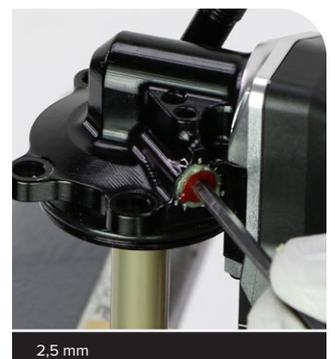
**12** Appliquez une noisette de graisse sur l'extrémité d'une petite clé hexagonale pour retenir la bille du système cranté. Installez le roulement à bille du système cranté.
