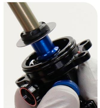
**5** Installez une nouvelle bague d'appui épaisse (au plus près de l'œillet/ fixation).
