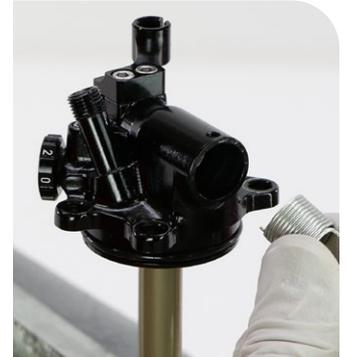
**7** Retirez la vis de limite de la tige/bobine de la commande à distance.
