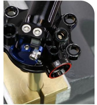
**10** Appliquez une noisette de graisse sur l'extrémité d'une petite clé hexagonale pour retenir la bille du crantage. Installez le roulement à bille du crantage.
