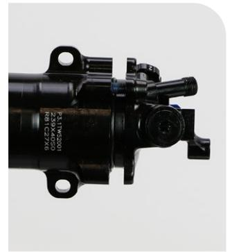
**7** Installez la deuxième vis dans l'orifice situé en diagonal, puis vissez-la de deux tours complets.
