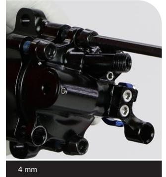
Vissez chaque vis jusqu'à ce que l'œillet affleure avec la chambre d'air IsoStrut.
