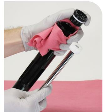
**3** Retirez le joint torique et la bague situés sur l'extérieur, puis jetez-les.
