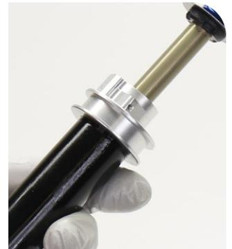
**4** Appliquez de la graisse sur un nouveau joint torique de l'œillet/chambre d'air IsoStrut, puis installez-le.
