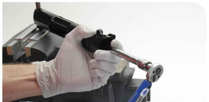
Outil à douille pour manchon d'étanchéité de la chambre d'air IsoStrut
