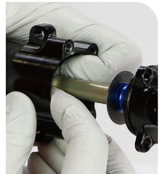
**5** Injectez 0,5 ml (cinq petites gouttes) de lubrifiant fluide pour suspension Maxima PLUSH Dynamic à l'intérieur de la chambre d'air IsoStrut (chambre du ressort à air positive).
