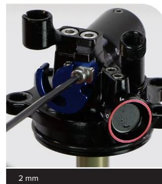
**21** **Vérification du fonctionnement** : tournez la bobine de la commande à distance dans le sens des aiguilles d'une montre pour tester le ressort de la commande à distance.
