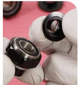
**2** Confirme que el anillo de presión esté asentado en la ranura del adaptador.
