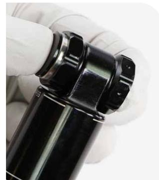
Un adaptador de rodamiento (23 mm) nuevo incluye un rodamiento en el adaptador sin hoyuelo que no está completamente asentado y que se debe presionar y asentar en el adaptador antes de instalar el amortiguador en una bicicleta.
