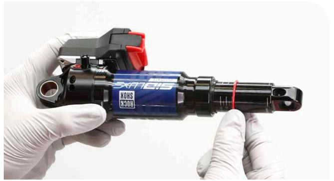
**8** Instale el obús de la válvula Schrader.
