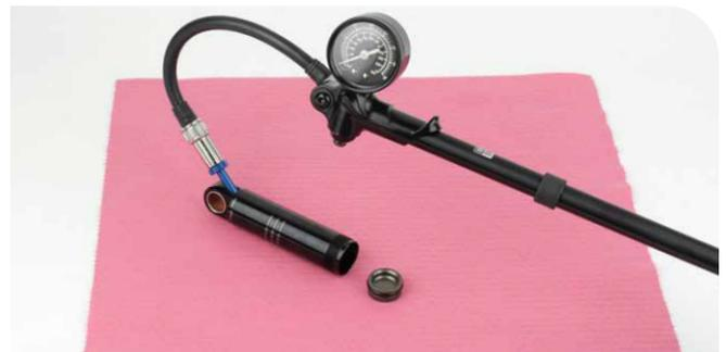
Herramienta adaptadora de válvula de aire RockShox SIDLuxe y bomba para amortiguadores
