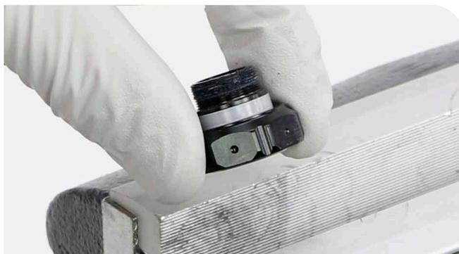
**4** Retire las cubiertas de los rodamientos de los adaptadores de rodamiento.
