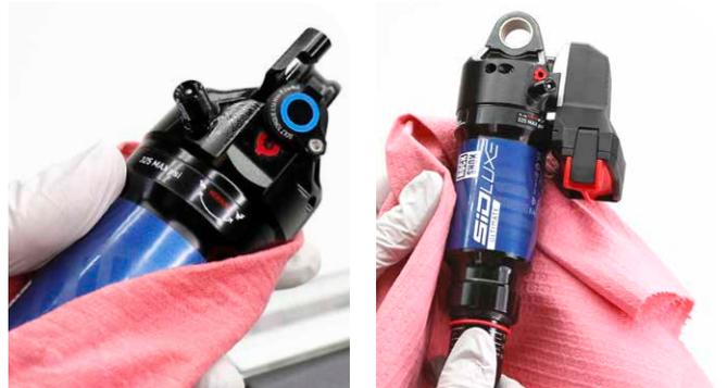
**7** Instale la junta tórica del indicador de hundimiento.
