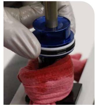
**4** Apriete el cabezal de sellado/pistón neumático.
