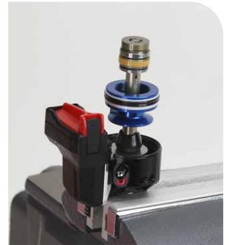
**2** Mueva hacia abajo el conjunto de cabezal de sellado/pistón neumático. Utilice la herramienta para pistón y el vaso de 14 mm para retirar la copa de la válvula. Deje la copa de la válvula a un lado.
