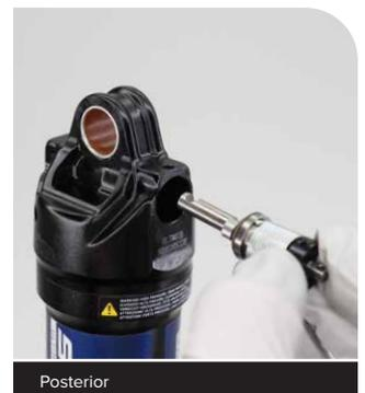
**7** Limpie el ojal. Verifique que el obturador de compresión no sea visible a través de la abertura del ojal.
