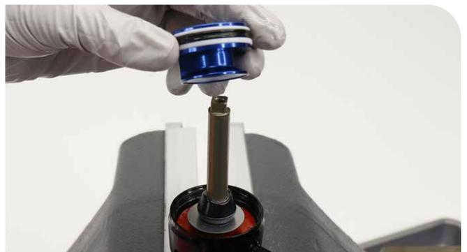
**6** Retire el tope y la arandela inferiores del eje del amortiguador.
