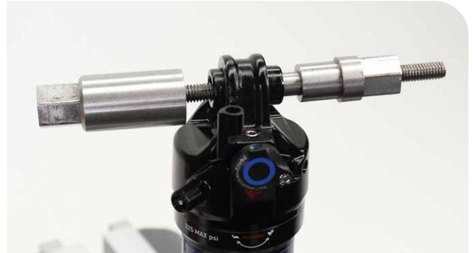
**5** Coloque un espaciador final a cada lado del pasador del casquillo y empuje para insertarlo, con el lado de mayor diámetro primero.
