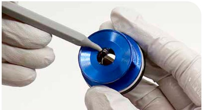
**11** Extraiga la junta tórica interior situada en la base de las roscas del cabezal de sellado/pistón neumático.
