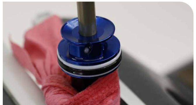
**6** Enrosque el tornillo de purgado en el orificio correspondiente hasta que note que entra en contacto con la bola de compresión; a continuación, apriete el tornillo de purgado otra media vuelta.
