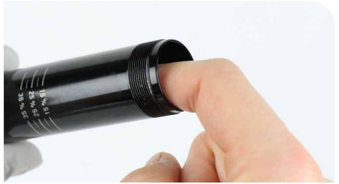
**4** Retire y reemplace la junta tórica del IFP.
