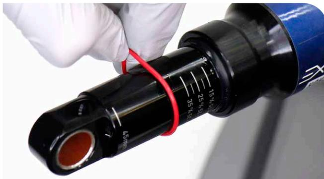
9 Introduzca una toalla de taller a través del ojal del cuerpo del amortiguador para evitar que la lata de aire salga disparada del amortiguador.
