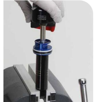
**5** Retire el tornillo de purgado situado en el cabezal de sellado/pistón neumático.
