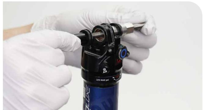
**4** Si no puede sacar fácilmente el pasador del casquillo, vuelva a insertar la varilla roscada y el pasador de empuje a través del ojal.
