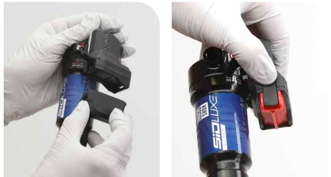
**3 Ultimate Flight Attendant (FA) con alargador:** Ponga el amortiguador trasero en posición abierta antes de extraer la batería. En el caso de un amortiguador trasero FA que **no** esté emparejado a una horquilla FA (o si se ha retirado la batería de la horquilla), presione dos veces el botón AXS del módulo del amortiguador trasero para pasar el amortiguador a la posición abierta. Está en posición abierta cuando el módulo no emite ningún sonido al presionar dos veces.
