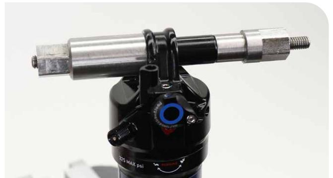
**4** Coloque el receptor en un tornillo de banco o sujételo con una llave de 13 mm.
