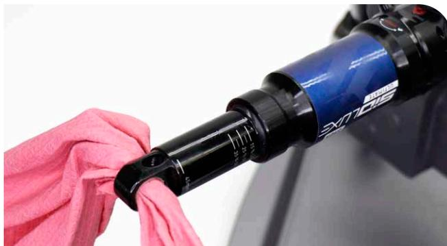
10 Utilice una llave de correa para desmontar la lata de aire. Coloque la cinta en torno a la sección de la lata de aire más alejada del ojal del eje. Gire la llave en sentido antihorario para desenroscar la lata de aire.
