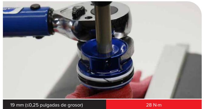
**5** Deje que salgan burbujas de aire por el orificio de purgado del cabezal de sellado.
