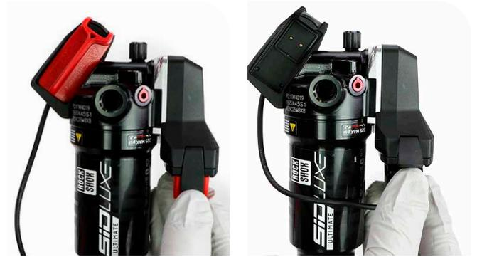
Instale la batería del alargador en el módulo de control.
