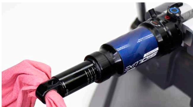
10 À l'aide d'une clé à sangle, retirez la chambre d'air. Serrez la sangle autour de la partie de la chambre d'air située à l'opposé de l'œillet de la tige. Tournez la clé dans le sens inverse des aiguilles d'une montre pour dévisser la chambre d'air.
