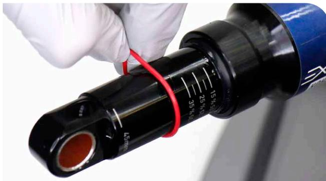
9 Enfilez un chiffon à travers l'œillet du corps de la cartouche d'amortissement pour éviter que la chambre d'air ne soit violemment éjectée de l'amortisseur.
