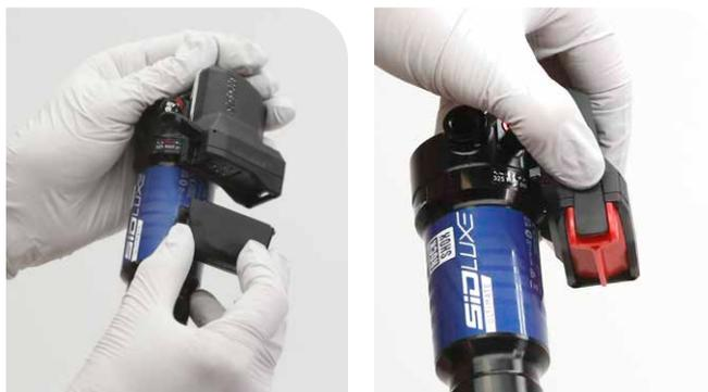
**3** **Cordon prolongateur Ultimate Flight Attendant (FA) :** réglez l'amortisseur arrière sur le mode Open avant de retirer la batterie. Si l'amortisseur arrière FA est **non** couplé à la fourche FA (ou si la batterie est retirée de la fourche), appuyez deux fois sur le bouton AXS du module de l'amortisseur arrière afin de régler l'amortisseur arrière sur le mode Open. Quand le mode Open est activé, le module n'émet aucun son lorsqu'on appuie deux fois sur le bouton.
