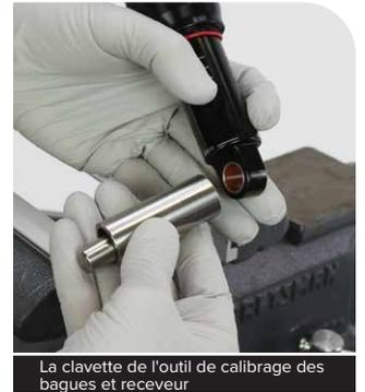
La clavette de l'outil de calibrage des bagues et receveur
