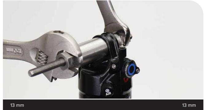
**3** Dévissez le receveur situé sur la tige filetée. Retirez l'outil hors de l'œillet puis jetez la bague.
