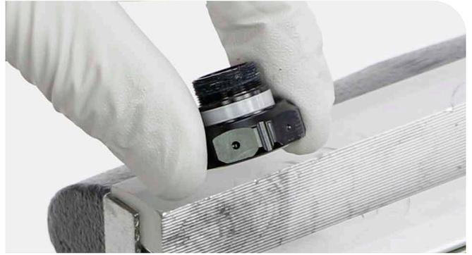
**4** Retirez les protections des roulements situées sur les adaptateurs à roulement.
