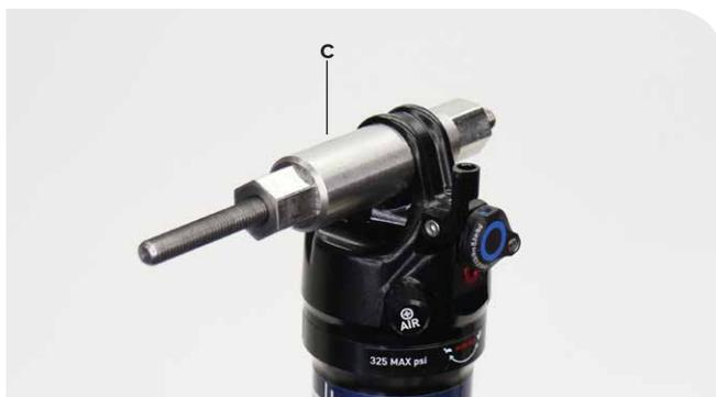
**2** Serrez le receveur dans un étau ou bloquez-le fermement à l'aide d'une clé de 13 mm.
