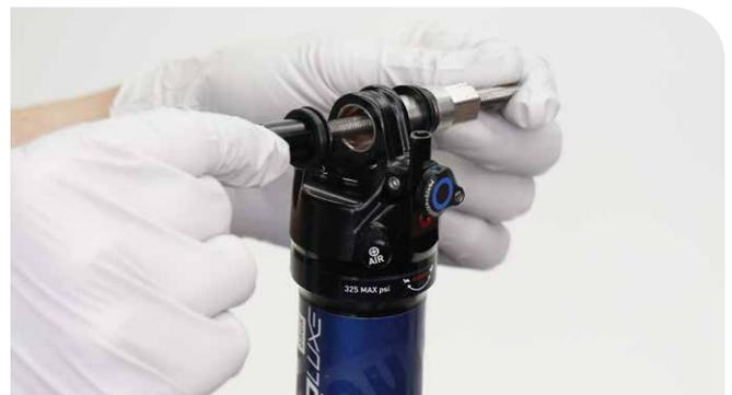
**4** Si la clavette de la bague ne se retire pas facilement, réinsérez la tige filetée et la clavette de pression à travers l'œillet.
