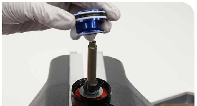
**6** Retirez la butée de talonnage et la rondelle de talonnage situées sur la tige de la cartouche d'amortissement.
