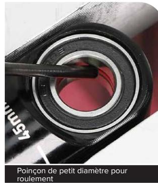
Poinçon de petit diamètre pour roulement
