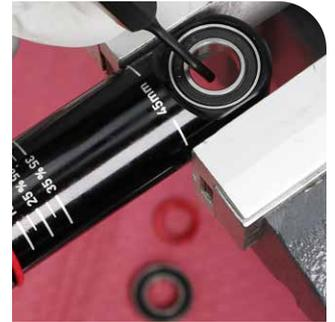
Poinçon de petit diamètre pour roulement
