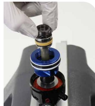
**17** Pour changer la rondelle de réglage intermédiaire ou passer d'un système d'amortissement à deux positions à un système à trois positions, consultez le chapitre [Modification de la coupelle de valve du réglage intermédiaire](#). Installez la coupelle de valve en fonction de votre réglage.
