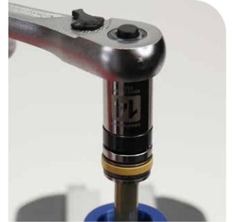
Outil pour piston avec douille de 14 mm
