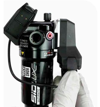
Installez la batterie à cordon prolongateur dans le Module de commande.
