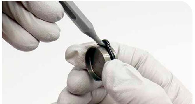
**5** Installez le PFI dans le corps de la cartouche d'amortissement avec son côté à épaulement visible. À l'aide de l'outil SIDLUxe pour la mesure de la hauteur du PFI, poussez le PFI à la profondeur indiquée dans le tableau ci-dessous.
