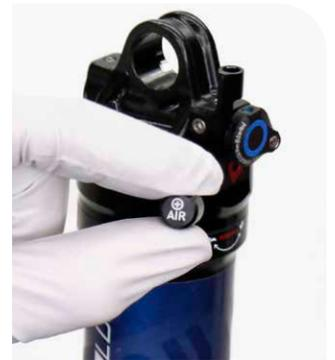
**10** **Ultimate Flight Attendant (FA)** : retirez la cale de la batterie. Installez la batterie SRAM.
