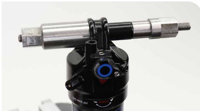
**4** Serrez le receveur dans un étau ou bloquez-le fermement à l'aide d'une clé de 13 mm.
