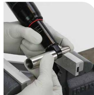
La clavette de l'outil de calibrage des bagues et receveur
